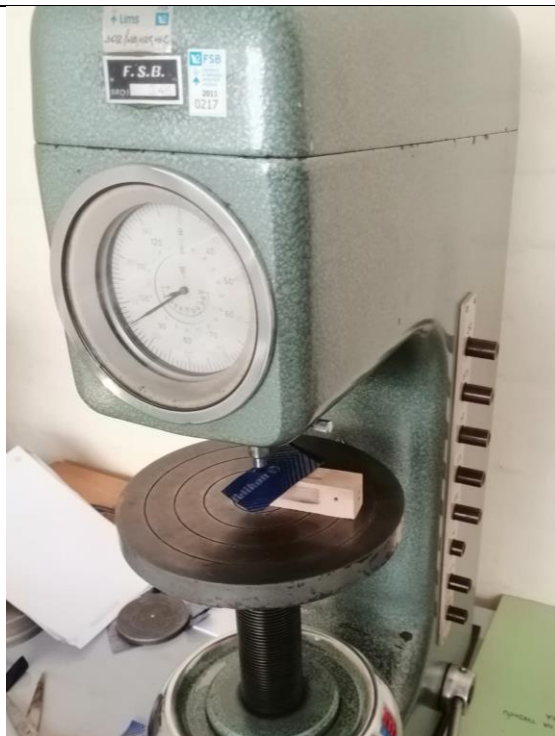
Slika 28 Proces mjerenja tvrdoće na tvrdomjeru
