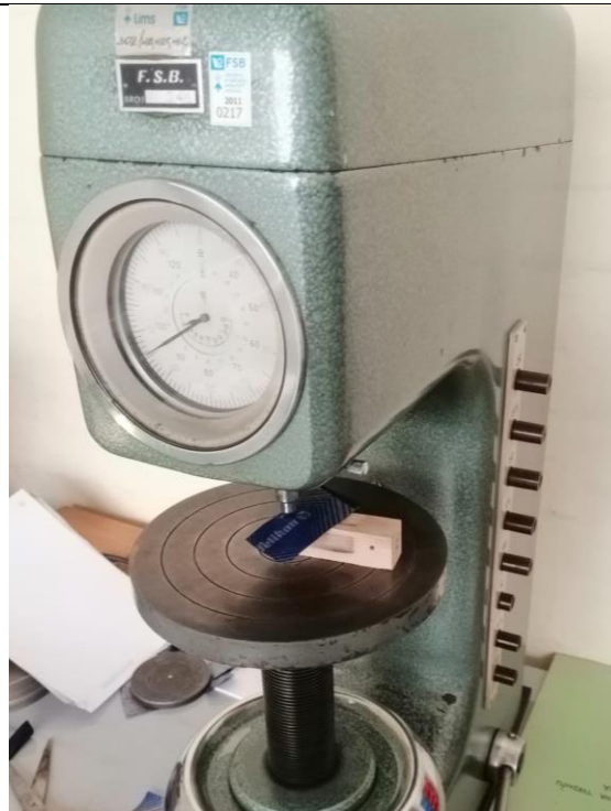
Slika 28 Proces mjerenja tvrdoće na tvrdomjeru
