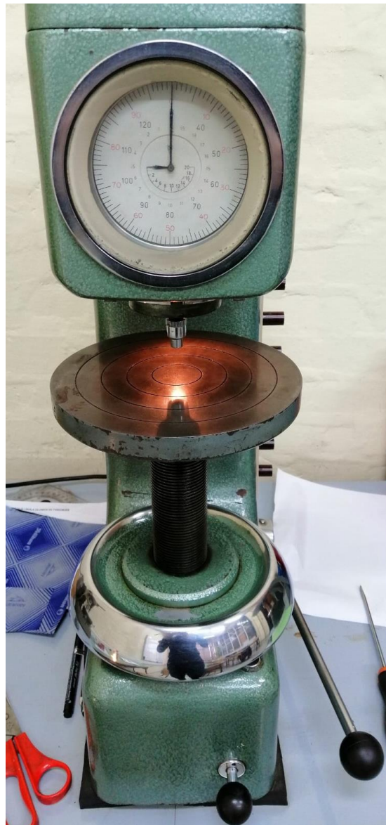
Slika 27 Tvrdomjer na kojem je ispitivana tvrdoća metodom po Brinellu
