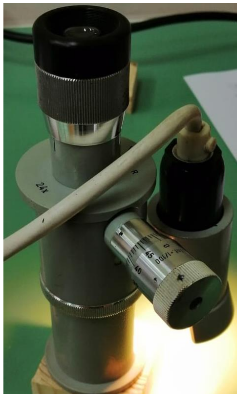
Slika 29 Uređaj na kojem se precizno mjeri promjer koji ostavi kuglica
