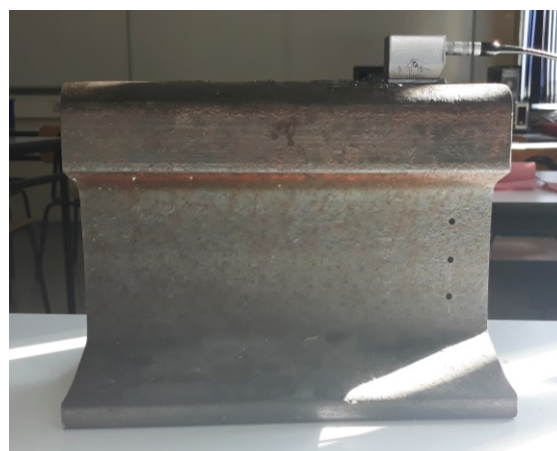
Slika 25. Detektiranje reflektora FBH 3 sondom MWB 45-2
