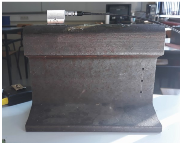
Slika 23. Detektiranje reflektora FBH 1 sondom MWB 45-2
