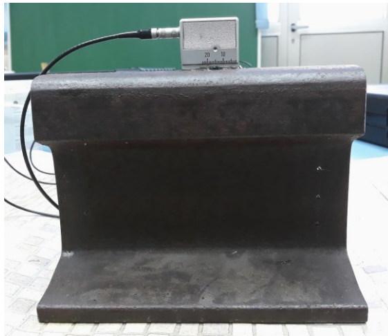
Slika 50. Detektiranje reflektora SDH 1 sondom SWB 45-2
