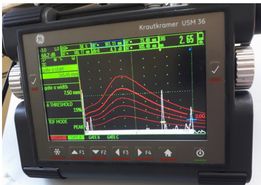
Slika 76. Ekran uređaja pri detektiranju SDH 3 sondom WB 45-2
