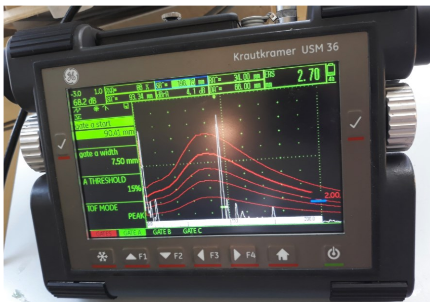
Slika 74. Ekran uređaja pri detektiranju SDH 1 sondom WB 45-2
