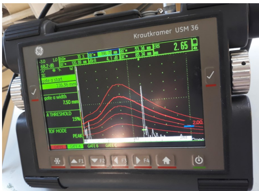
Slika 75. Ekran uređaja pri detektiranju SDH 2 sondom WB 45-2
