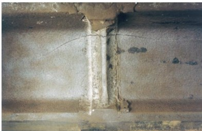
Slika 9. Primjer pukotine označene kodom 422 [13]
