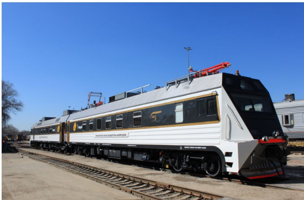
Slika 14. Vozilo za ispitivanje tračnica proizvođača Tvema [25]
