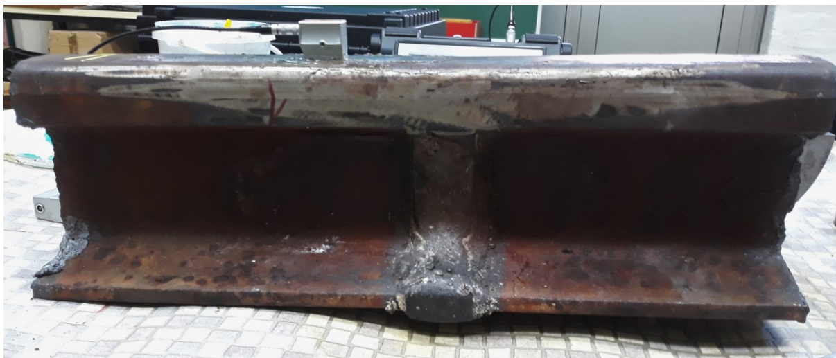
Slika 84. Položaj u kojem sonda MWB 45-2 detektira pogrešku u vratu tračnice
