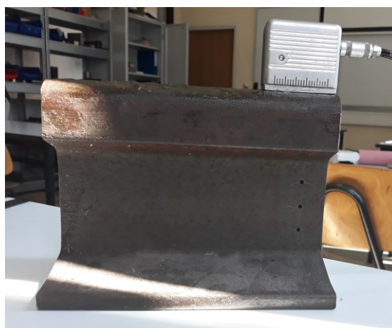
Slika 61. Detektiranje reflektora FBH 3 sondom WB 45-2
