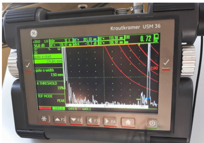
Slika 49. Ekran uređaja pri detektiranju FBH 3 sondom SWB 45-2
