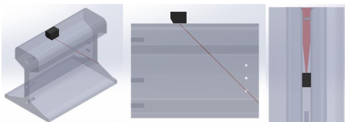
**Slika 37.** Geometrija ultrazvučnog snopa prilikom detektiranja SDH<sub>3</sub> sondom MWB 45-2
