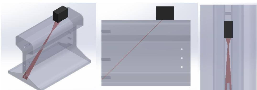
**Slika 46.** Geometrija ultrazvučnog snopa prilikom detektiranja  $\text{FBH}_3$  sondom SWB 45-2
