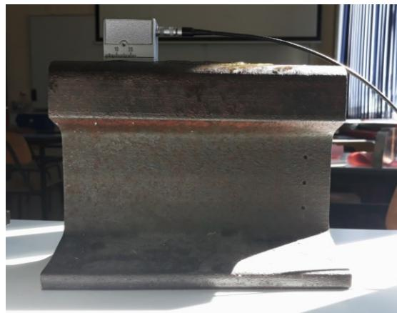
Slika 41. Detektiranje reflektora  $\text{FBH}_1$  sondom SWB 45-2
