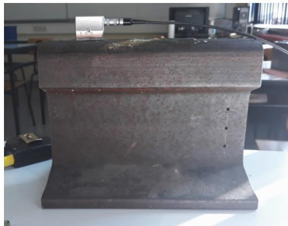
Slika 23. Detektiranje reflektora  $\text{FBH}_1$  sondom MWB 45-2
