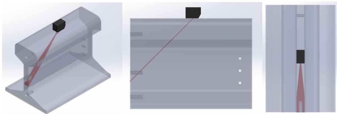
**Slika 27.** Geometrija ultrazvučnog snopa prilikom detektiranja  $FBH_2$  sondom MWB 45-2
