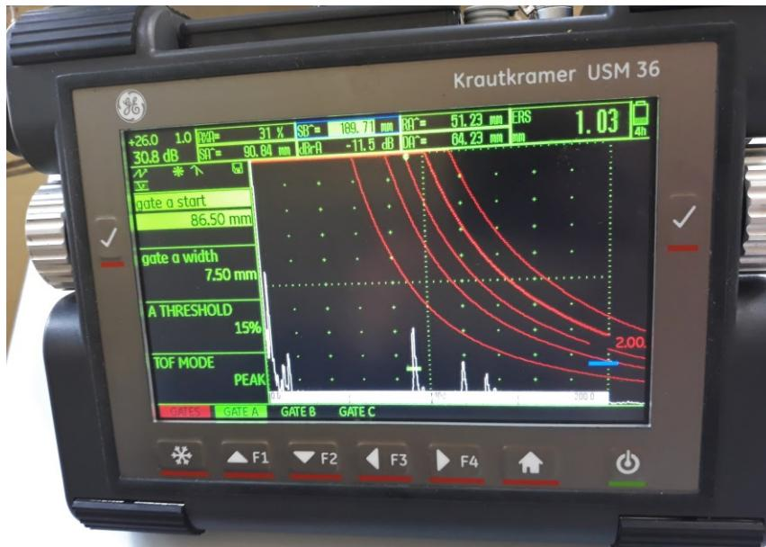
**Slika 38.** Ekran uređaja pri detektiranju SDH<sub>1</sub> sondom MWB 45-2
