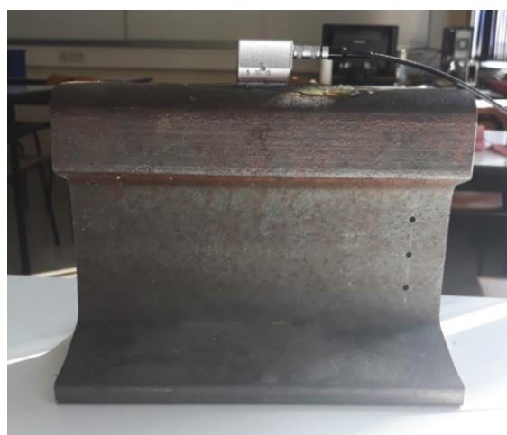
Slika 24. Detektiranje reflektora  $\text{FBH}_2$  sondom MWB 45-2
