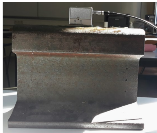
Slika 42. Detektiranje reflektora FBH 2 sondom SWB 45-2
