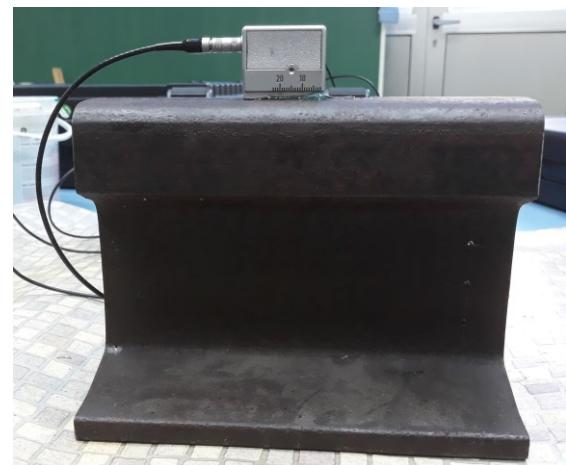
Slika 51. Detektiranje reflektora  $SDH_2$  sondom SWB 45-2
