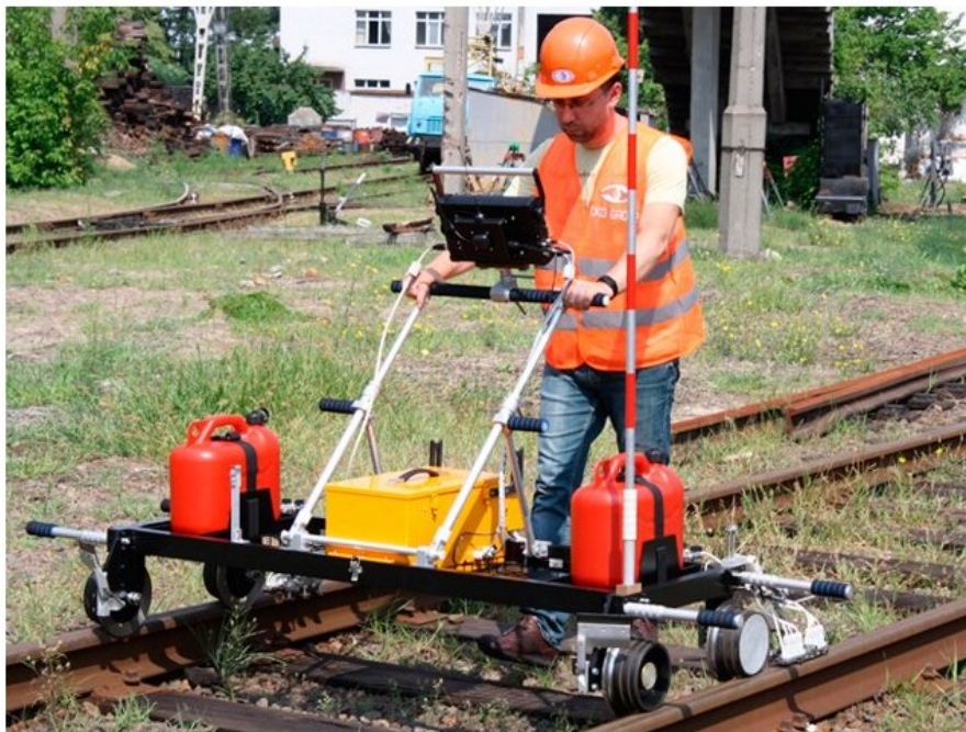
Slika 12. UDS2-73 proizvođača OKOndt GROUP [23]
