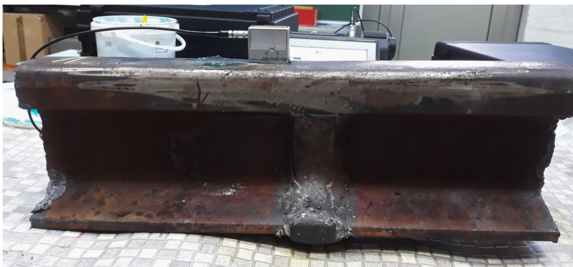
Slika 79. Položaj u kojem sonda SWB 45-2 detektira pogrešku u glavi tračnice
