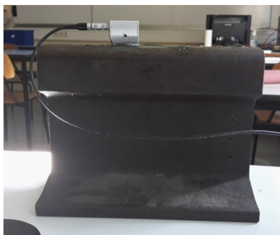
Slika 34. Detektiranje reflektora SDH 3 sondom MWB 45-2
