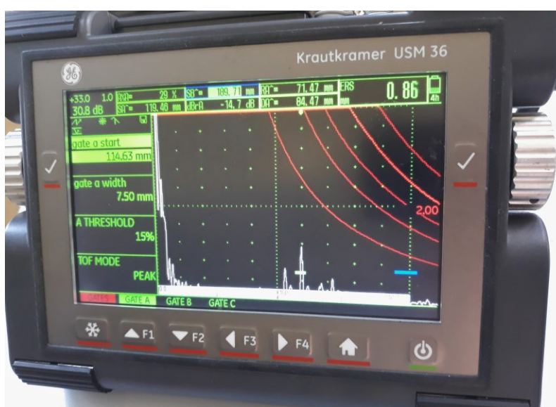
Slika 39. Ekran uređaja pri detektiranju SDH 2 sondom MWB 45-2
