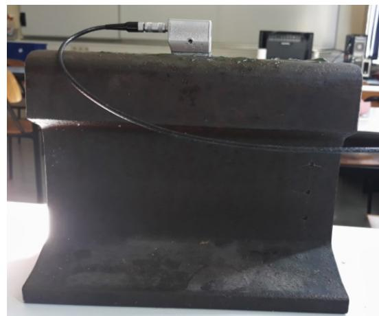
Slika 33. Detektiranje reflektora  $SDH_2$  sondom MWB 45-2
