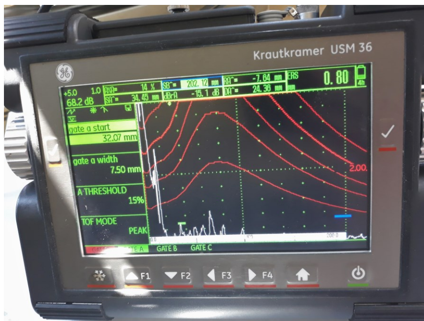
Slika 65. Ekran uređaja pri detektiranju FBH 1 sondom WB 45-2
