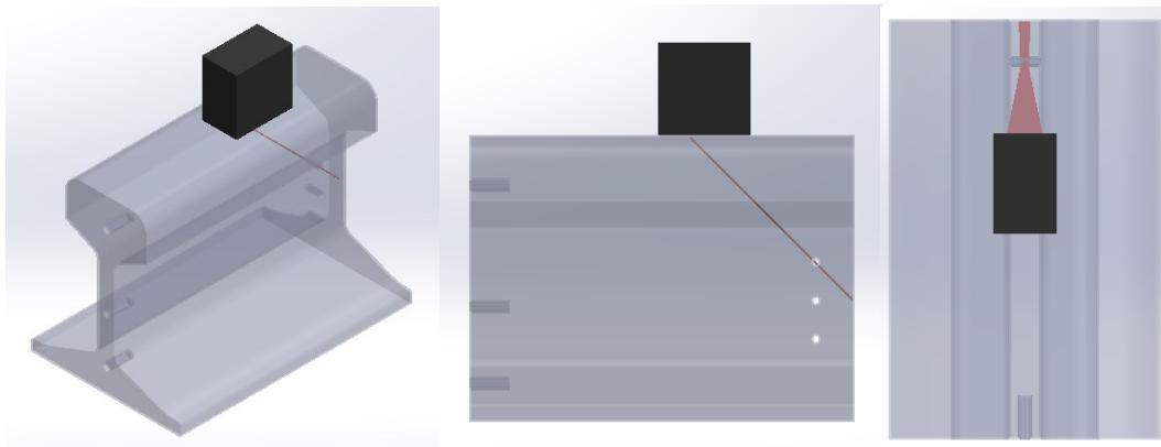
**Slika 71.** Geometrija ultrazvučnog snopa prilikom detektiranja SDH<sub>1</sub> sondom WB 45-2
