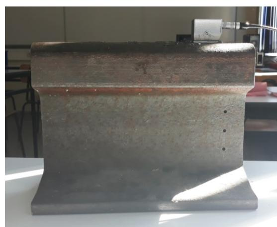
Slika 25. Detektiranje reflektora  $\text{FBH}_3$  sondom MWB 45-2
