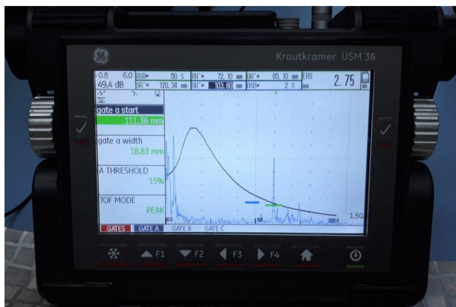
**Slika 57.** Ekran uređaja pri detektiranju SDH<sub>2</sub> sondom SWB 45-2
