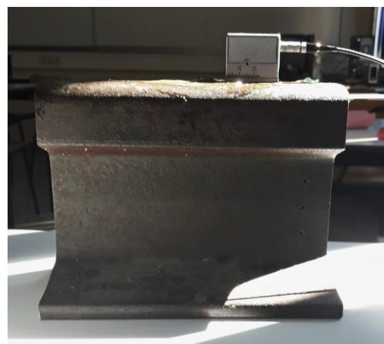
Slika 43. Detektiranje reflektora  $\text{FBH}_3$  sondom SWB 45-2
