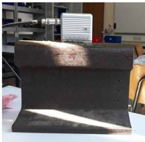
Slika 69. Detektiranje reflektora  $SDH_2$  sondom WB 45-2
