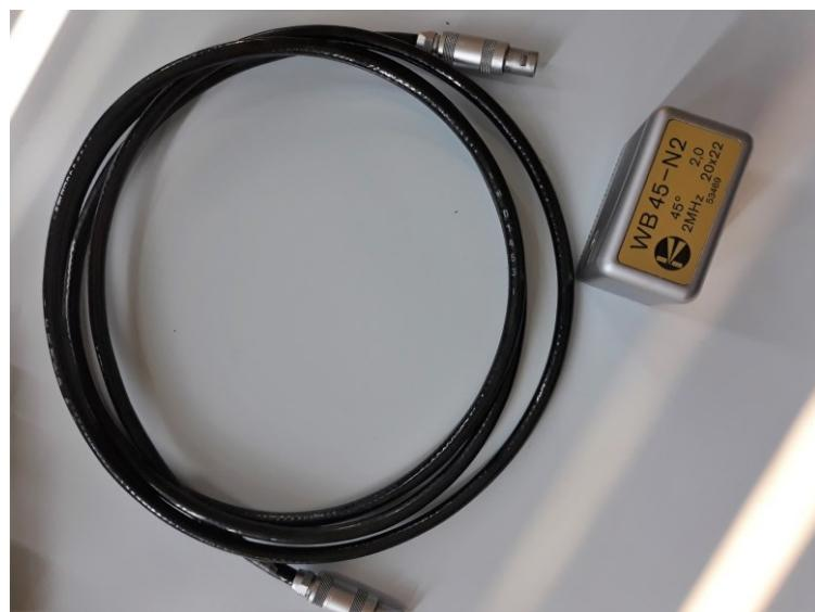
**Slika 21.** Kabel za spajanje sonde WB 45-2 s uređajem
