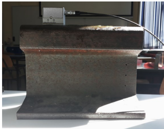
Slika 41. Detektiranje reflektora FBH 1 sondom SWB 45-2
