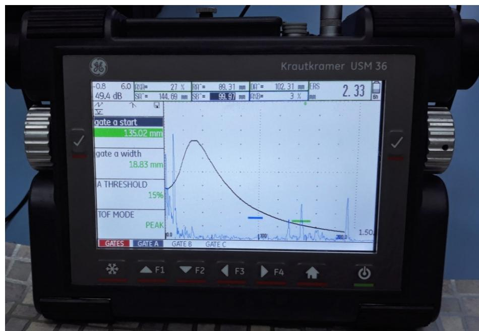
Slika 58. Ekran uređaja pri detektiranju SDH<sub>3</sub> sondom SWB 45-2
