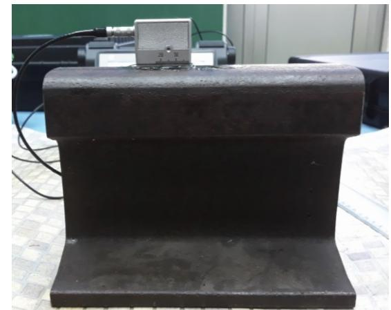
Slika 52. Detektiranje reflektora  $SDH_3$  sondom SWB 45-2
