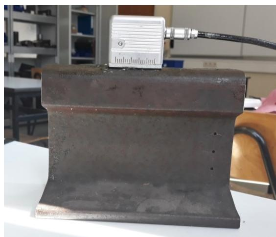
Slika 60. Detektiranje reflektora  $\text{FBH}_2$  sondom WB 45-2
