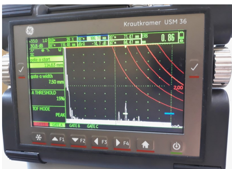
Slika 39. Ekran uređaja pri detektiranju SDH 2 sondom MWB 45-2
