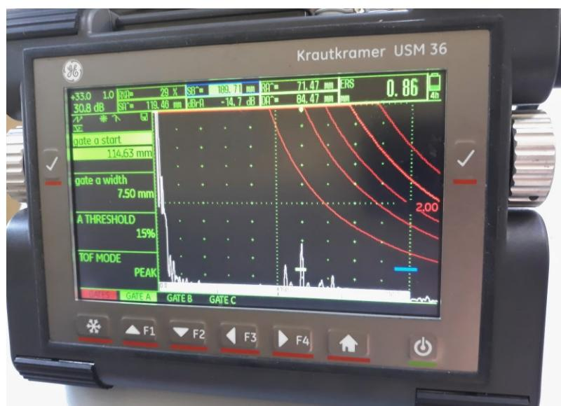
**Slika 39.** Ekran uređaja pri detektiranju SDH<sub>2</sub> sondom MWB 45-2
