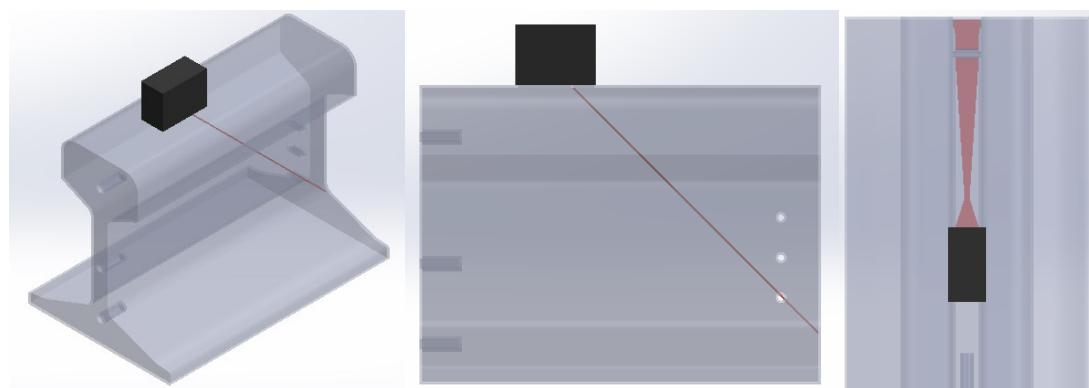
**Slika 55.** Geometrija ultrazvučnog snopa prilikom detektiranja SDH<sub>3</sub> sondom SWB 45-2
