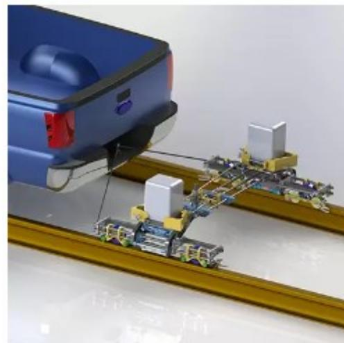
**Slika 13.** Motorizirana verzija uređaja za ispitivanje proizvođača Pandrol [24]
