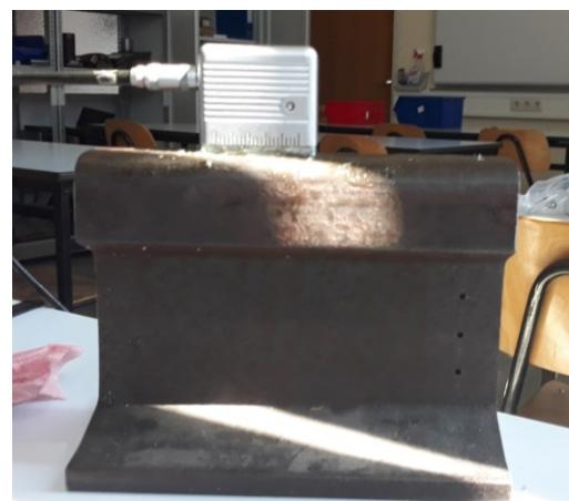
Slika 70. Detektiranje reflektora  $SDH_3$  sondom WB 45-2
