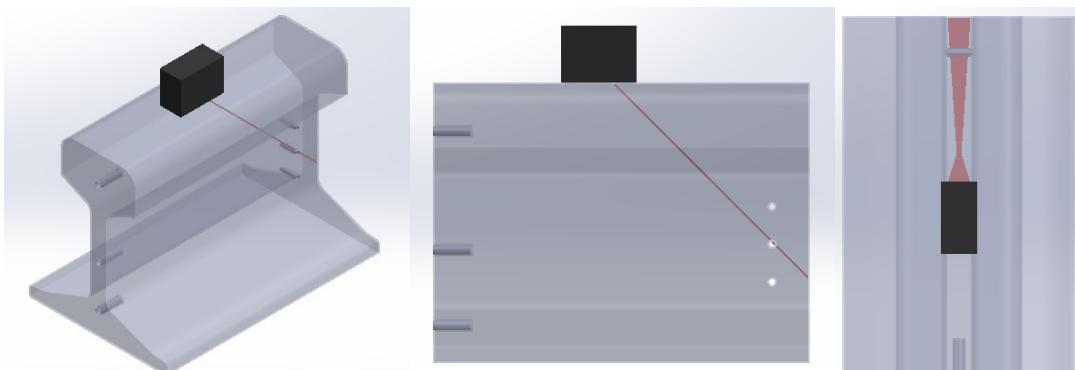
**Slika 54.** Geometrija ultrazvučnog snopa prilikom detektiranja SDH<sub>2</sub> sondom SWB 45-2
