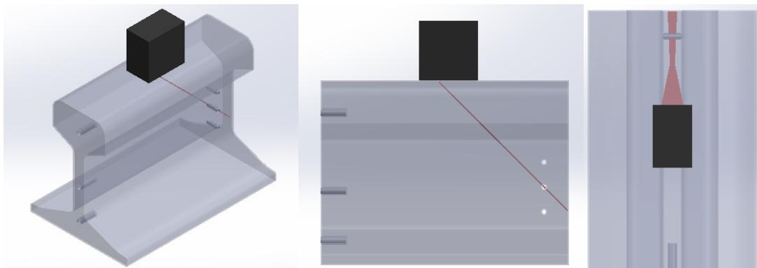
**Slika 72.** Geometrija ultrazvučnog snopa prilikom detektiranja SDH<sub>2</sub> sondom WB 45-2
