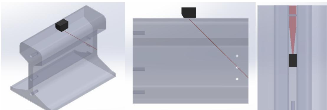
**Slika 36.** Geometrija ultrazvučnog snopa prilikom detektiranja SDH<sub>2</sub> sondom MWB 45-2
