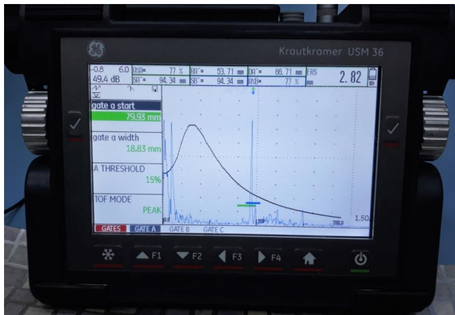
**Slika 56.** Ekran uređaja pri detektiranju SDH<sub>1</sub> sondom SWB 45-2
