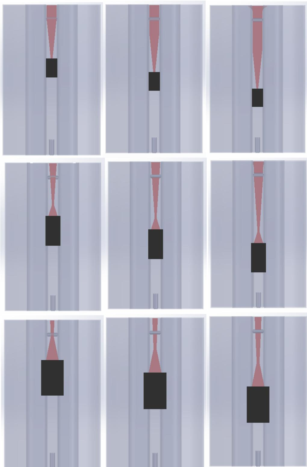
Slika 77. Prikaz tlocrta ultrazvučnih snopova s lijeva na desno SDH1, SDH2, SDH3, korištenjem sondi odozgora prema dolje MWB 45-2, SWB 45-2, WB 45-2
