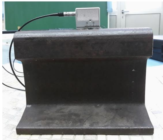
Slika 50. Detektiranje reflektora  $SDH_1$  sondom SWB 45-2
