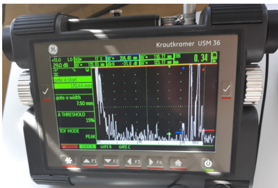
Slika 31. Ekran uređaja pri detektiranju FBH 3 sondom MWB 45-2
