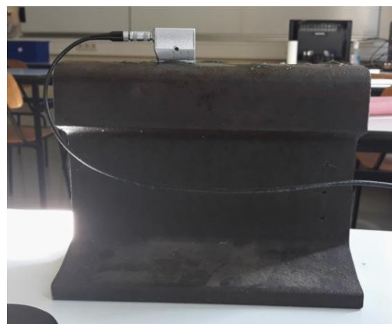
Slika 34. Detektiranje reflektora  $SDH_3$  sondom MWB 45-2
