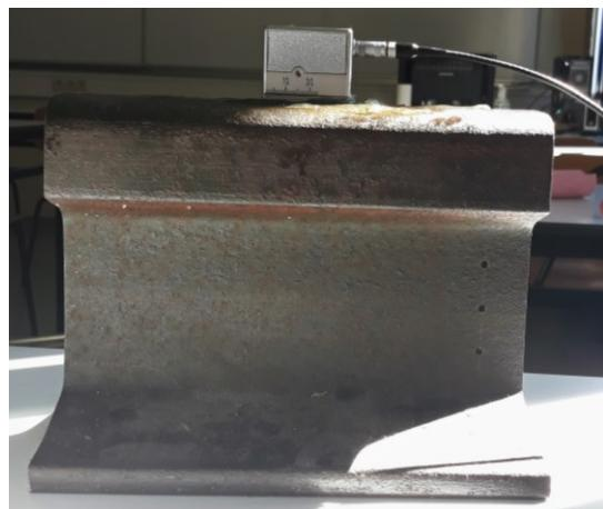
Slika 42. Detektiranje reflektora  $\text{FBH}_2$  sondom SWB 45-2
