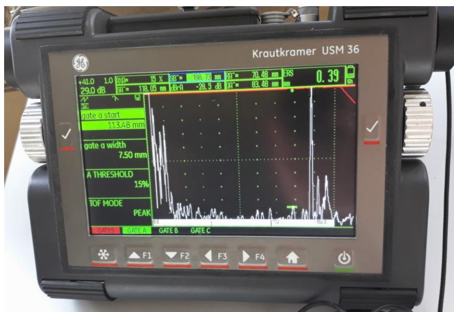
Slika 30. Ekran uređaja pri detektiranju  $\text{FBH}_2$  sondom MWB 45-2
