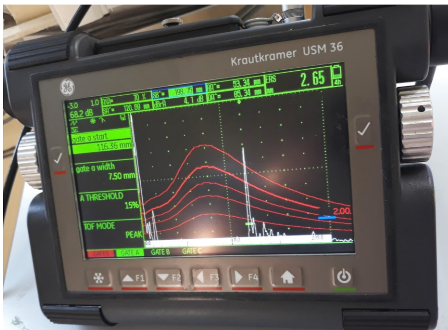
Slika 75. Ekran uređaja pri detektiranju SDH 2 sondom WB 45-2
