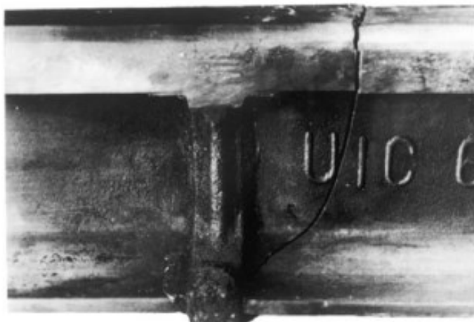
Slika 8. Primjer greške označene kodom 421 [13]
