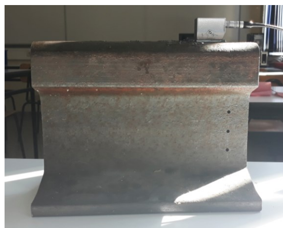
Slika 25. Detektiranje reflektora FBH 3 sondom MWB 45-2
