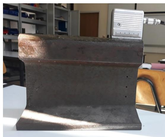
Slika 61. Detektiranje reflektora  $\text{FBH}_3$  sondom WB 45-2
