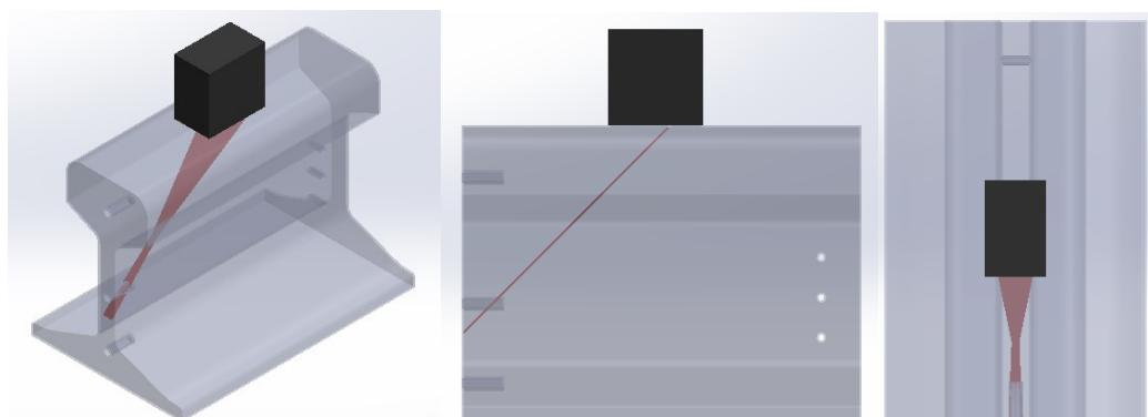
**Slika 63.** Geometrija ultrazvučnog snopa prilikom detektiranja FBH<sub>2</sub> sondom WB 45-2
