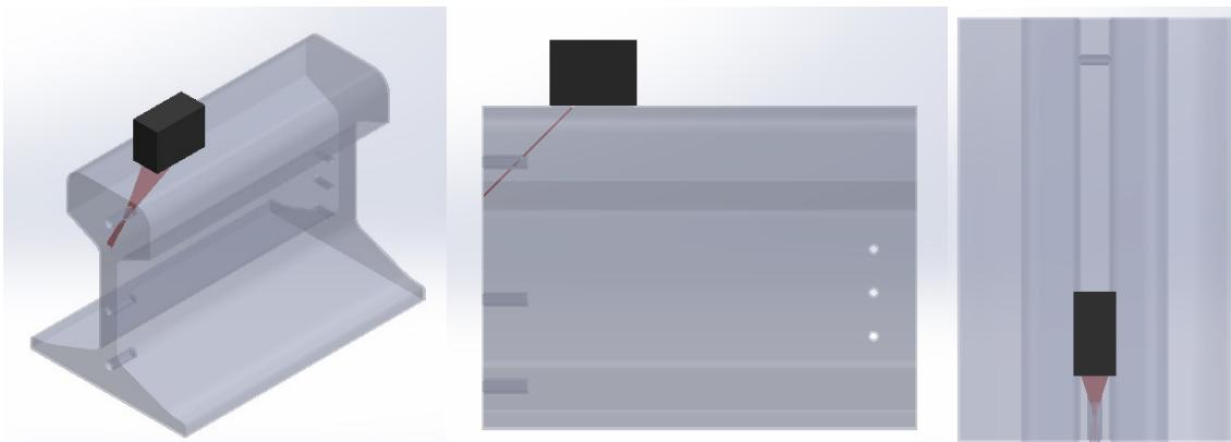
**Slika 44.** Geometrija ultrazvučnog snopa prilikom detektiranja  $\text{FBH}_1$  sondom SWB 45-2
