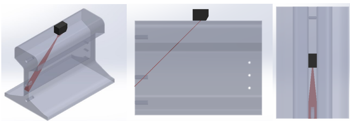
Slika 27. Geometrija ultrazvučnog snopa prilikom detektiranja FBH 2 sondom MWB 45-2
