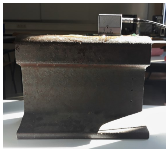
Slika 43. Detektiranje reflektora FBH 3 sondom SWB 45-2
