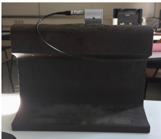
Slika 32. Detektiranje reflektora SDH 1 sondom MWB 45-2
