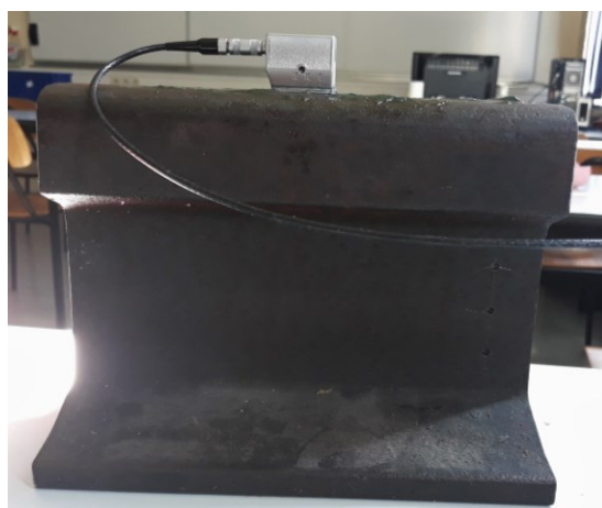
Slika 33. Detektiranje reflektora SDH 2 sondom MWB 45-2
