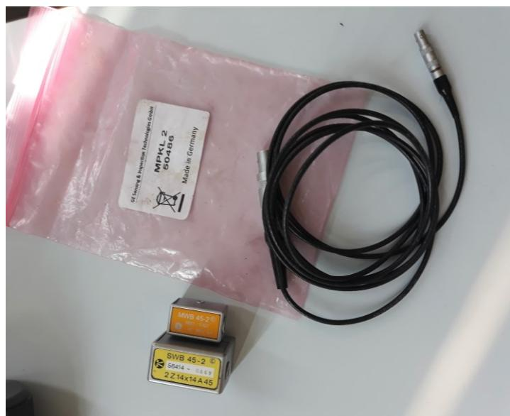
Slika 20. Kabel MPKL 2 za spajanje sondi MWB 45-2 i SWB 45-2 s uređajem
