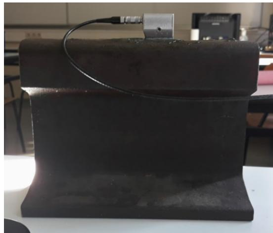
Slika 32. Detektiranje reflektora  $SDH_1$  sondom MWB 45-2
