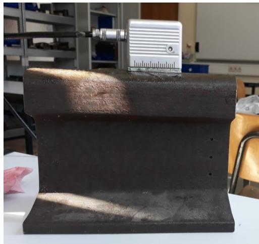
Slika 68. Detektiranje reflektora  $SDH_1$  sondom WB 45-2
