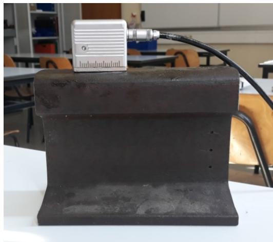
Slika 59. Detektiranje reflektora  $\text{FBH}_1$  sondom WB 45-2
