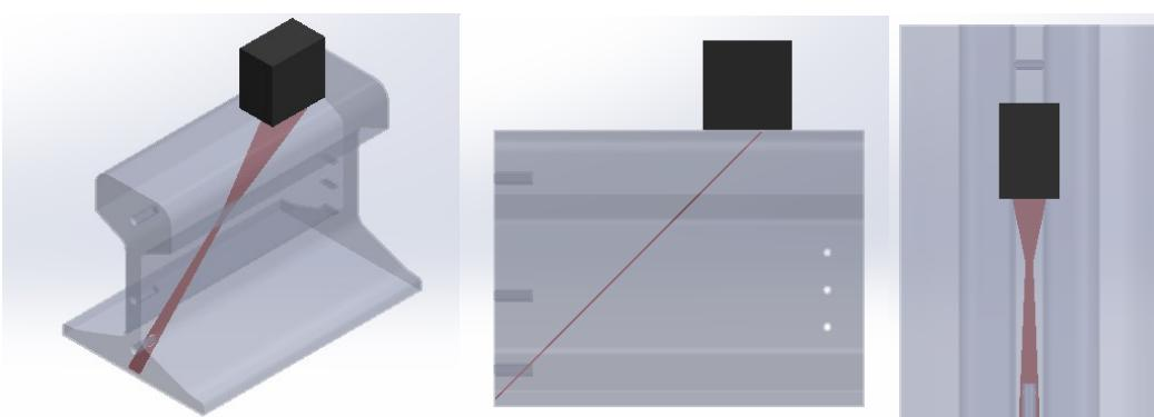
**Slika 64.** Geometrija ultrazvučnog snopa prilikom detektiranja FBH<sub>3</sub> sondom WB 45-2
