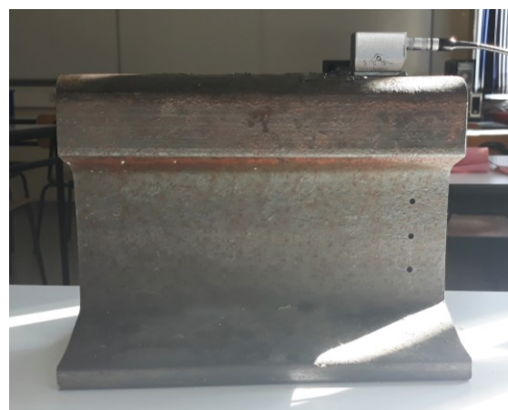
Slika 25. Detektiranje reflektora FBH 3 sondom MWB 45-2
