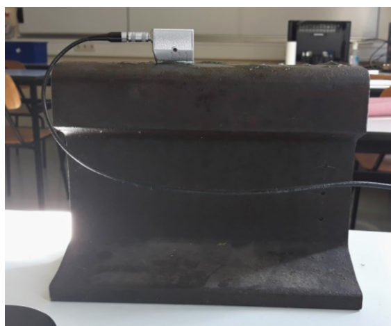
Slika 34. Detektiranje reflektora SDH 3 sondom MWB 45-2
