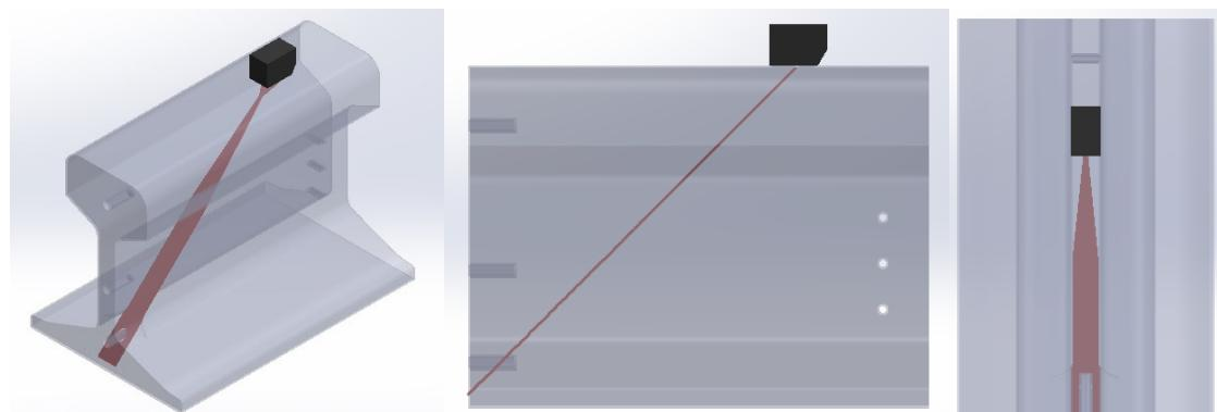
**Slika 28.** Geometrija ultrazvučnog snopa prilikom detektiranja  $FBH_3$  sondom MWB 45-2
