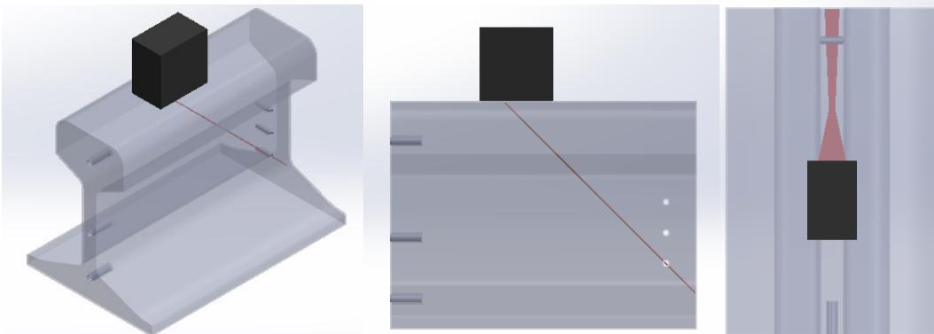
**Slika 73.** Geometrija ultrazvučnog snopa prilikom detektiranja SDH<sub>3</sub> sondom WB 45-2
