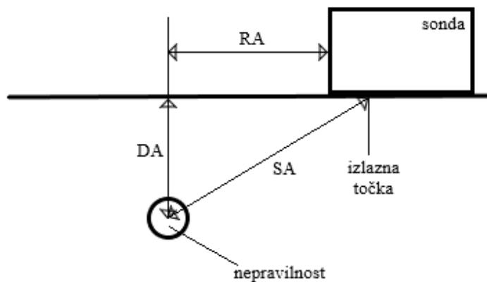
**Slika 22.** Skraćena projekcija, dubina i zvučni put
