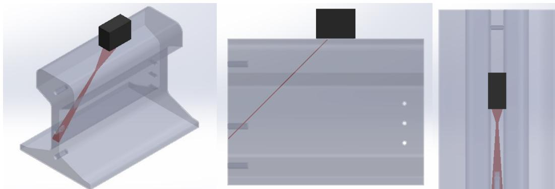
**Slika 45.** Geometrija ultrazvučnog snopa prilikom detektiranja  $\text{FBH}_2$  sondom SWB 45-2
