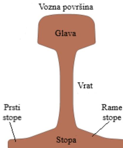
Slika 10. Dijelovi tračnice [20]
