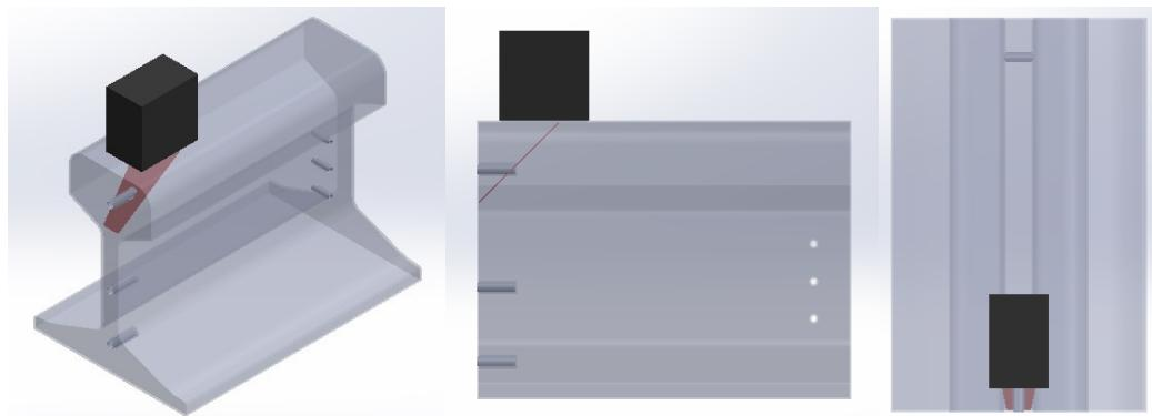
**Slika 62.** Geometrija ultrazvučnog snopa prilikom detektiranja FBH<sub>1</sub> sondom WB 45-2
