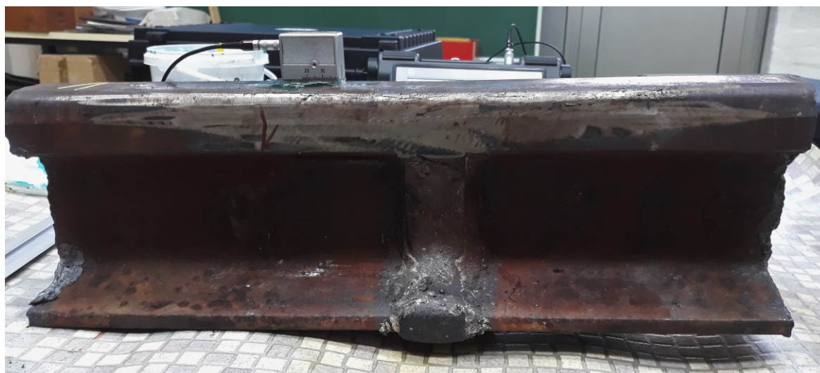
Slika 85. Položaj u kojem sonda SWB 45-2 detektira pogrešku u vratu tračnice
