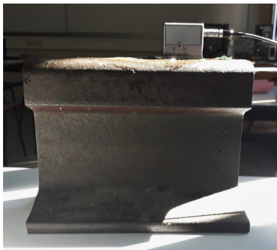
Slika 43. Detektiranje reflektora FBH 3 sondom SWB 45-2
