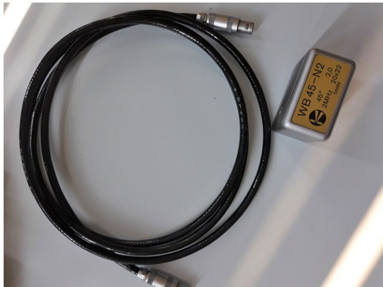
Slika 21. Kabel za spajanje sonde WB 45-2 s uređajem
