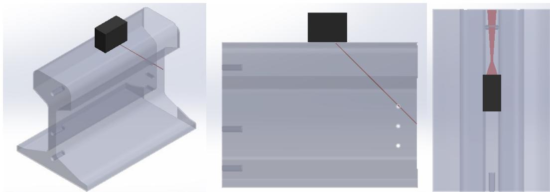
**Slika 53.** Geometrija ultrazvučnog snopa prilikom detektiranja SDH<sub>1</sub> sondom SWB 45-2
