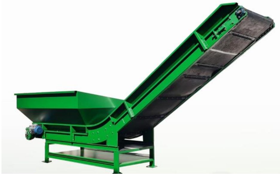
Slika 26. Kutni lančani transporter [30]
