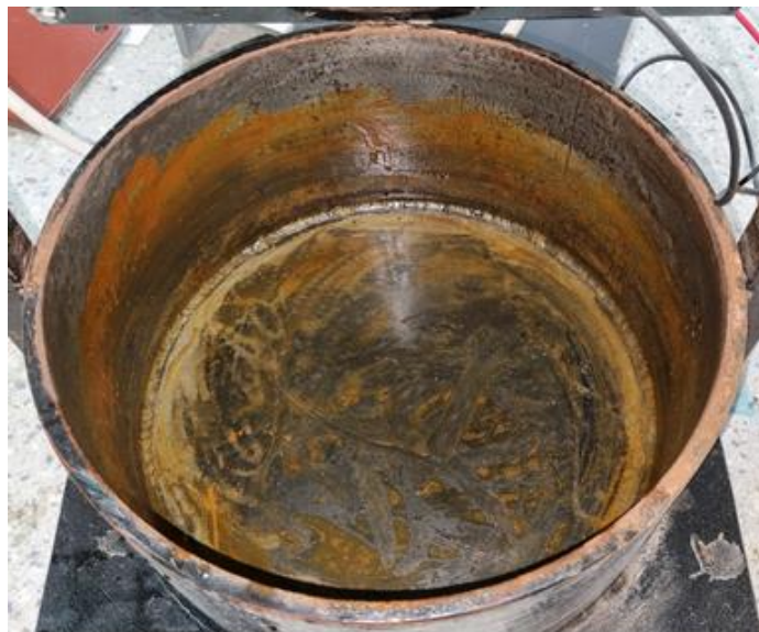
Slika 29. Spremnik nakon 45 dana ispitivanja
