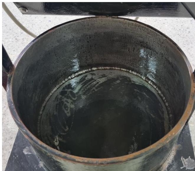
Slika 27. Model spremnika nakon nanesenog sloja M-645
