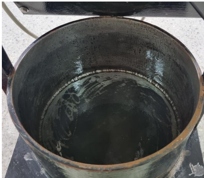
Slika 27. Model spremnika nakon nanesenog sloja M-645
