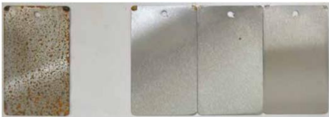
Slika 14. ASTM D1735 – rezultati ispitivanja s proizvodom A [23]
