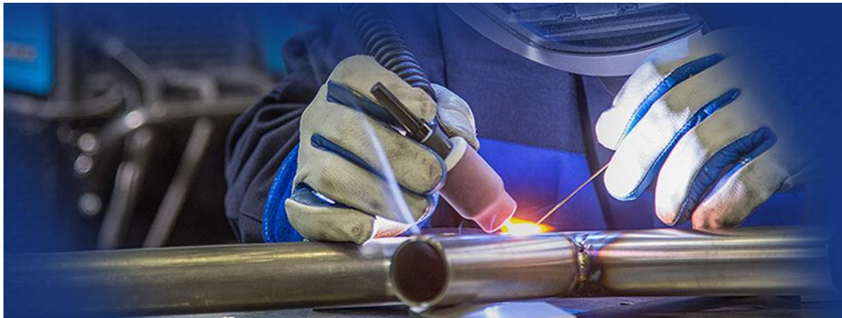
Slika 2. Ručno TIG zavarivanje [6]
