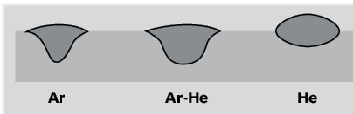
Slika 18. Izgled zavara u ovisnosti o strukturi zaštitnog plina [27]
