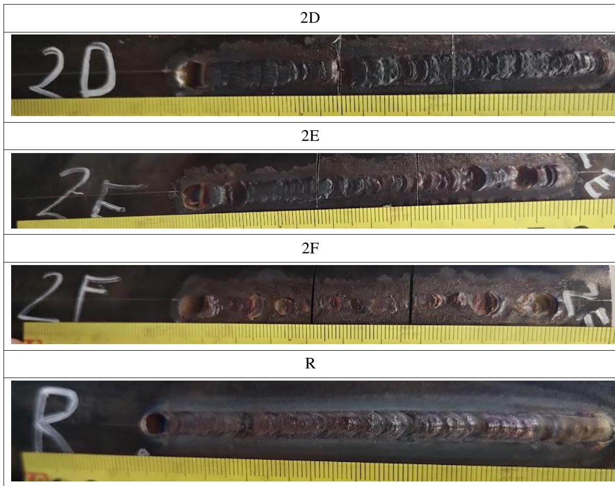
Prema slikama u tablici 13, te komentarima iz tablica 12, zaključeno je sljedeće. Referentni uzorak ima daleko najbolji izgled zavara, koji je kontinuiran, bez geometrijskih nepravilnosti, te bez promjena parametara tijekom zavarivanja. Zavari grupe 1 su vizualno bolje nego zavari grupe 2, razlog tomu je balans, koji je kod prve grupe zavara bio takav da je elektroda 10% više vremena na minus polu nego na plus polu.
