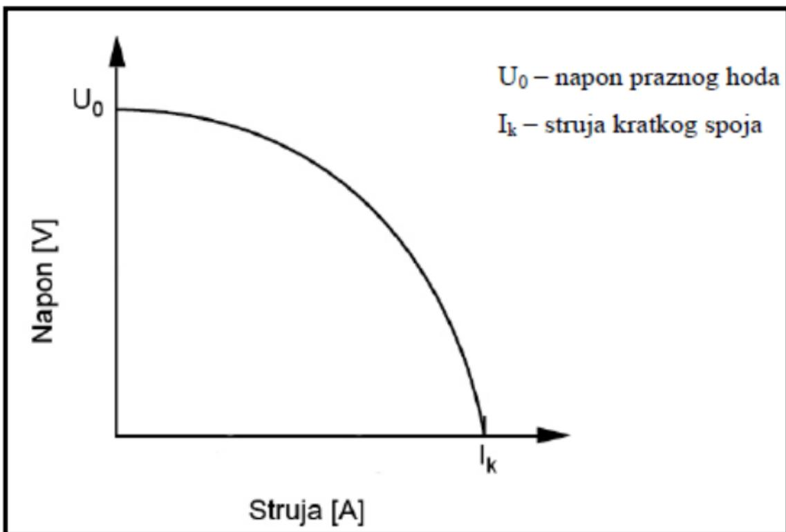
Slika 8. Statička strujna karakteristika – strmpadajuća (CC) [12]
