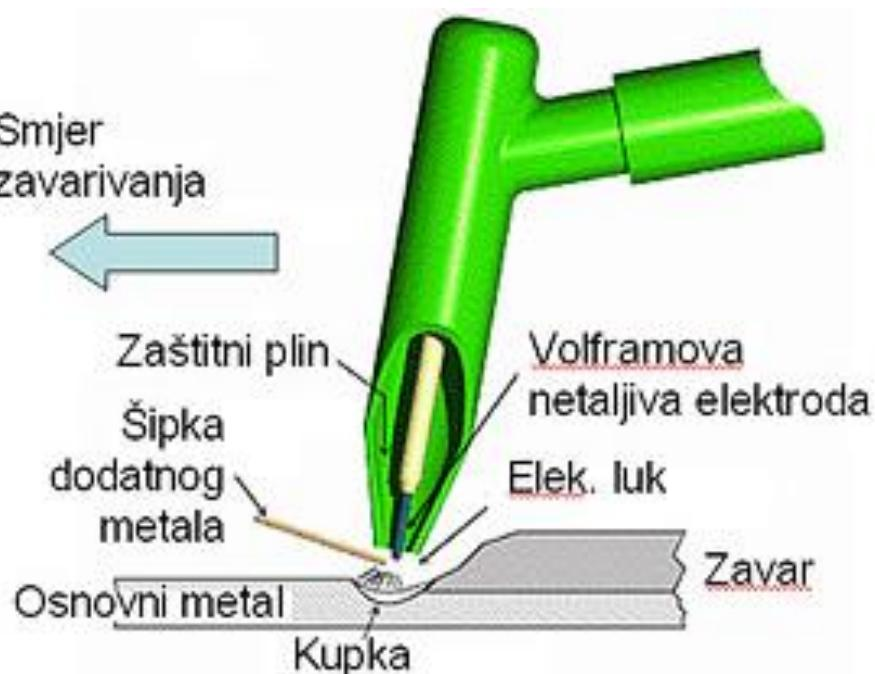
Slika 5. Shematski prikaz TIG postupka zavarivanja [10]
