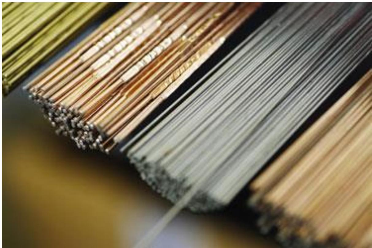
**Slika 19. Dodatni materijal za ručno TIG zavarivanje [30]**
