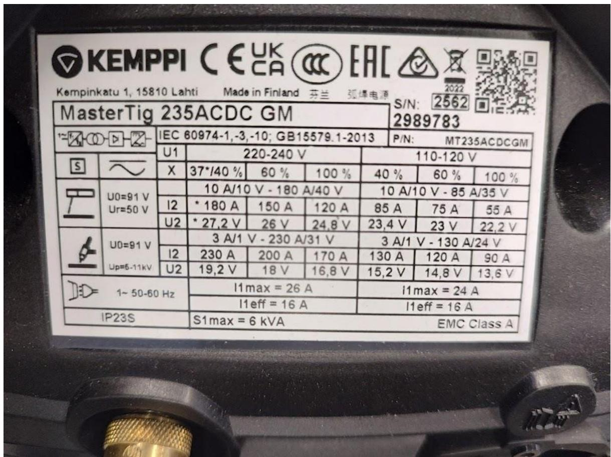
Slika 21. Natpisna pločica uređaja za zavarivanje
