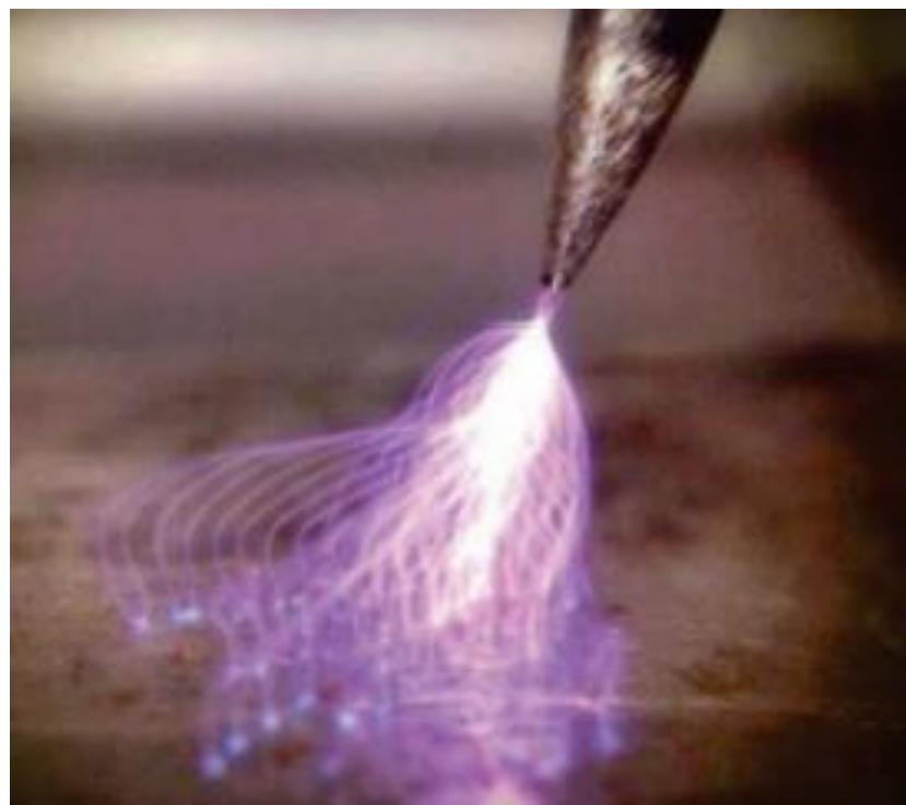
**Slika 9. Uspostavljanje luka uz visokofrekventni generator [14]**
