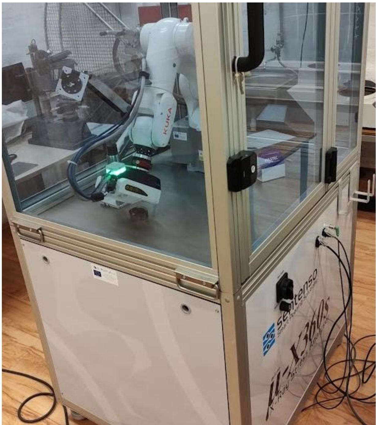
Slika 26. Uredaj za mjerjenje zaostalih naprezanja
