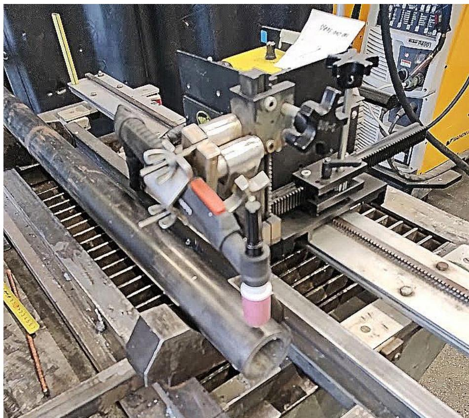
Slika 22. Pištolj za zavarivanje montiran na uredaj za vođenje
