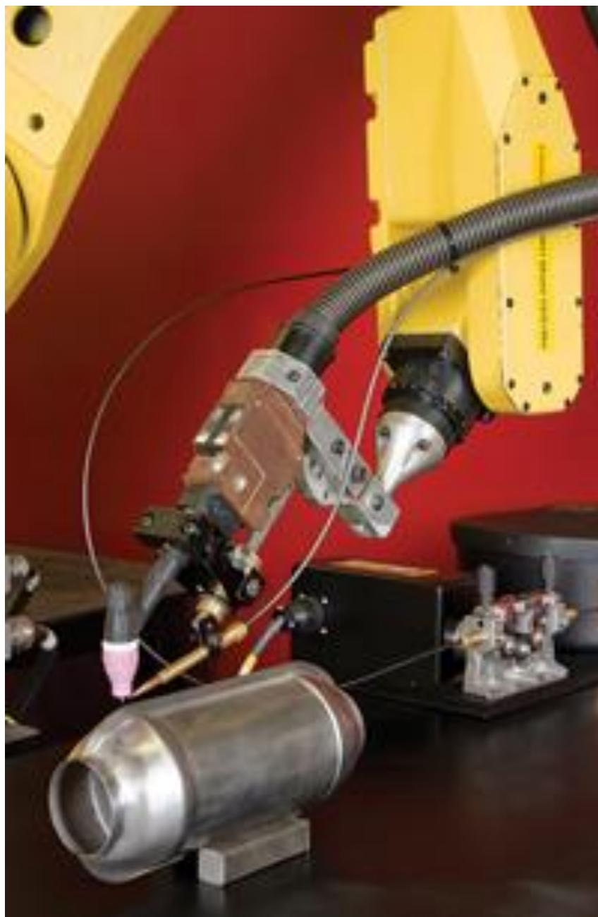
Slika 4. Robotizirano TIG zavarivanje [8]
