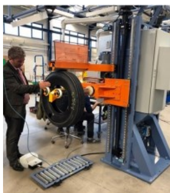
Slika 39. Proces kontrole kvalitete guma, [40]
