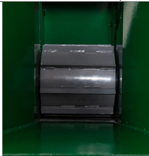
Slika 17. Valjak za povlačenje drvne mase
