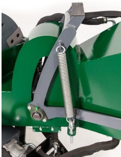
Slika 16. Mehanizam osiguranja pritiska na drvo i povratka u početni položaj valjka
