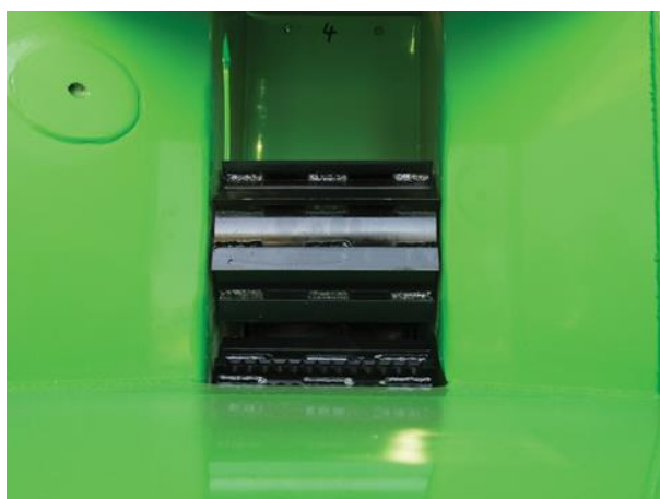
Slika 23. Valjci za povlačenje drvene mase
