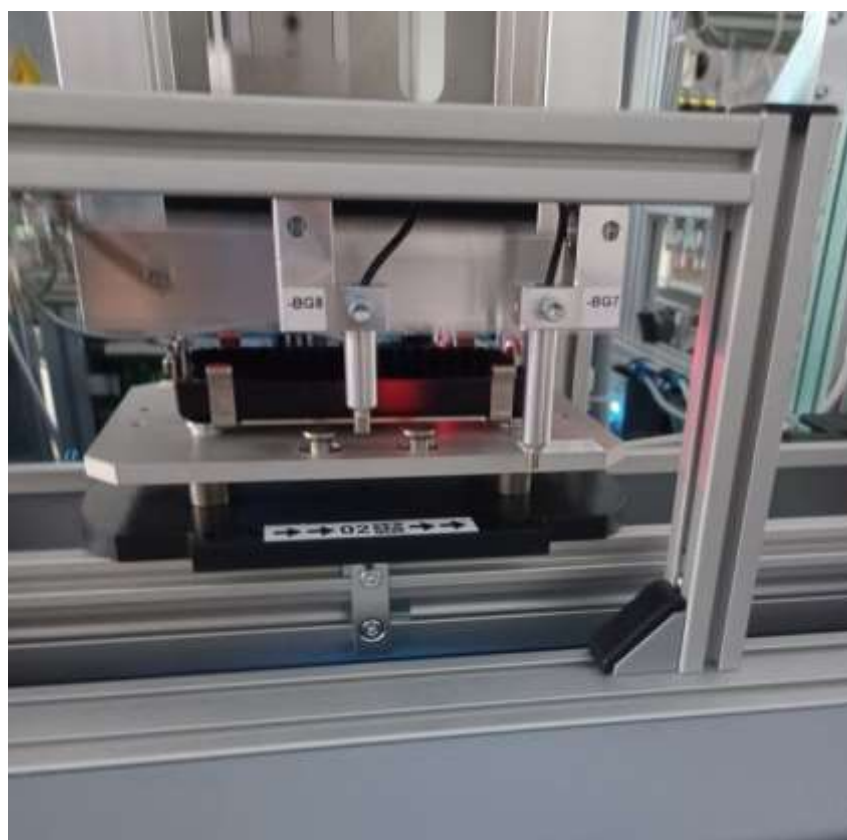
Slika 28. Spuštanje obratka na nosač
