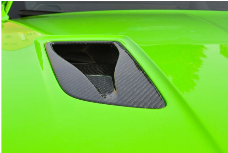
Slika 7.1. Primjer NACA usisnika izrađenog od kompozitnog materijala [37]
