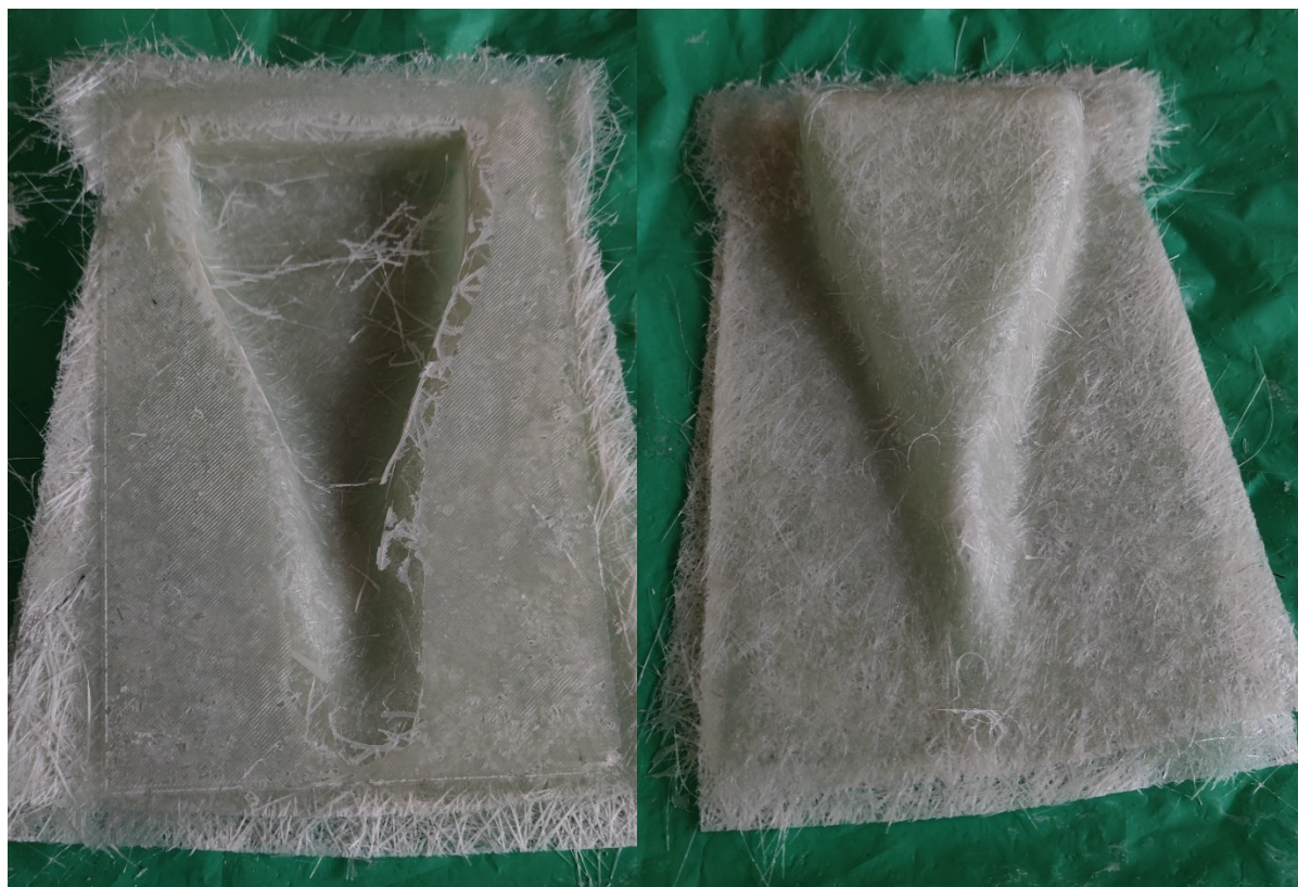
Slika 7.9. Kompozitna tvorevina izrađena ručnim laminiranjem s tri sloja staklenih vlakana
