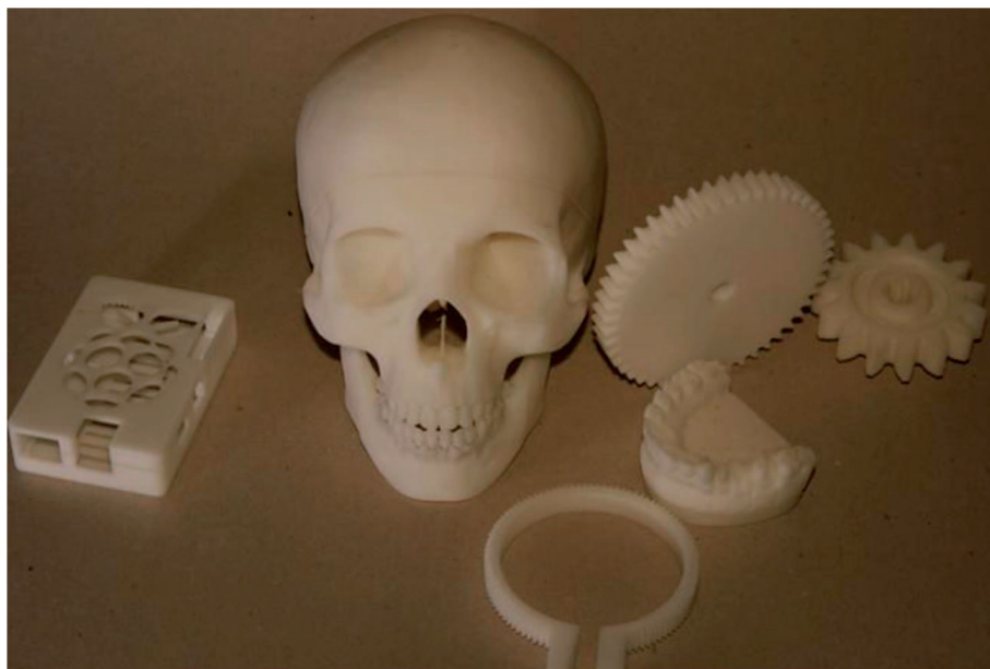
Slika 3.1. Primjeri proizvoda izrađenih postupkom FDM [8]
