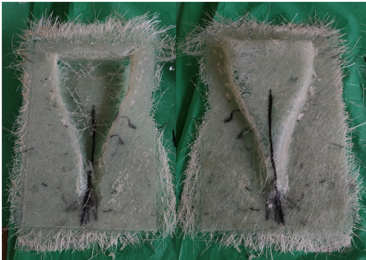
Slika 7.8. Kompozitna tvorevina izrađena ručnim laminiranjem s dva sloja staklenih vlakana
