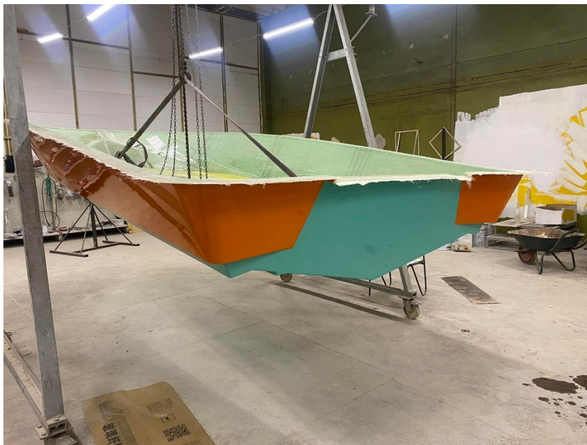
Slika 5.6. Izrada ribičkog broda postupkom ručnog laminiranja [24]
