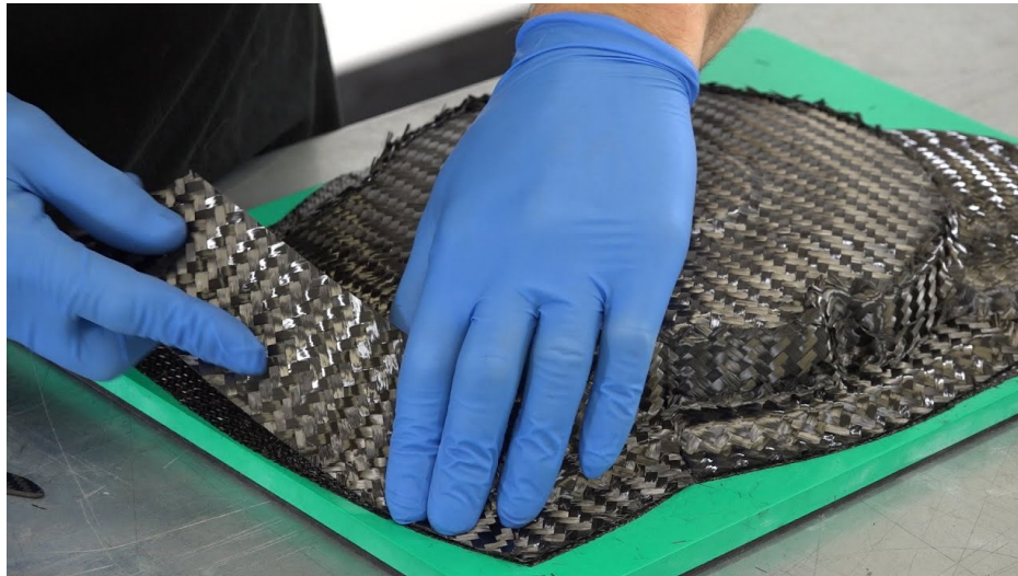
Slika 5.7. Polaganje slojeva ugljičnog preprega na otvoreni kalup [25]
