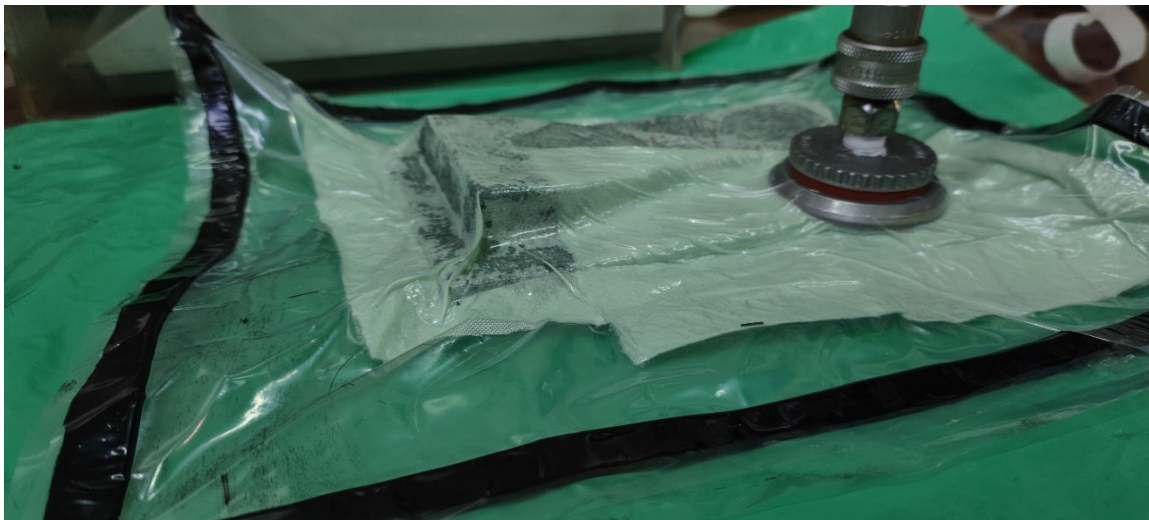
Slika 7.12. Istiskivanje zaostalog zraka u kompozitnom materijalu pomoću podtlačne pumpe
