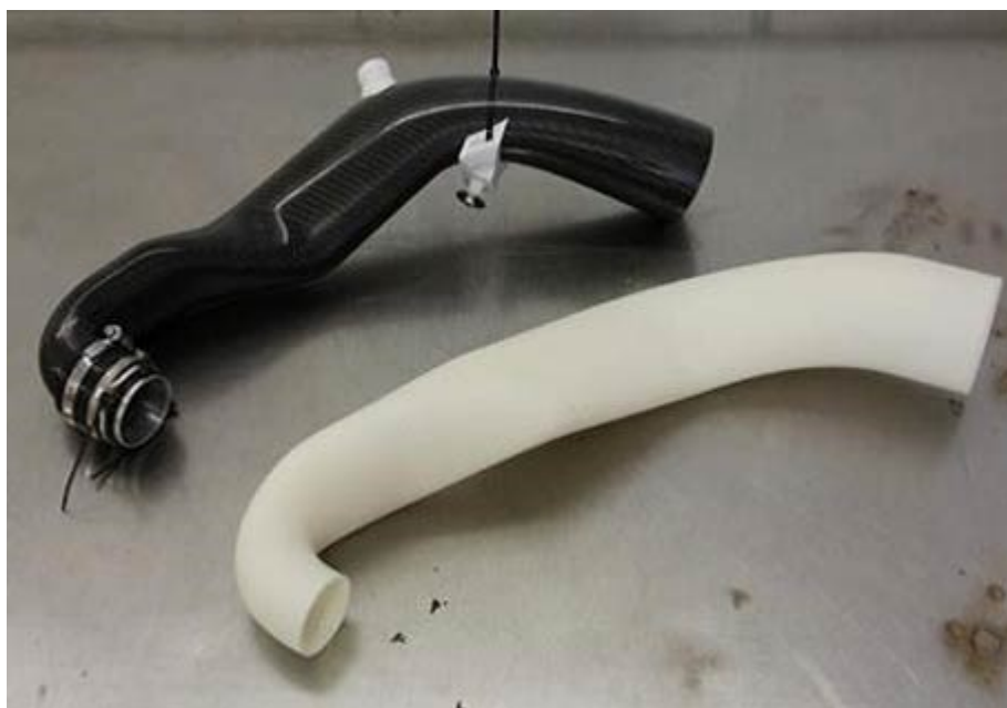
Slika 6.7. Jezgra i gotova tvorevina za izradu šupljih kompozita izrađena postupkom FDM [35]
