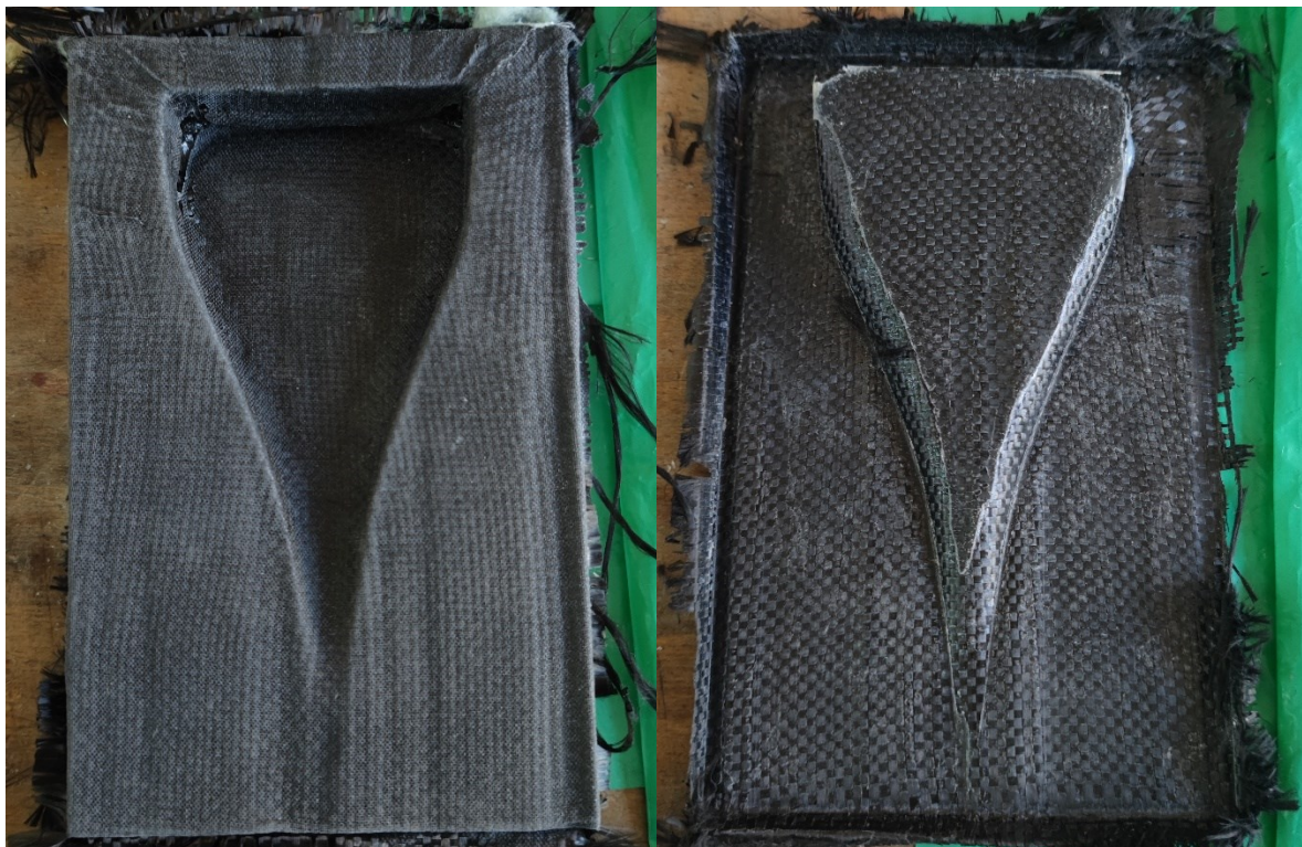
Slika 7.15. Kompozitna tvorevina izrađena ulaganjem ugljičnih vlakana u negativni oblik kalupa, tj. u unutarnju stranu kalupa
