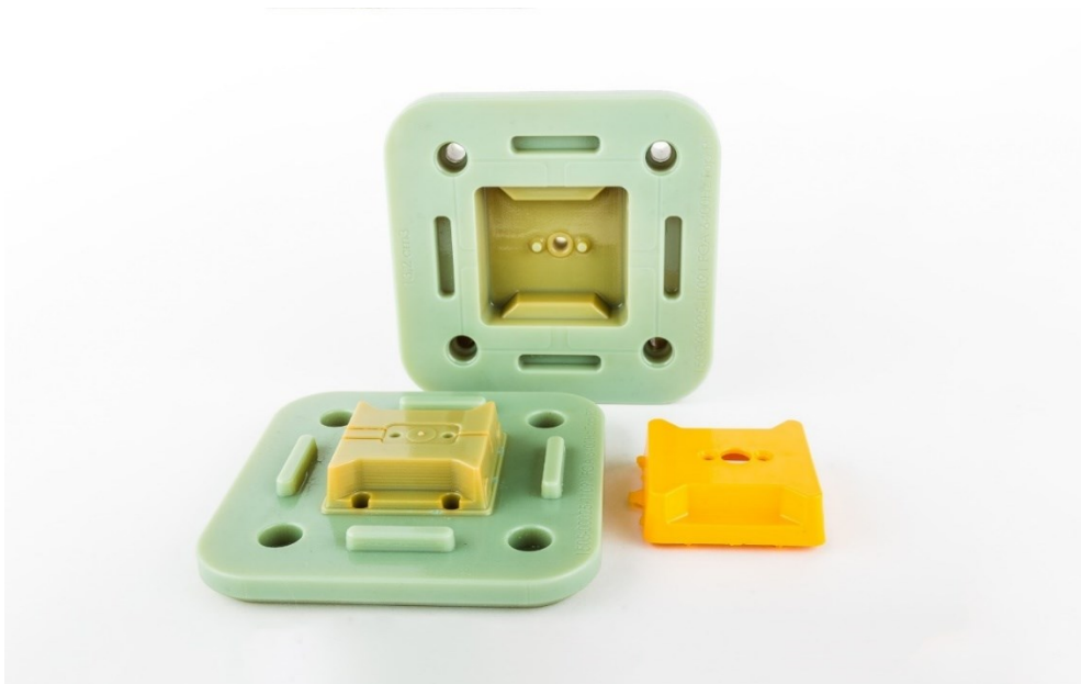
Slika 6.3. Kalup za injekcijsko prešanje izrađen postupkom Polyjet digital ABS plus materijalom [29]
