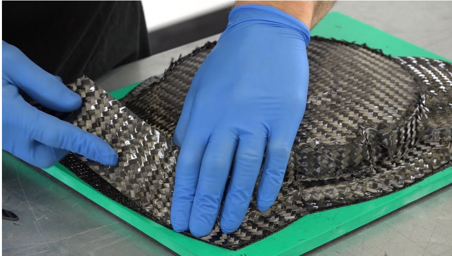
Slika 5.7. Polaganje slojeva ugljičnog preprega na otvoreni kalup [25]
