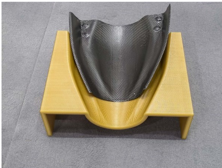
Slika 6.5. Kalup izrađen postupkom FDM te izvađena kompozitna tvorevina [33]
