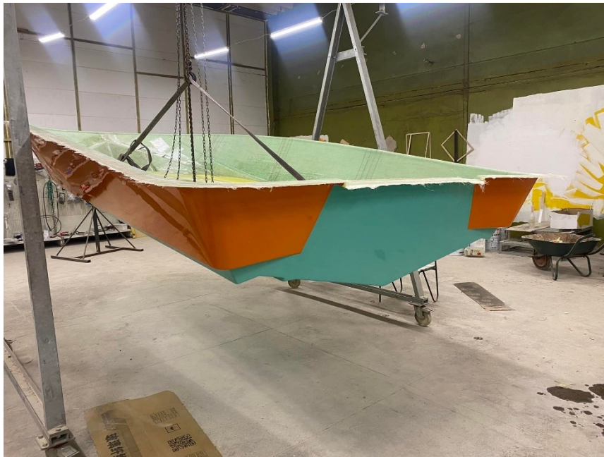
Slika 5.6. Izrada ribičkog broda postupkom ručnog laminiranja [24]
