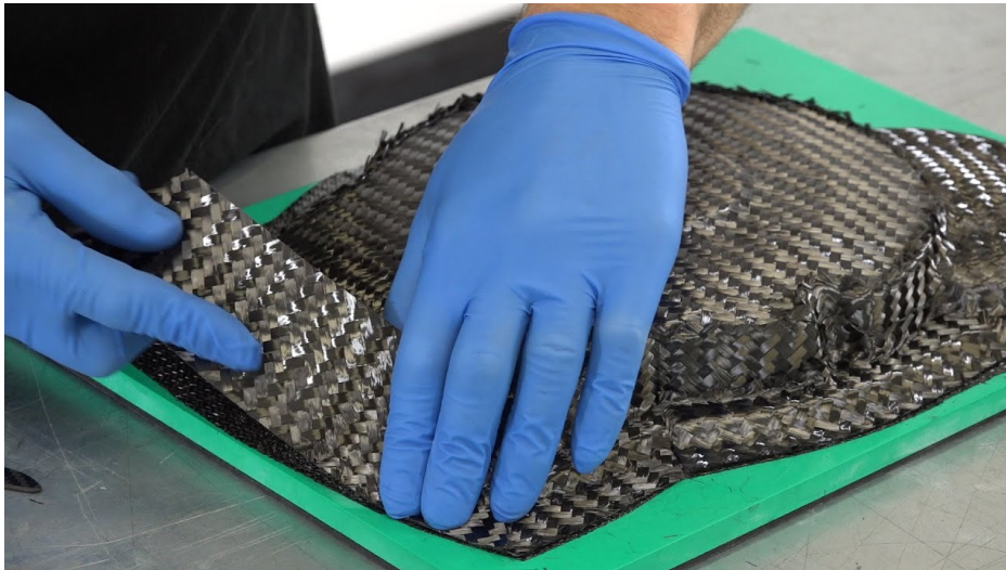
Slika 5.7. Polaganje slojeva ugljičnog preprega na otvoreni kalup [25]
