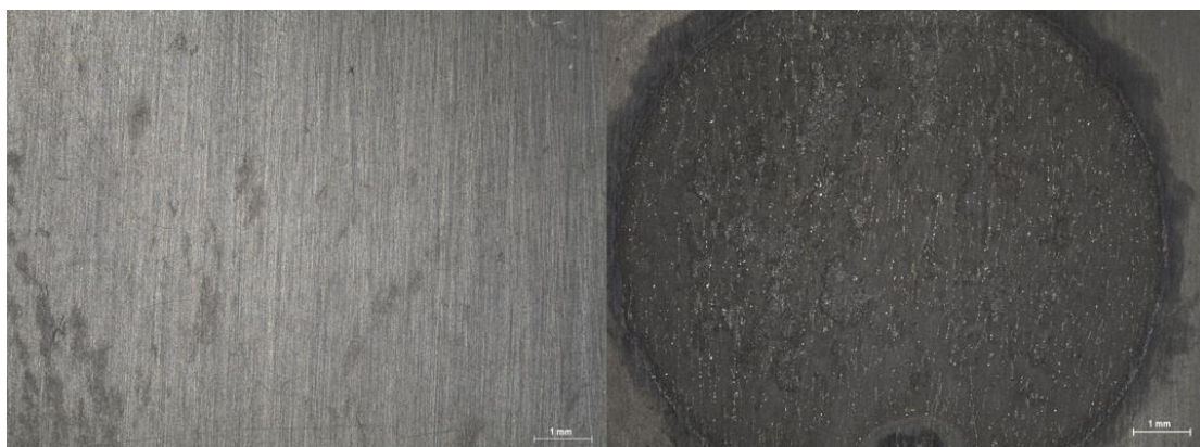
Slika 30. Izgled površine uzorka A3 prije i nakon elektrokemijskih ispitivanja pod povećanjem od 12.5x
