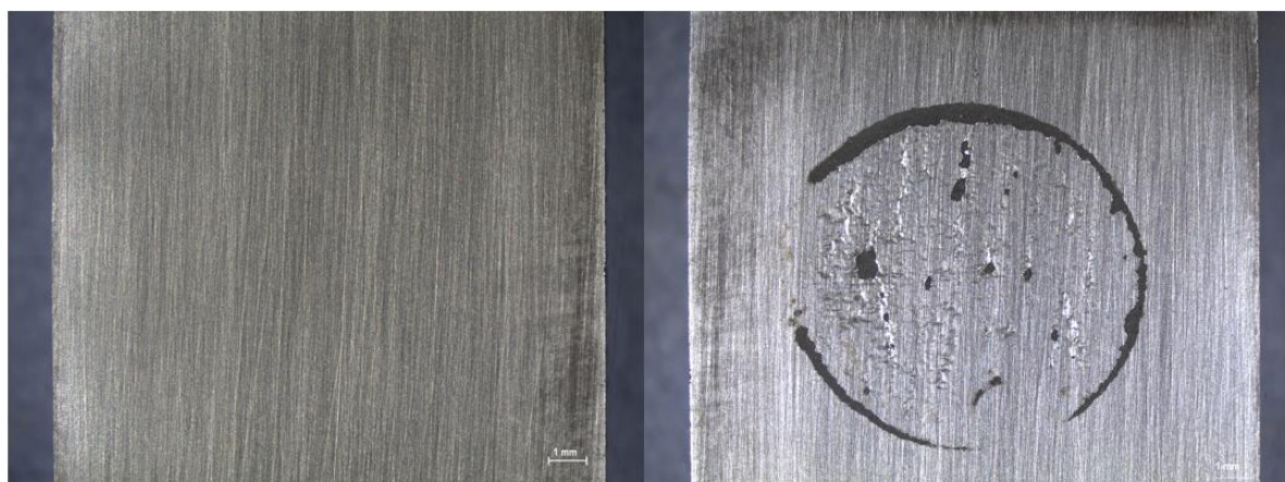
Slika 27. Izgled površine uzorka A0 prije i nakon elektrokemijskih ispitivanja pod povećanjem od 7.88x
