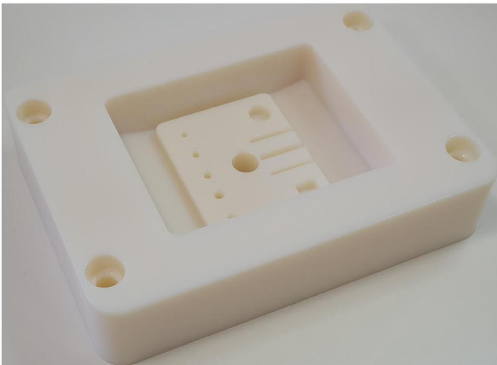
**Slika 7. 5. Matrica proizvedena s pomoću PolyJet tehnologije**
