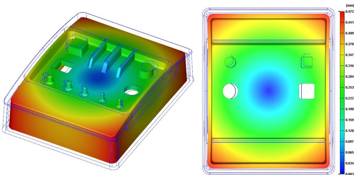
Slika 6. 22. Deformacija otpreska načinjenog čeličnim kalupnim umetcima
