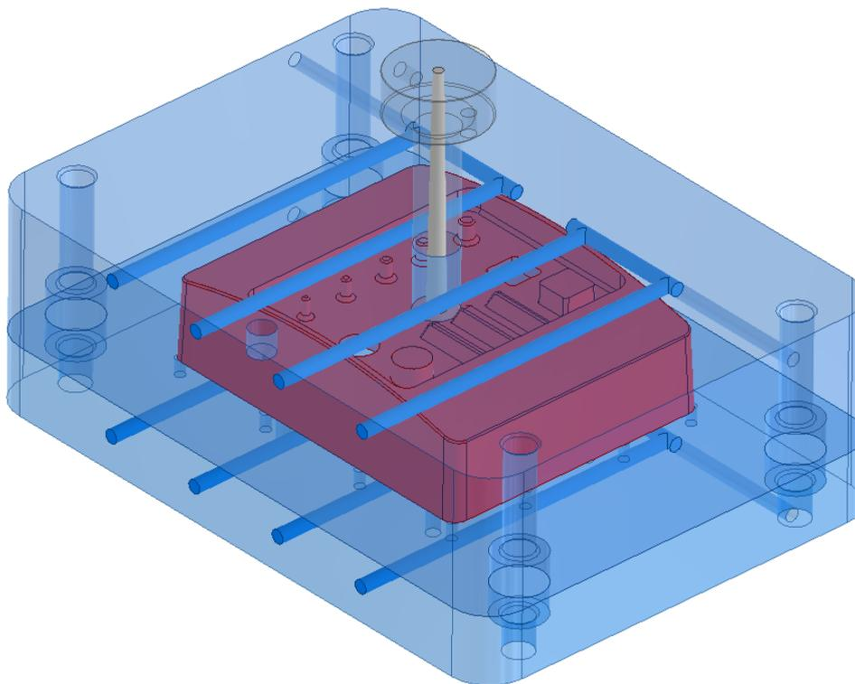
Slika 6. 17. Simulacijski model čeličnih kalupnih umetaka
