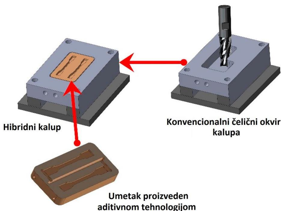
Slika 2. 3. Način izrade hibridnog kalupa [11]
