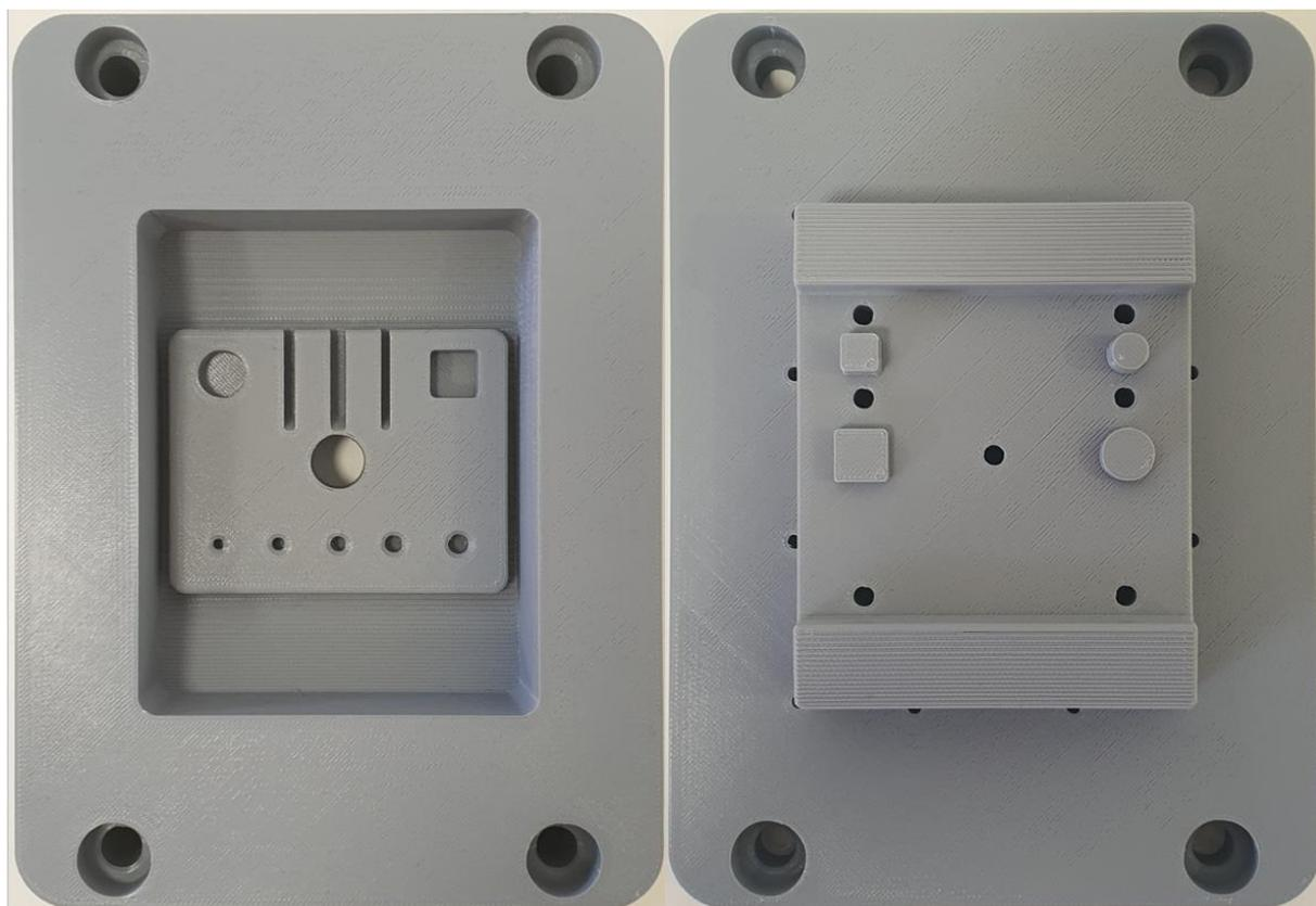
Slika 7. 1. Kalupni umetci proizvedeni s pomoću FFF tehnologije
