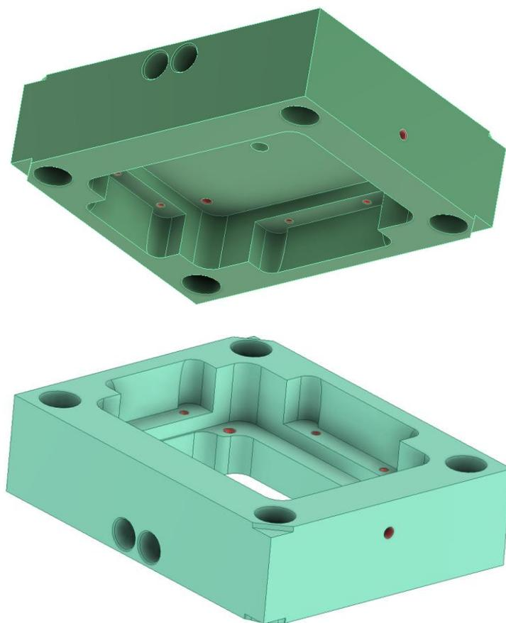
Slika 5. 6. Pomična i nepomična kalupna ploča
