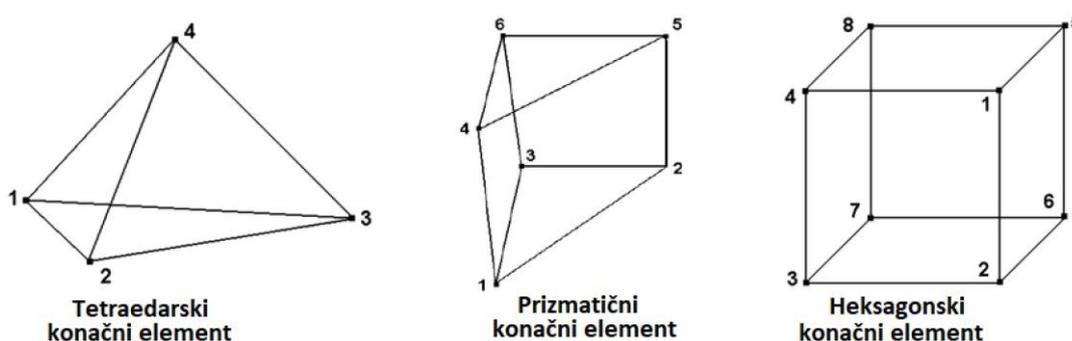
Slika 6. 2. Linearni trodimenzionalni konačni elementi [37]
