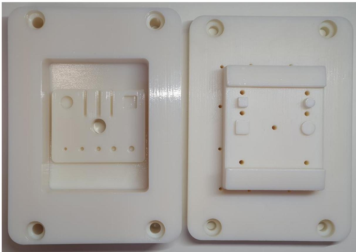
**Slika 7. 4. Kalupni umetci proizvedeni s pomoću PolyJet tehnologije**
