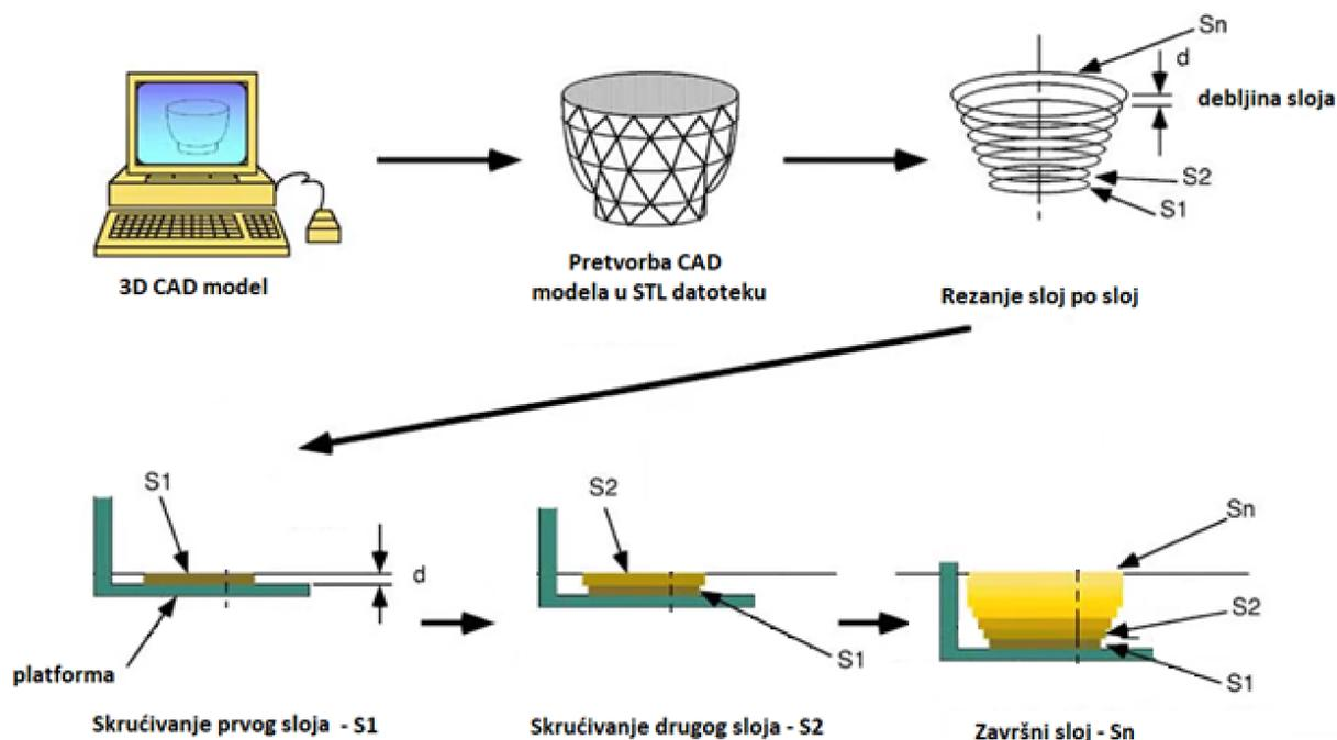
Slika 3. 2. Način proizvodnje s pomoću aditivnih tehnologija [18]
