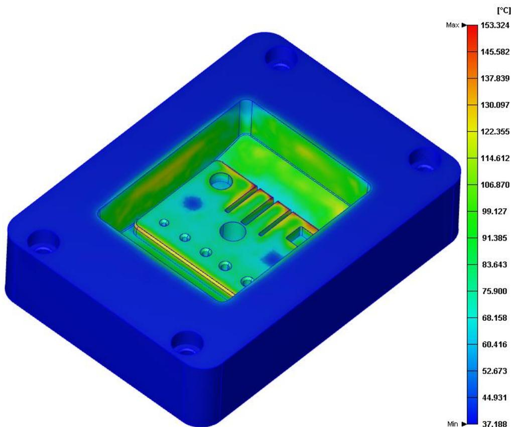
Slika 6. 9. Raspodjela temperatura na polimernoj matrici
