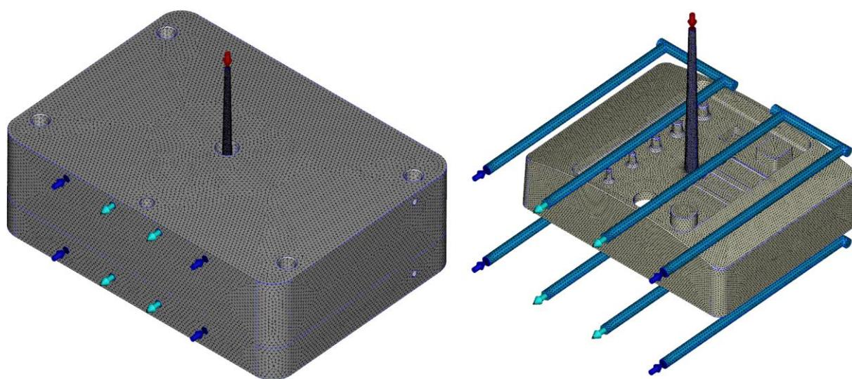
Slika 6. 18. Mreža konačnih elemenata čeličnih kalupnih umetaka
