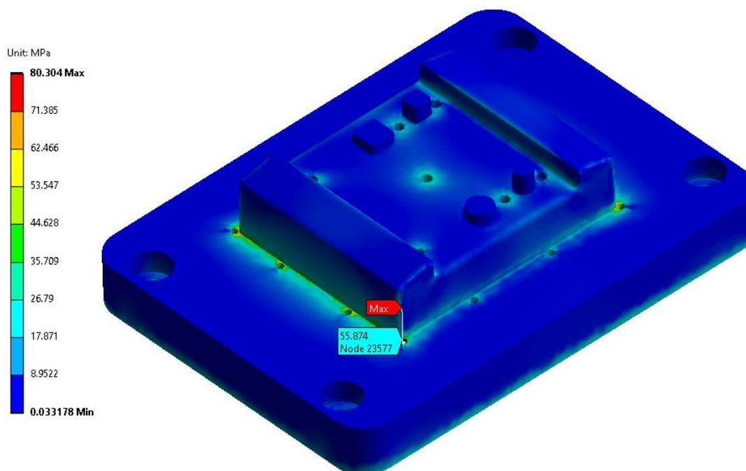
Slika 6. 31. Von Mises naprezanja polimernog žiga
