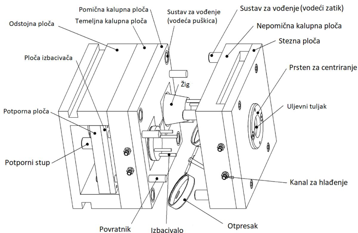
Slika 2. 2. Kalup za injekcijsko prešanje [5]
