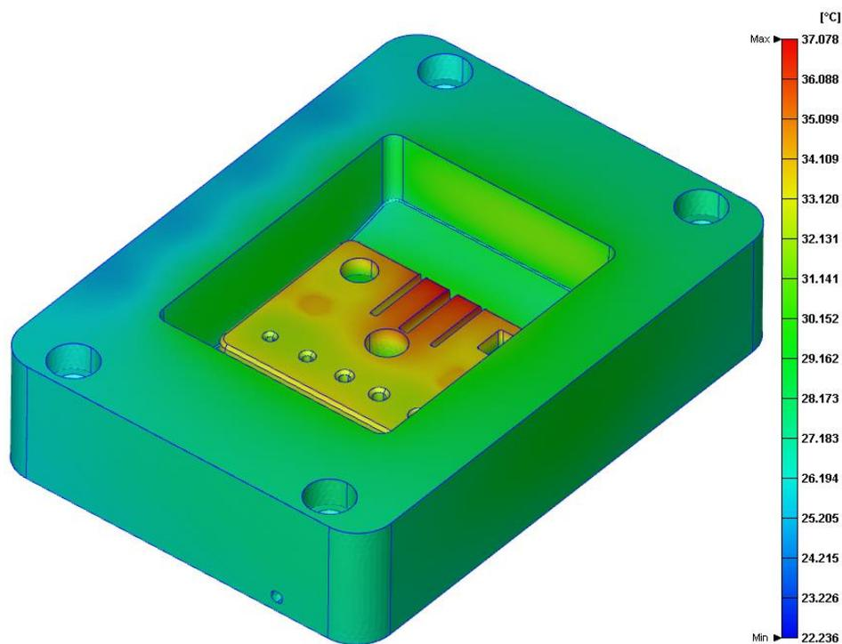
Slika 6. 20. Raspodjela temperatura na čeličnoj matrici
