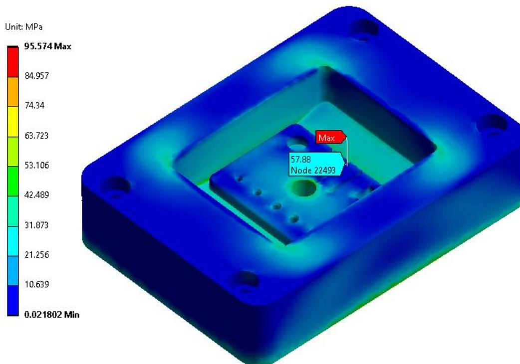
Slika 6. 30. Von Mises naprezanja polimerne matrice
