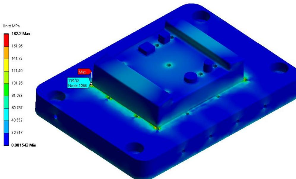
Slika 6. 36. Von Mises naprezanja čelične matrice
