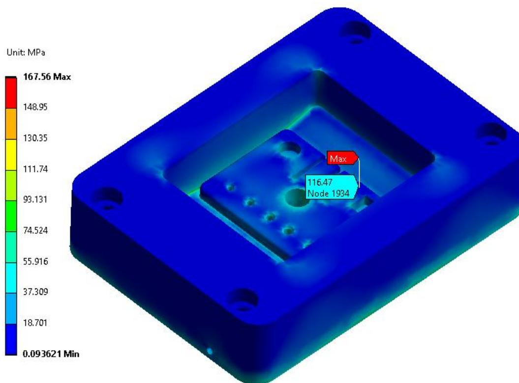
Slika 6. 35. Von Mises naprezanja čelične matrice
