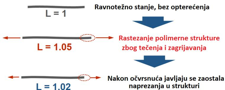
Slika 6. 12. Polimerna struktura prilikom injekcijskog prešanja [38]
