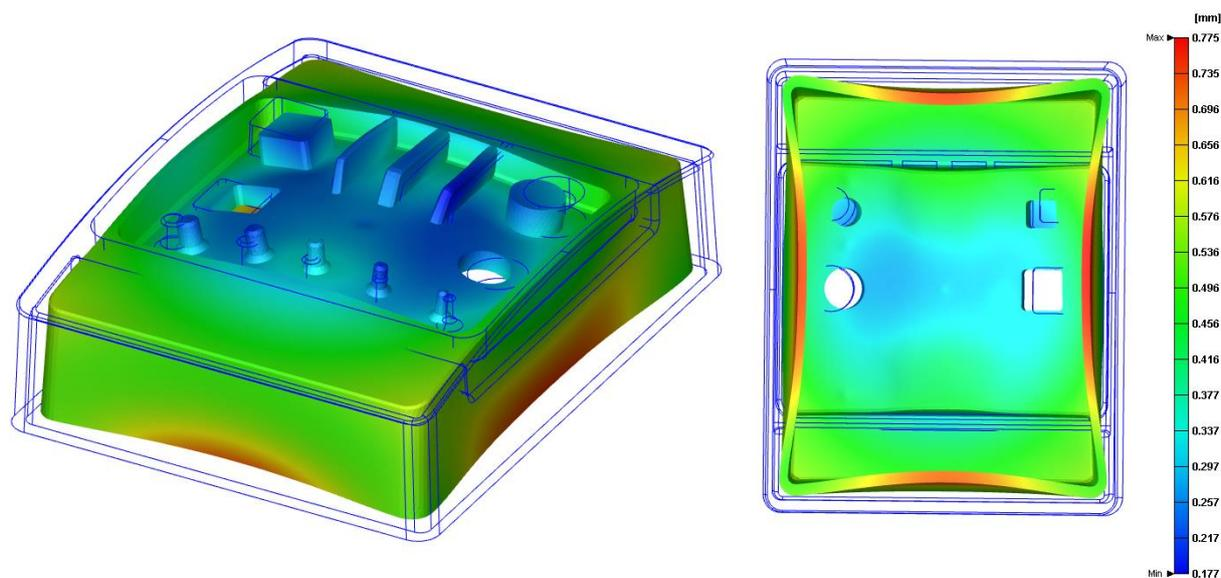
Slika 6. 11. Deformacija otpreska načinjenog polimernim kalupnim umetcima
