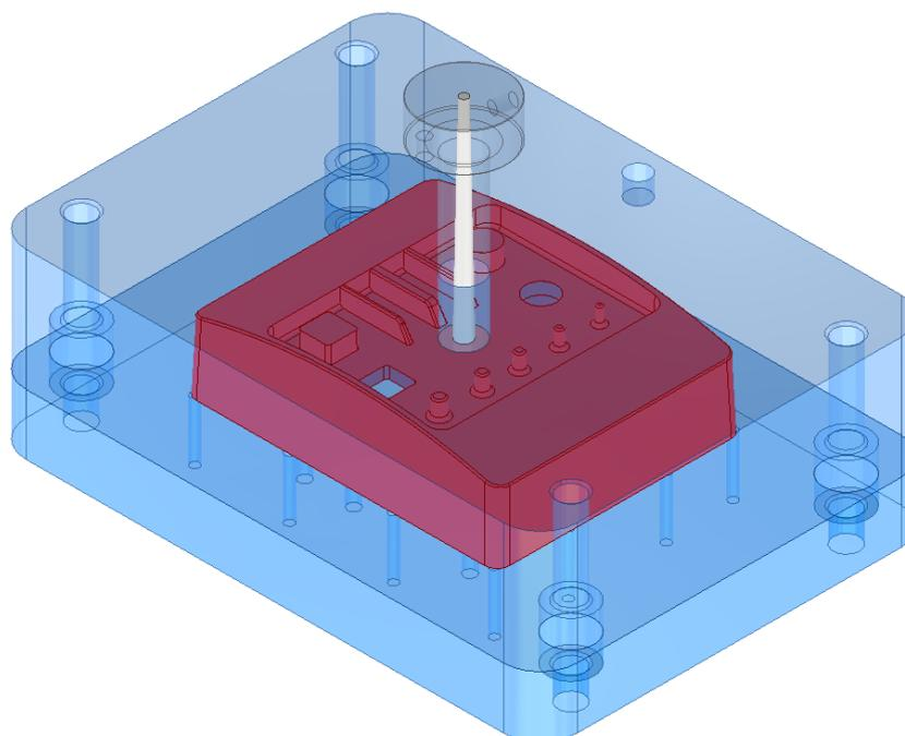
**Slika 6. 4. Simulacijski model polimernih kalupnih umetaka**
