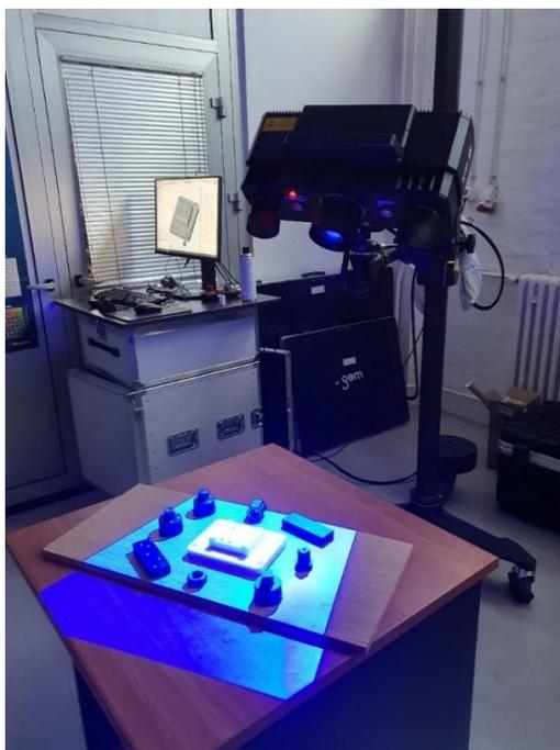
Slika 7. 7. Postupak skeniranja 3D ispisanih polimernih kalupnih umetaka
