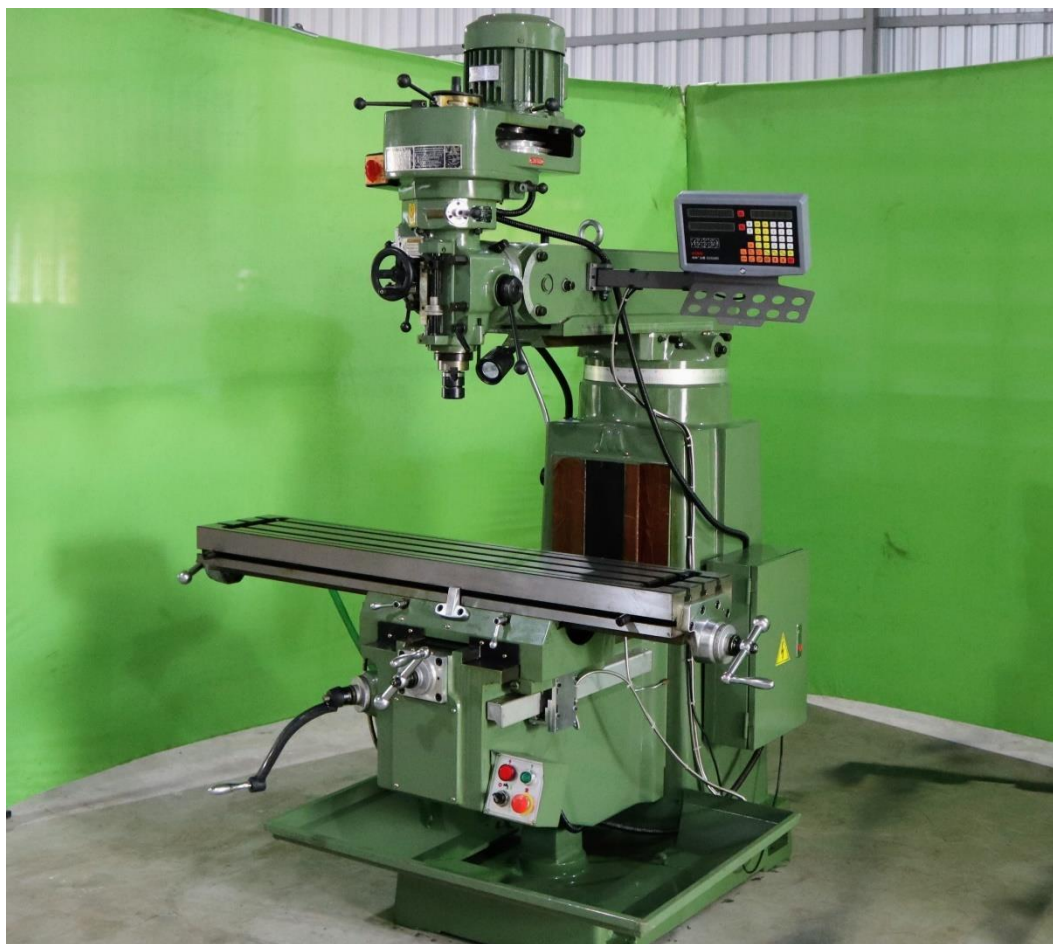
Slika 2. Vertikalna 3 – osna stupna glodalica [4]
