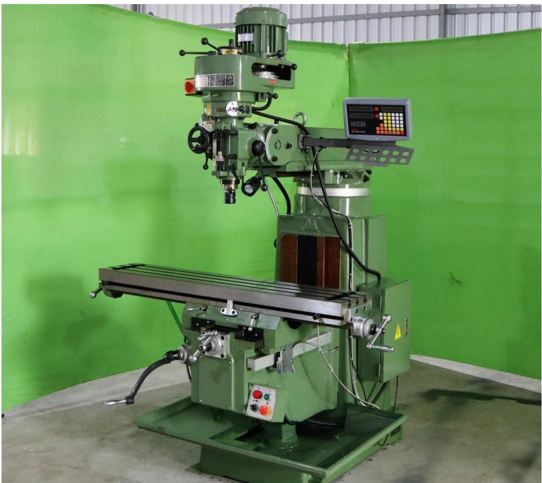
Slika 2. Vertikalna 3 – osna stupna glodalica [4]
