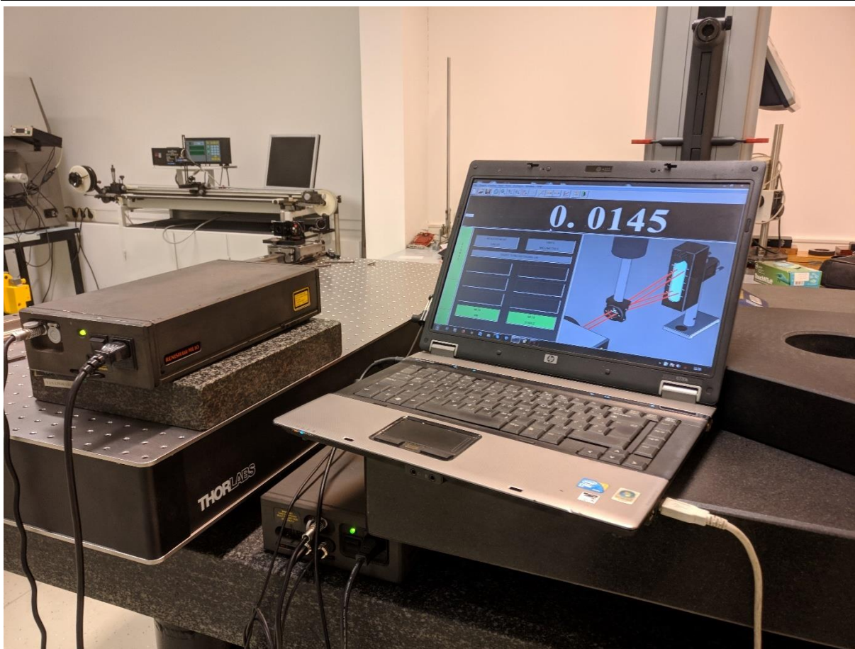
Slika 19. Renishaw ML10 spojen na prijenosno računalo i kompenzator okolišnih uvjeta
