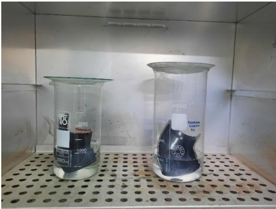
Slika 23. Uzorci E1 i E2 u otopini fosforne kiseline stavljeni na grijanje
