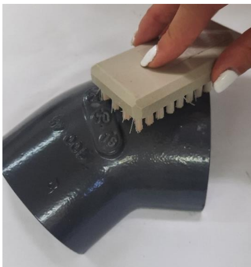
Slika 26. Odstranjivanje čestica četkom
