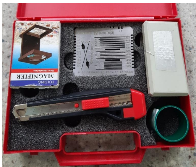
Slika 24. Oprema za ispitivanje prionjivosti Cross-cut metodom
