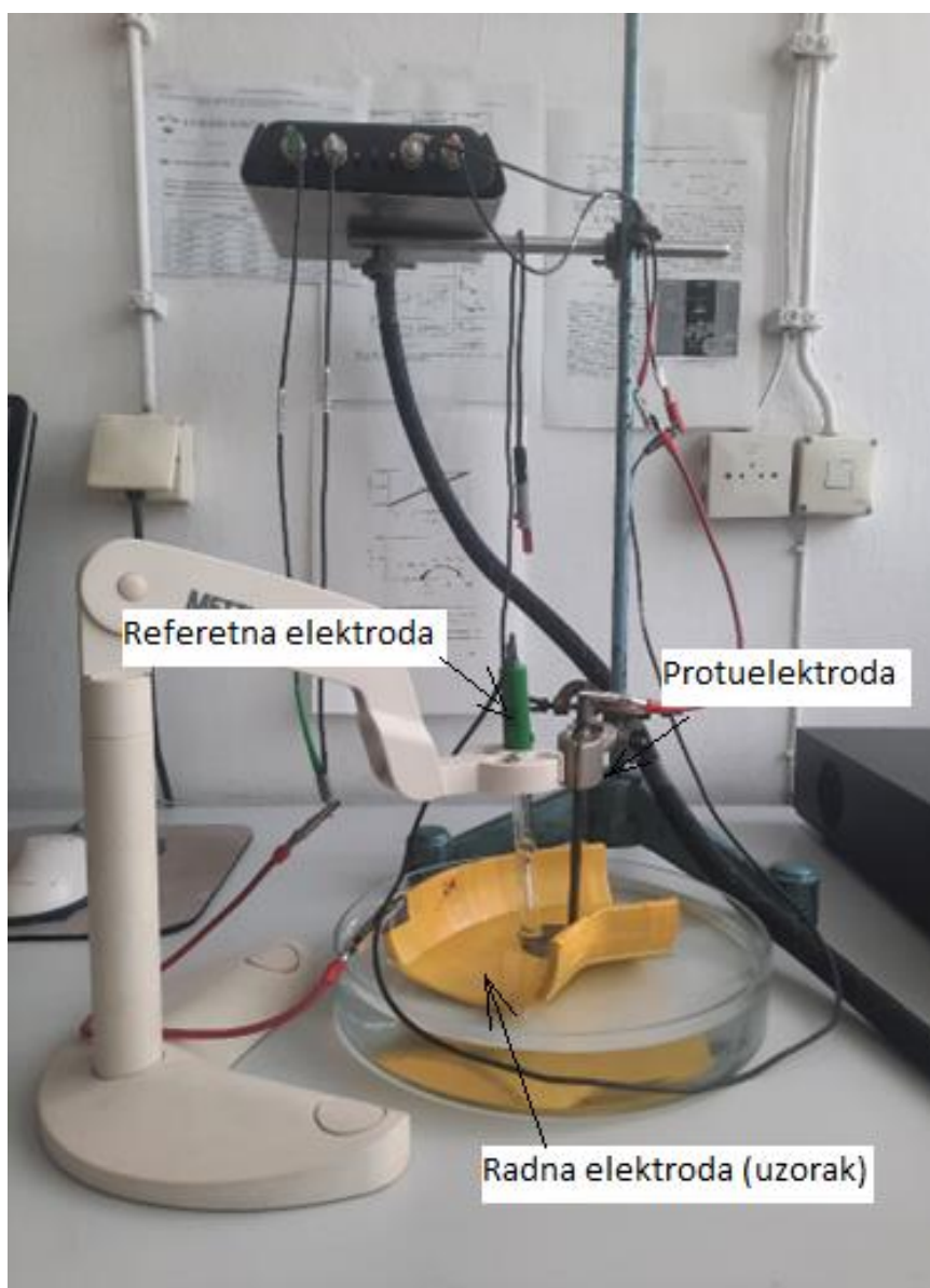
Slika 31. Uzorak pripremljen za EIS ispitivanje
