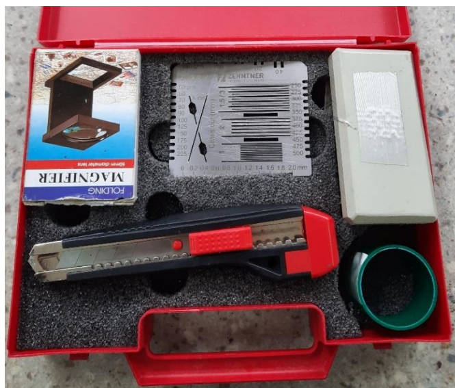
Slika 24. Oprema za ispitivanje prionjivosti Cross-cut metodom
