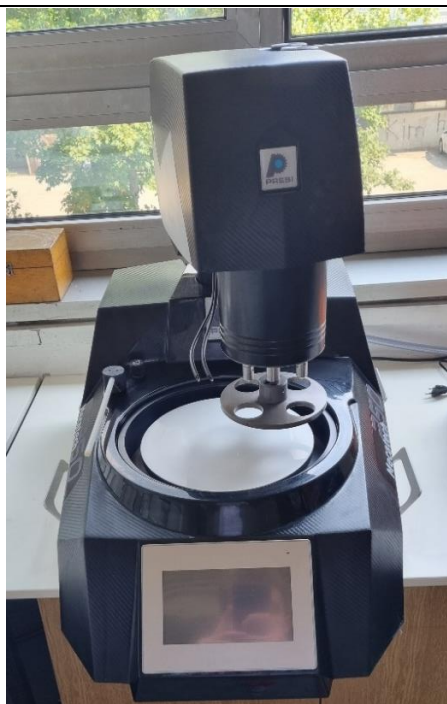
Slika 22. Uređaj za brušenje i poliranje Mecatech 250 – PRESI
