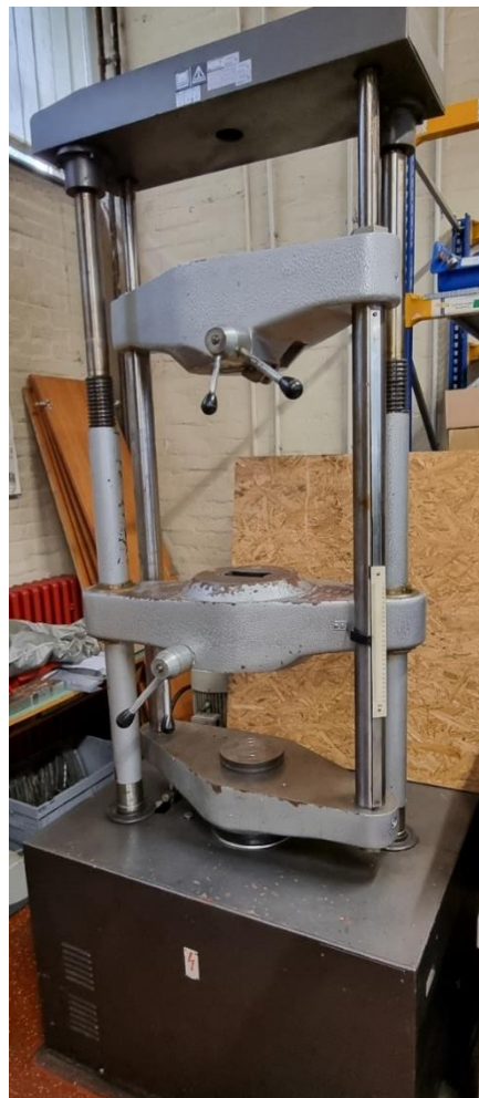
Slika 12. Kidalica VEB WPM / Eumod / 400 kN
