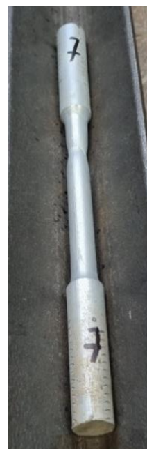
Slika 21. Epruveta 7 nakon ispitivanja
