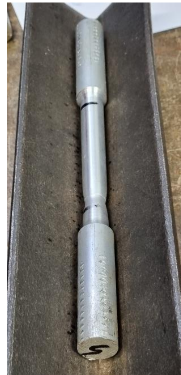
Slika 16. Epruveta 4 nakon ispitivanja
