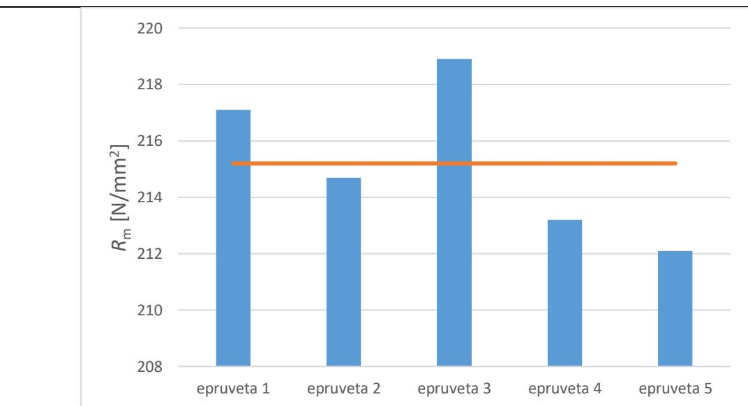
Slika 33. Grafički prikaz vrijednosti vlačne čvrstoće epruveta u isporučenom stanju
