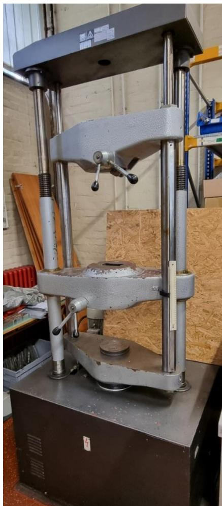
Slika 12. Kidalica VEB WPM / EUmod / 400 kN
