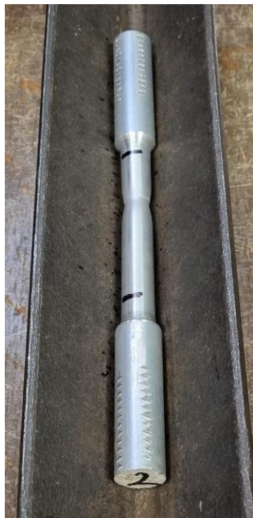
Slika 14. Epruveta 2 nakon ispitivanja
