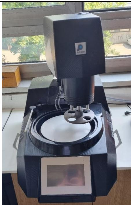
**Slika 22. Uredaj za brušenje i poliranje Mecatech 250 – PRESI**
