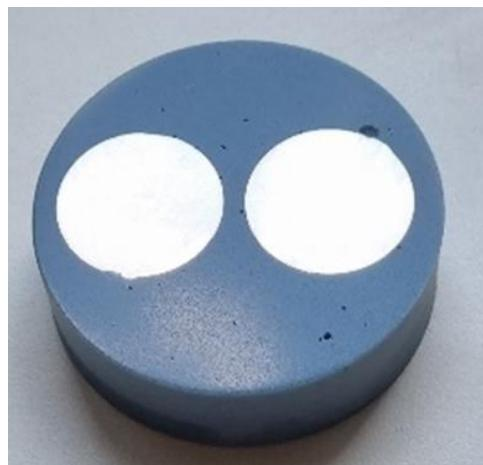
Slika 29. Uzorak 1 (lijevo) i 6 (desno) za mjerenje tvrdoće i analizu mikrostrukture
