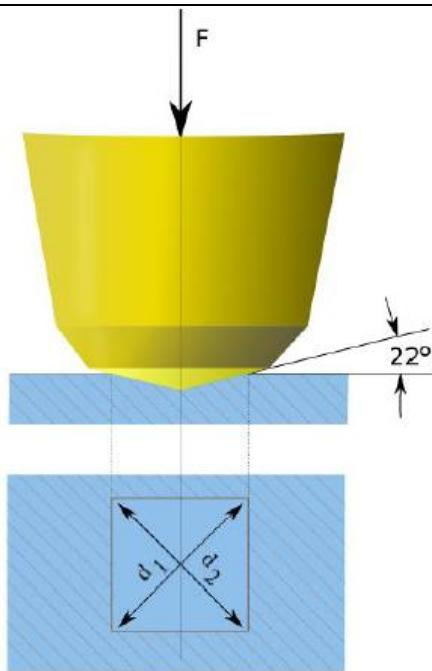
**Slika 9.** Prikaz mjerjenja tvrdoće Vickersovom metodom [18]
