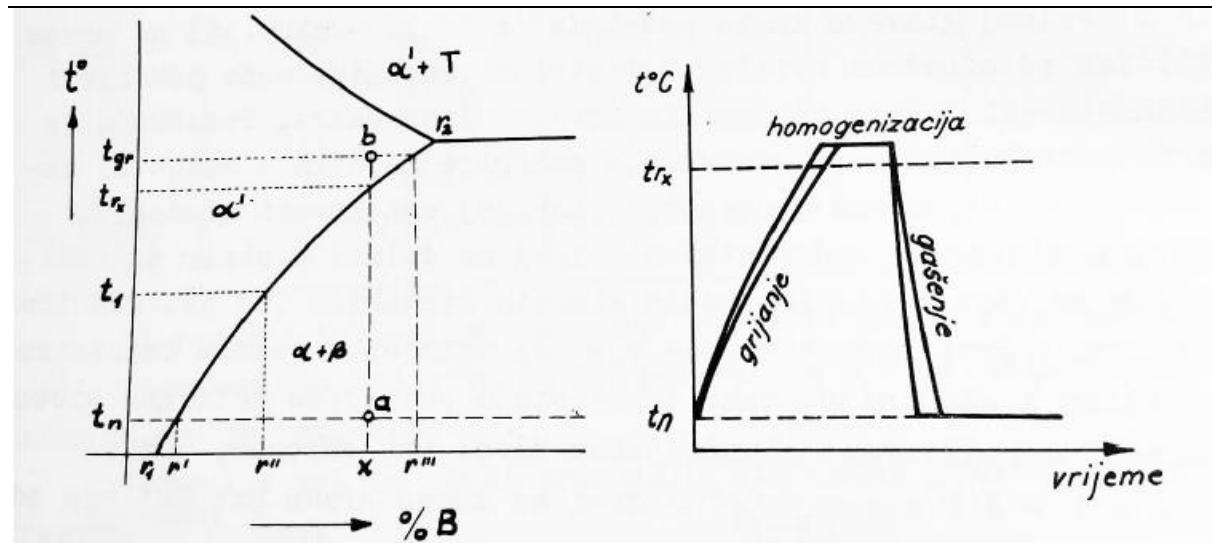
Slika 6. Dijagram stanja precipitacijsko očvrstnute aluminijske legure [17]
