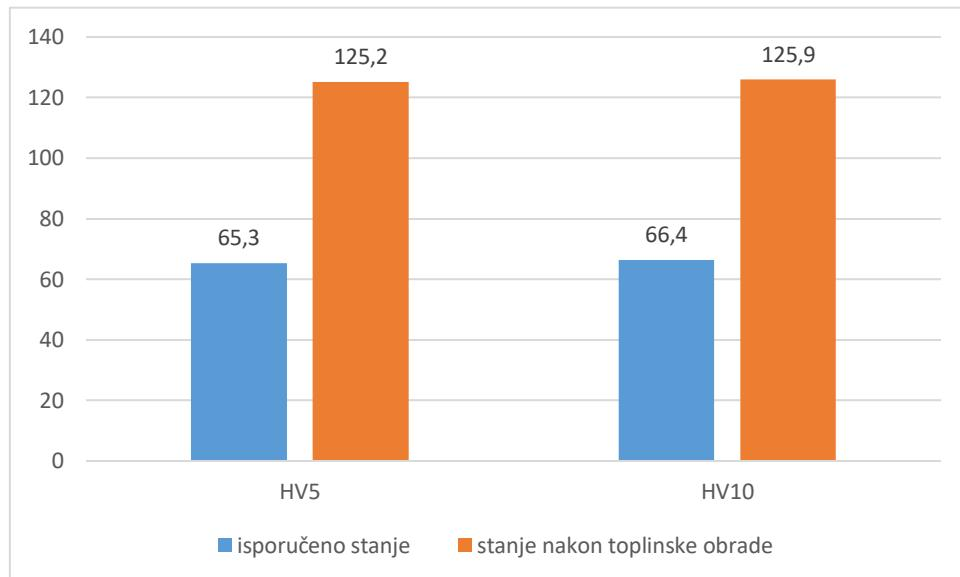
**Slika 44. Usporedba srednjih vrijednosti tvrdoča u isporučenom stanju i nakon toplinske obrade**
