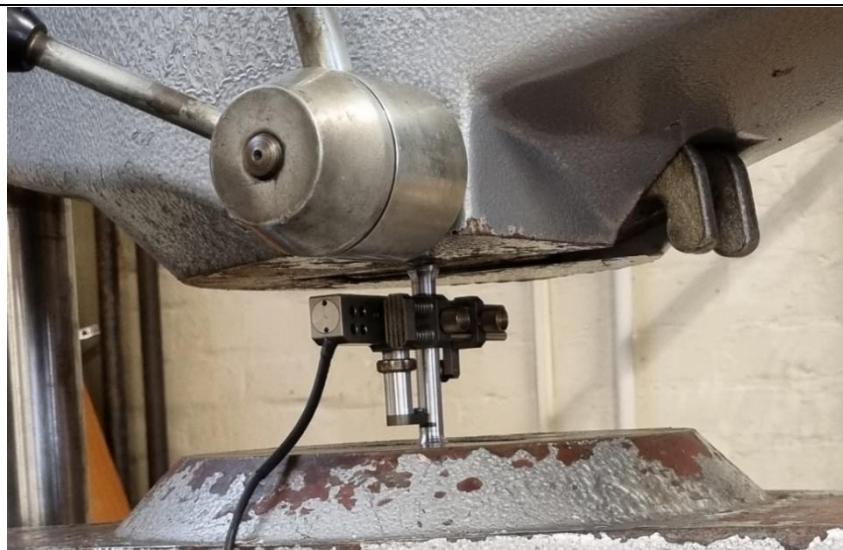
**Slika 13. Elektronski ekstenziometar MFA2**
