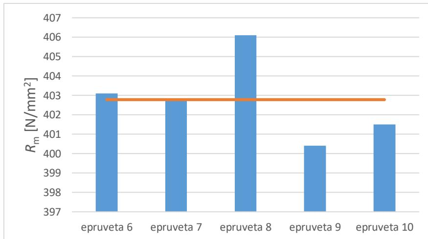
**Slika 37. Grafički prikaz vrijednosti vlačne čvrstoće epruveta nakon toplinske obrade**
