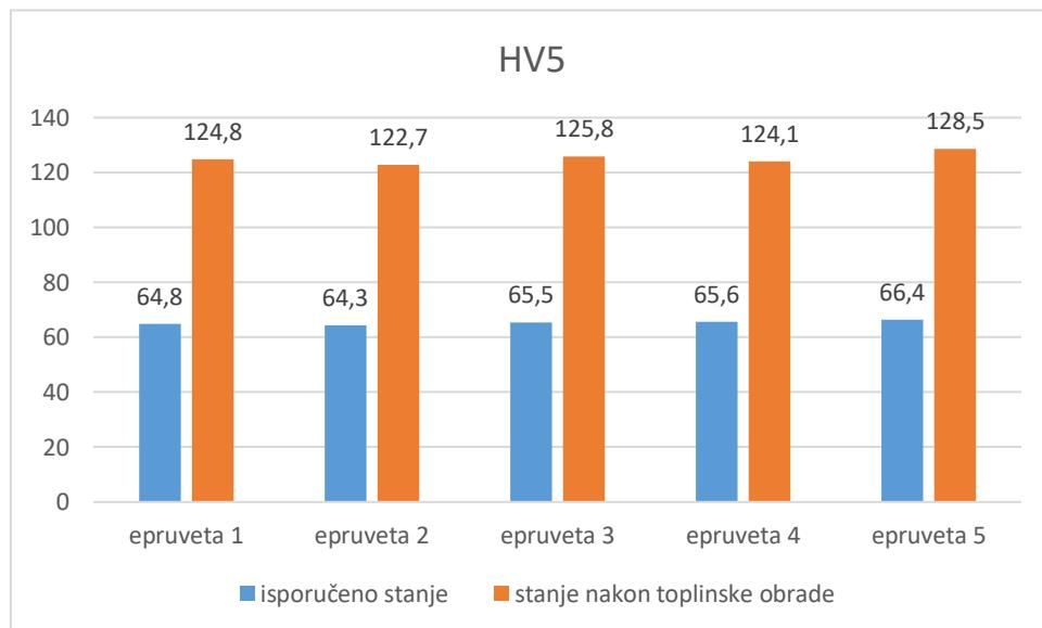
**Slika 42. Usporedba iznosa tvrdoće HV5**
