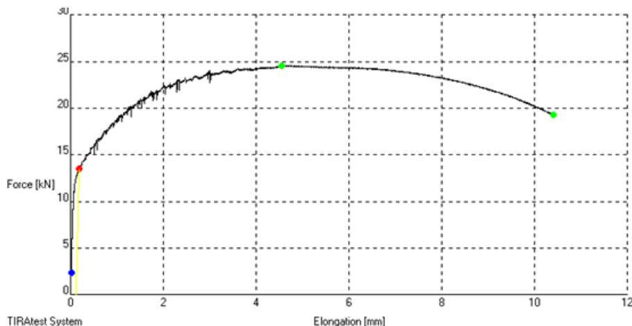
**Slika 17. Dijagram kidanja za epruvetu 2**
