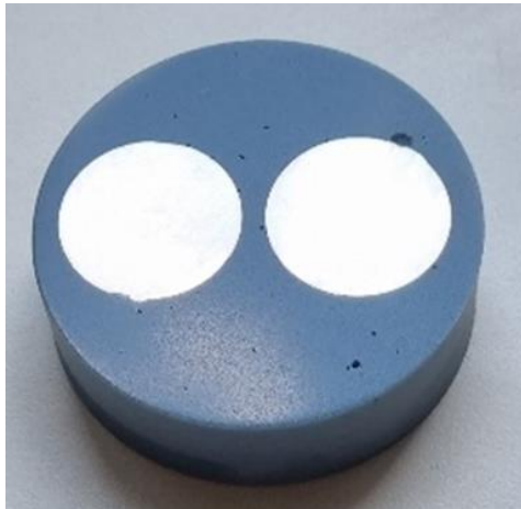
Slika 29. Uzorak 1 (lijevo) i 6 (desno) za mjerenje tvrdoće i analizu mikrostrukture
