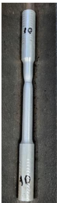
Slika 19. Epruveta 10 nakon ispitivanja
