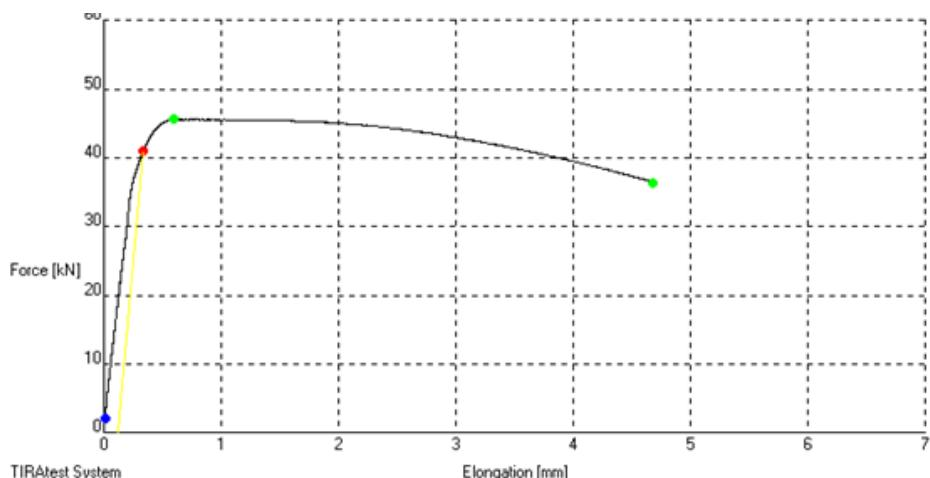
**Slika 18. Dijagram kidanja za epruvetu 6**
