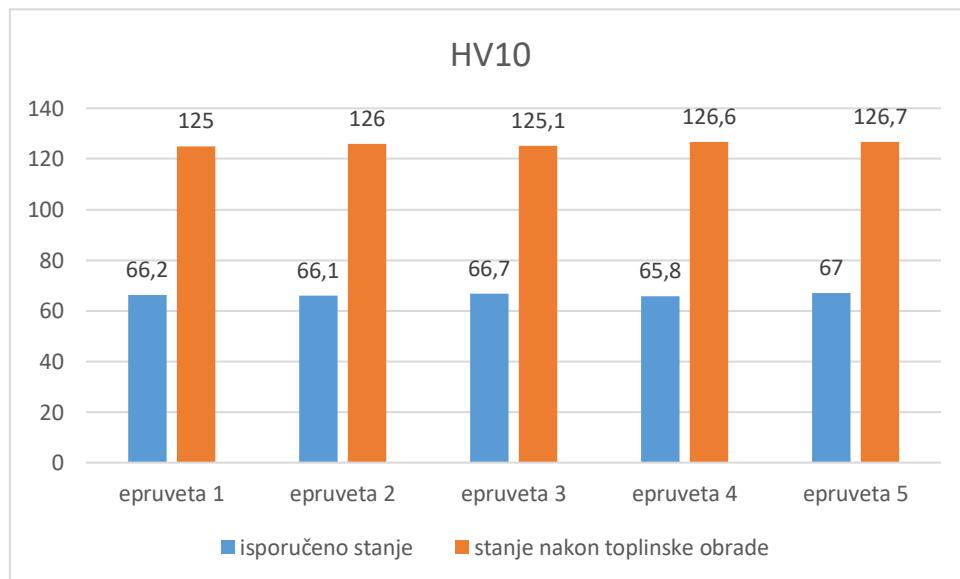
**Slika 43. Usporedba iznosa tvrdoće HV10**
