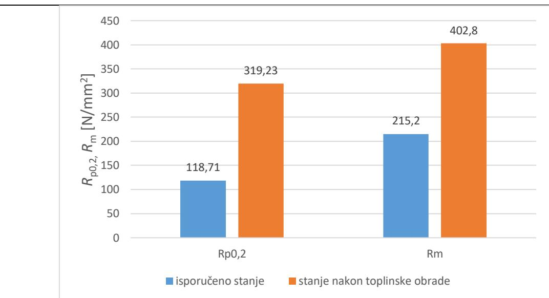
**Slika 40. Usporedba srednjih vrijednosti vlačne čvrstoće i konvencionalne granice razvlačenja**
