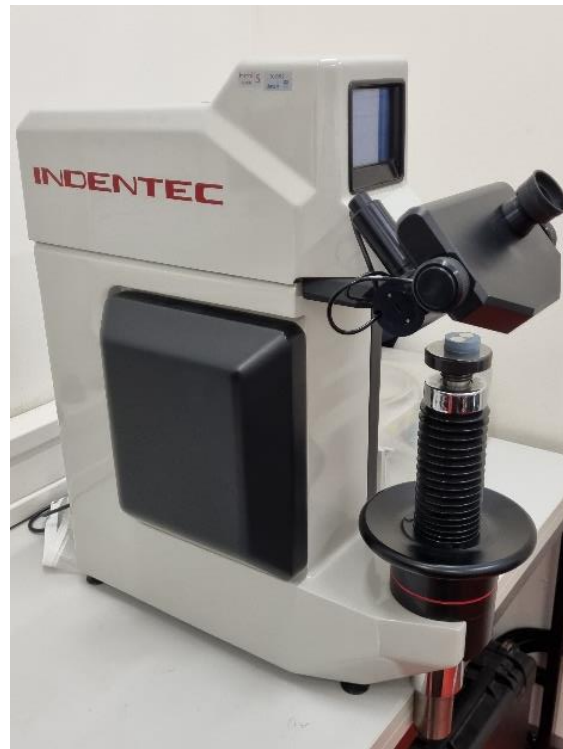
Slika 30. Tvrdomjer IDENTEC, model 5030 TKV
