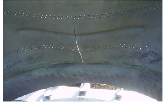
Slika 4.4 Unutarnja strana kućišta vrućih plinova, s kojeg je izrezan uzorak za ispitivanje
