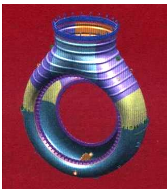
Slika 4.2 3D model kućišta vrućih plinova [8]
