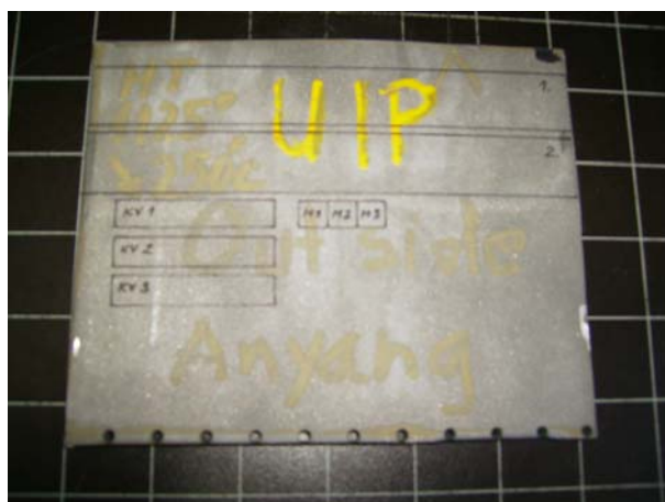
Slika 4.5 Vanjska (hladna) strana uzorka Ni-legure (Inconel 617) s označenim mjestima rezanja epruveta za mehanička ispitivanja i metalografiju.
