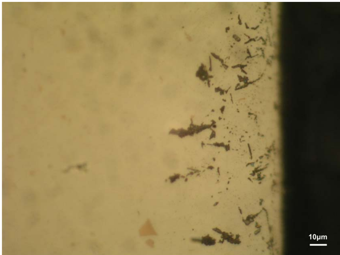
Slika 4.25 Mikrostruktura materijala u poliranom stanju uz unutarnju površinu izloženu struji vrućih plinova (veće povećanje)
