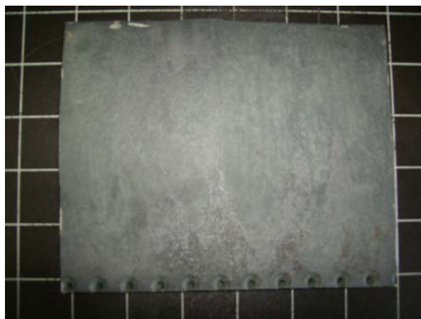
Slika 4.6 Unutarnja strana uzorka Ni-legure, koja je bila izložena visokim temperaturama i strujama plinova izgaranja
