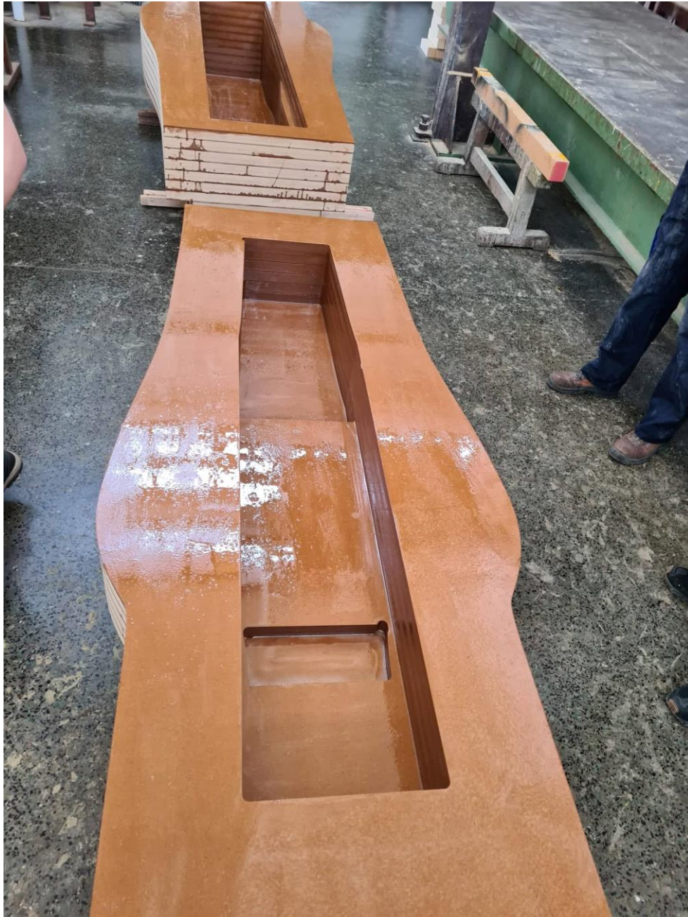
Slika 6.17. Premazivanje dna kalupa epoksidnom smolom
