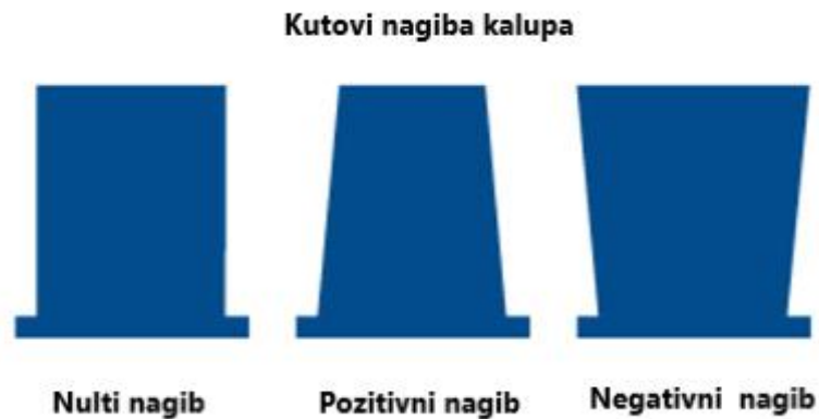
Slika 6.2. Kutovi nagiba kalupa [19]
