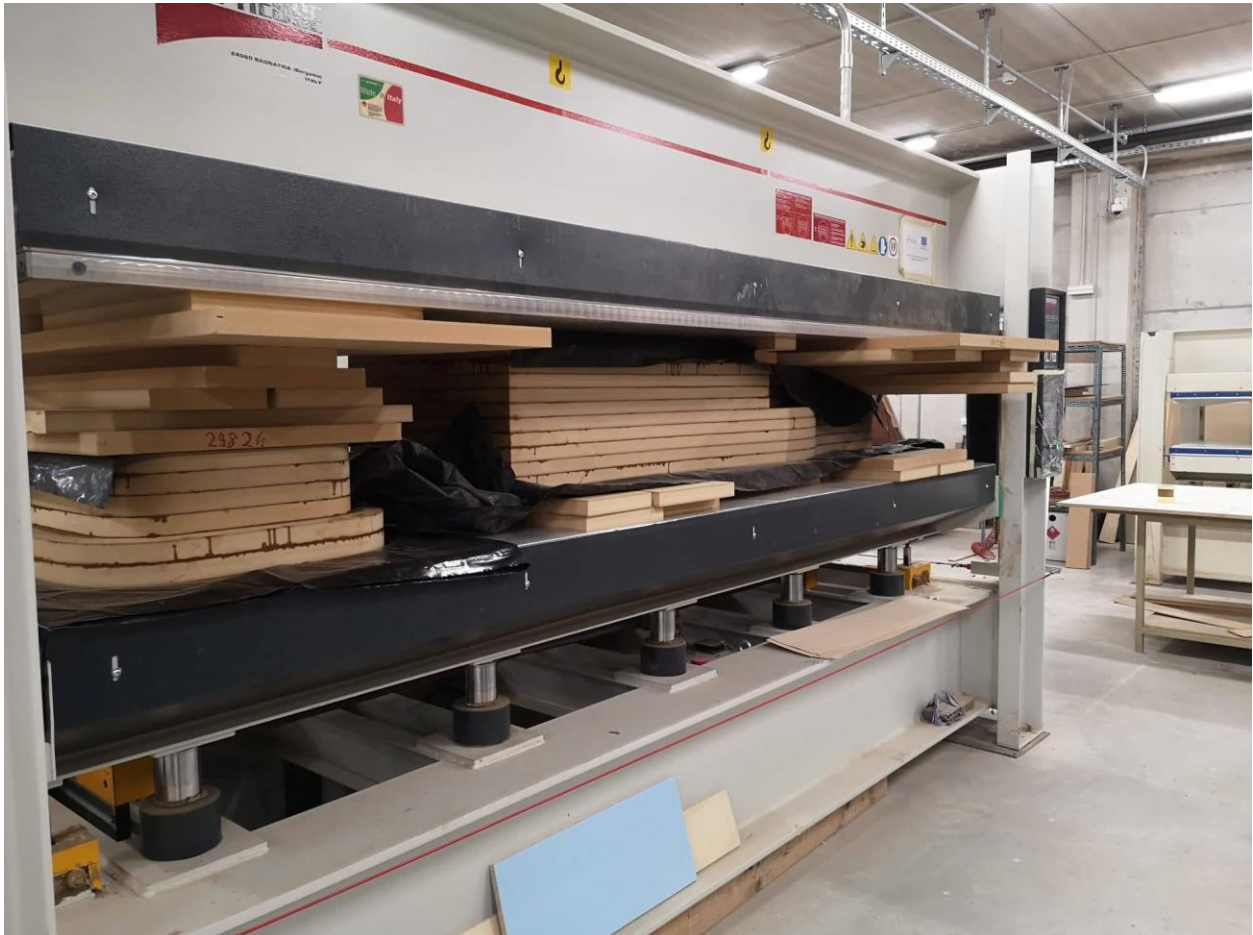
Slika 6.15. Sirovci pod hidrauličnom prešom
