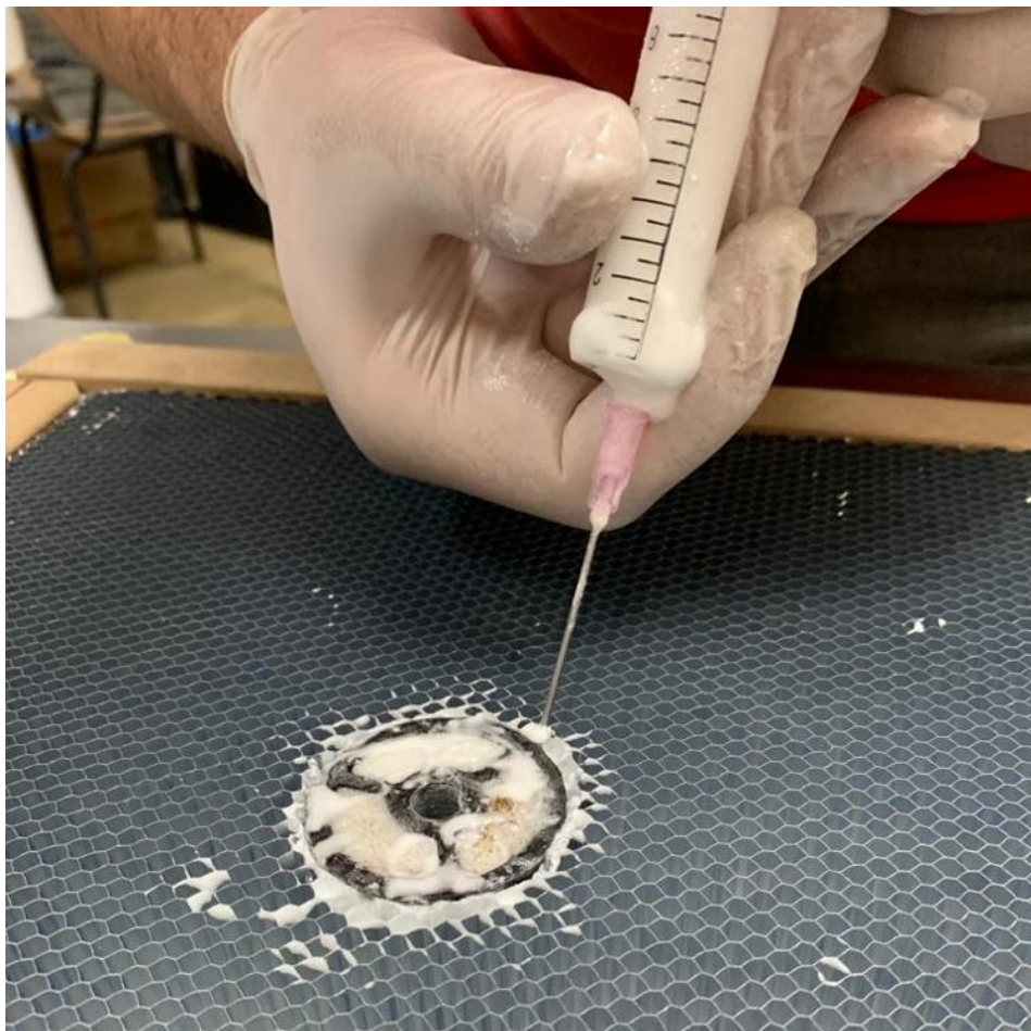
Slika 6.59. Spajanje jezgre i umetaka nanošenjem paste medicinskom injekcijom kod izrade ispitnih tijela za smično i savojno ispitivanje
