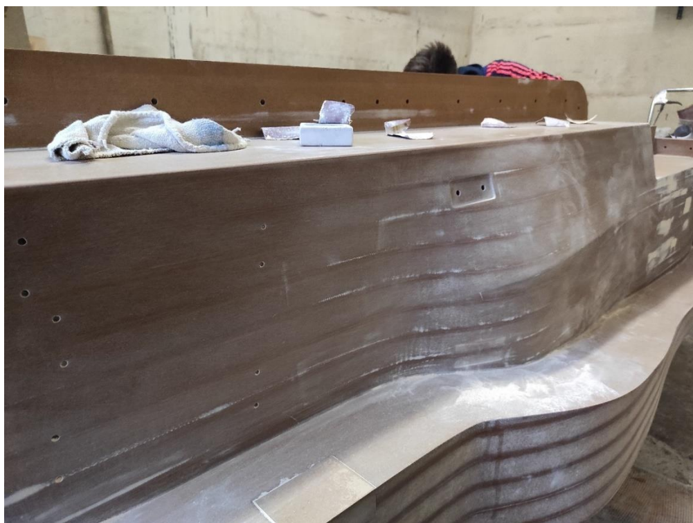
Slika 6.25 Kalup tijekom brušenja auto kita
