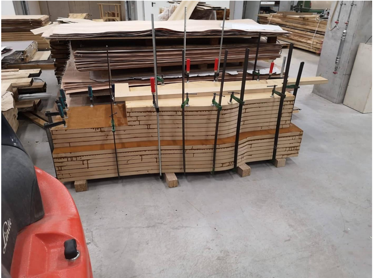
Slika 6.16. Lijepljenje donjeg kalupa iz dva komada pomoću stega
