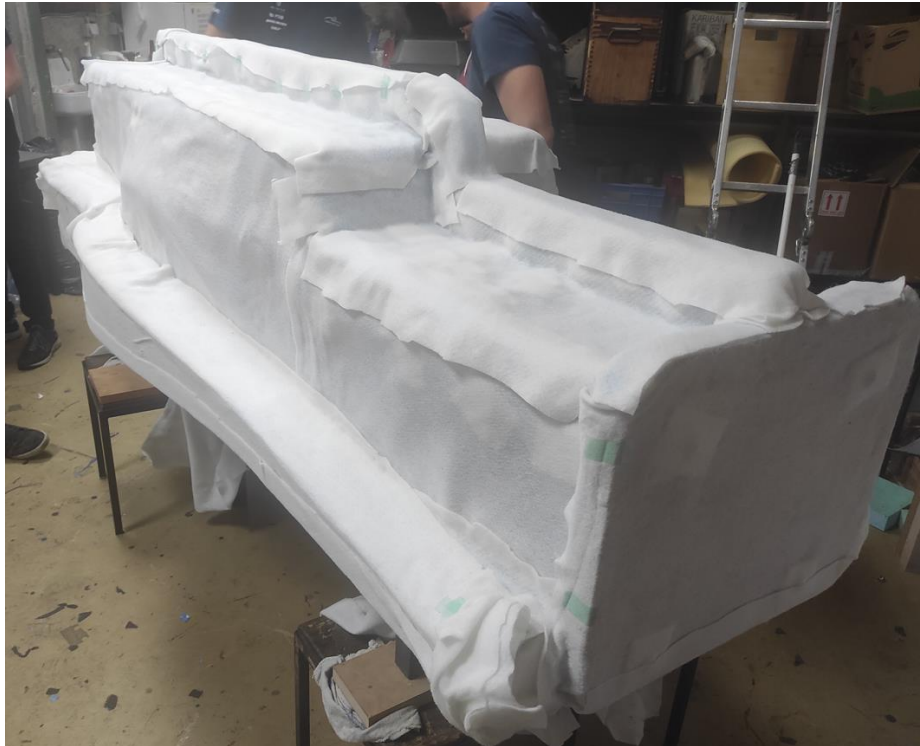
Slika 6.38. Kalup nakon postavljanja tkanine za upijanje viška smole
