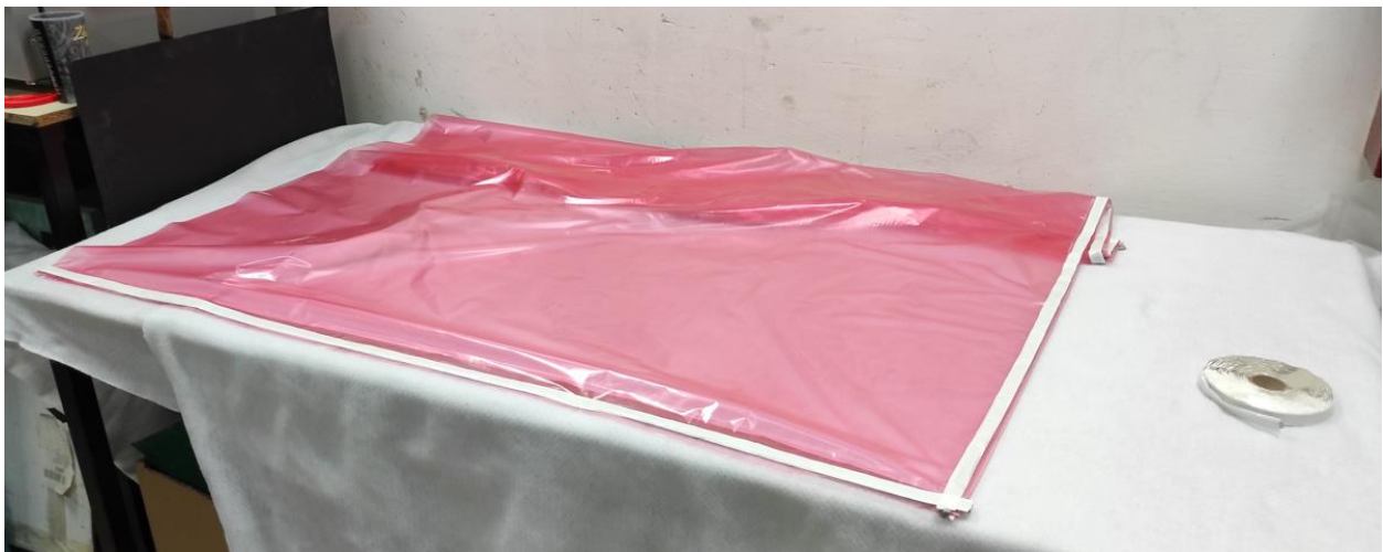
Slika 6.39. Vreća spremna za postavljanje
