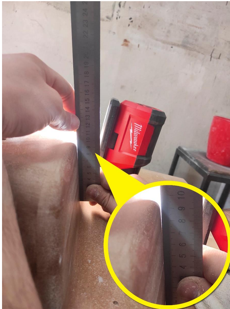
Slika 6.28. Provjera ravnosti površina: primjer neravne površine
