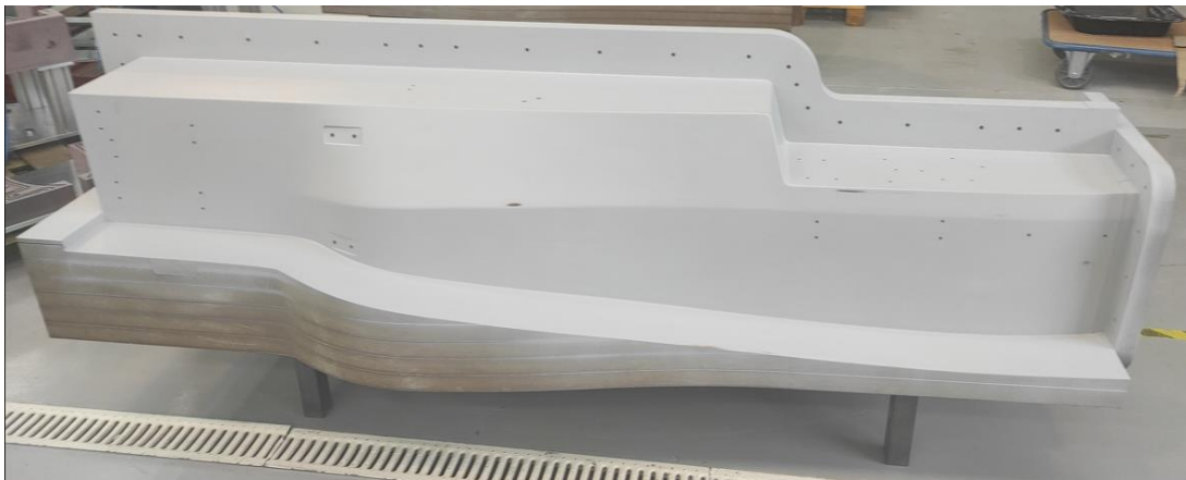
Slika 6.32. Kalup nakon završnog brušenja
