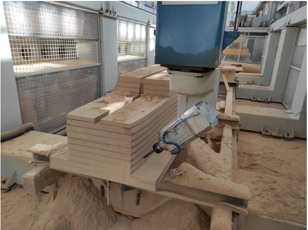
Slika 6.18. Fina obrada kalupa na petrosnom obradnom centru
