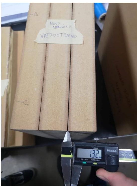
Slika 6.9. Ispitak s vatrootpornim ljepilom
