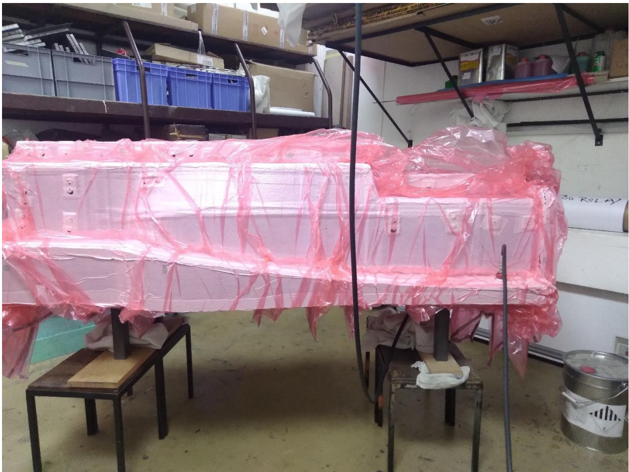
Slika 6.42. Postupak izvlačenja zraka iz poluproizvoda
