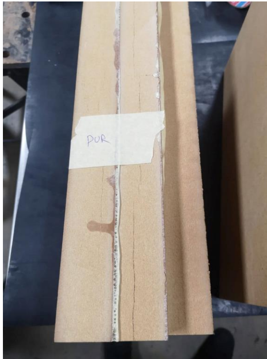
Slika 6.10. Ispitak s poliuretanskom pjenom kao ljepljom
