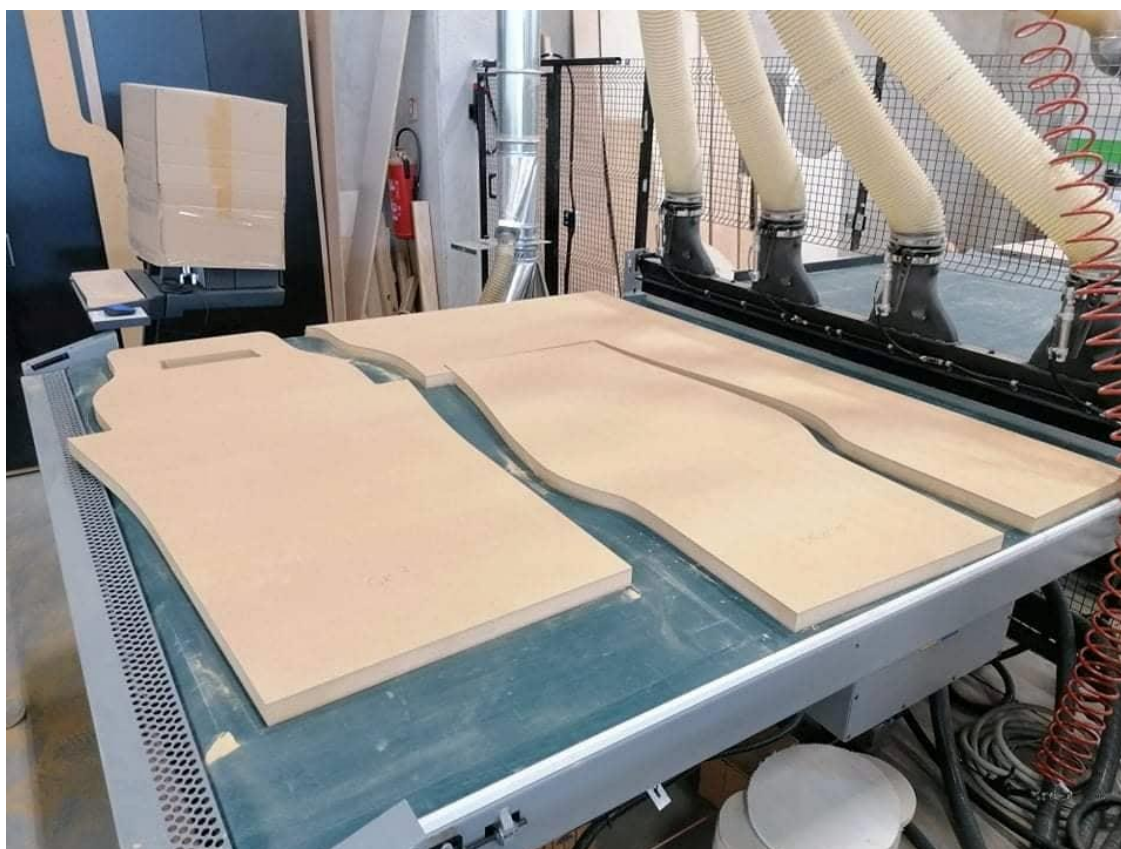
Slika 6.13. Sirovci tijekom rezanja na stolu obradnog stroja
