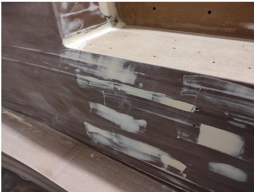
Slika 6.24. Kalup nakon nanošenja auto kita
