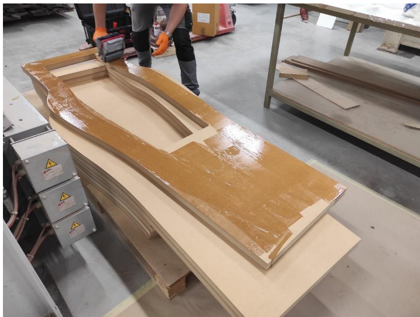
Slika 6.14. Premazivanje ploča smolom pomoću mazalice za lijepilo
