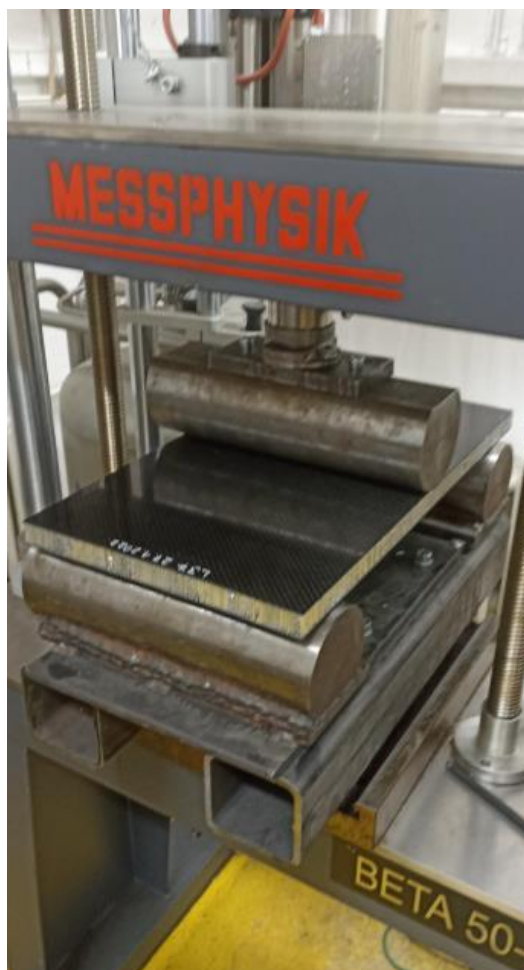
Slika 6.51. ispitivanje ispitnog tijela savijanjem u tri točke
