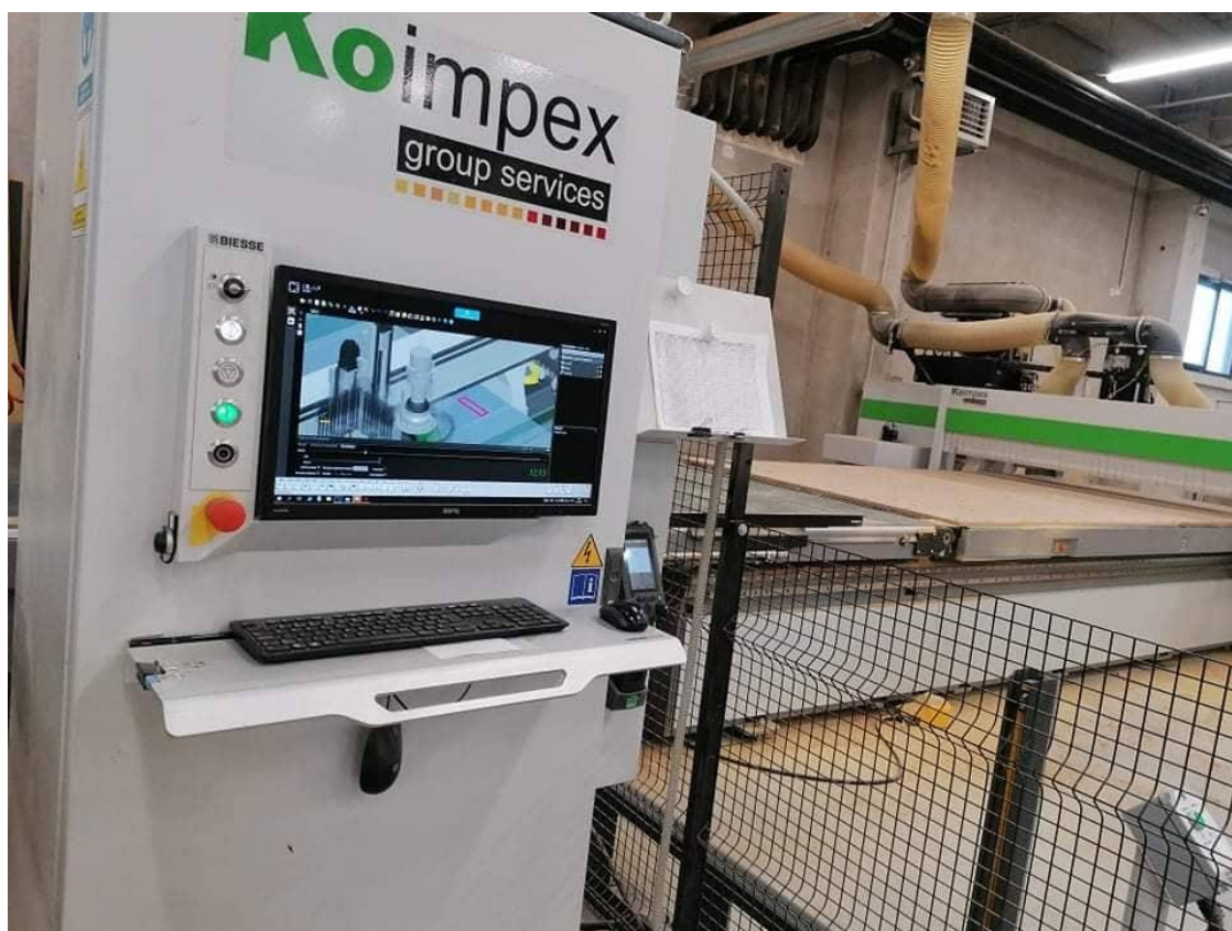
Slika 6.12. Obradni stroj za rezanje drva
