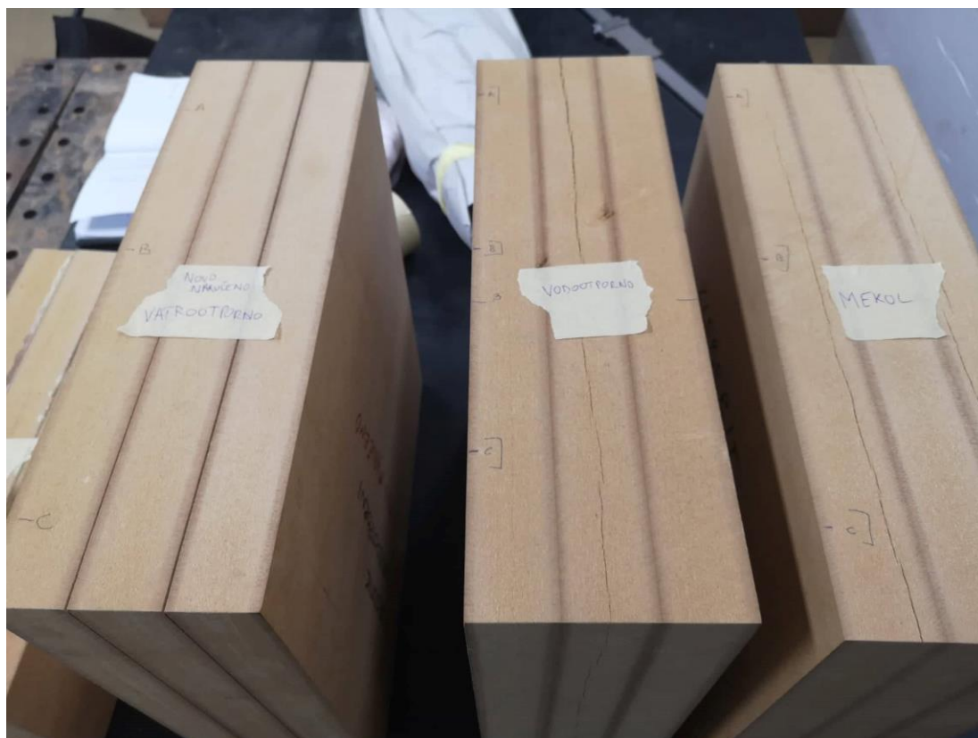
Slika 6.8. Ispitni uzorci nakon ispitivanja: a) vatrootporno adhezivno sredstvo, b) vodootporno adhezivno sredstvo, c) adhezivno sredstvo za drvo
