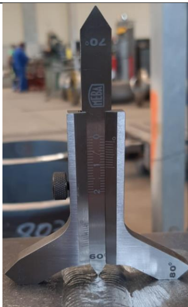
Slika 53. Nadvišenje zavarenog spoja epruvete U-1
