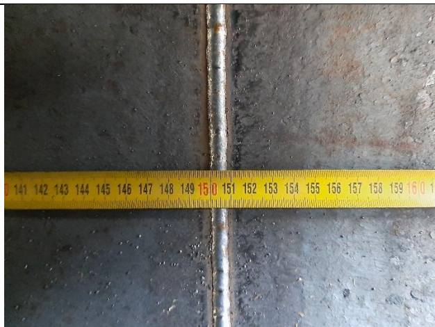
Slika 43. Korijen epruvete V-1
