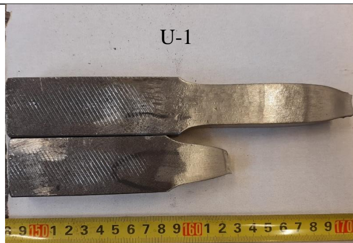
Slika 68. Uzorak epruvete U-1 nakon statičko vlačnog ispitivanja
