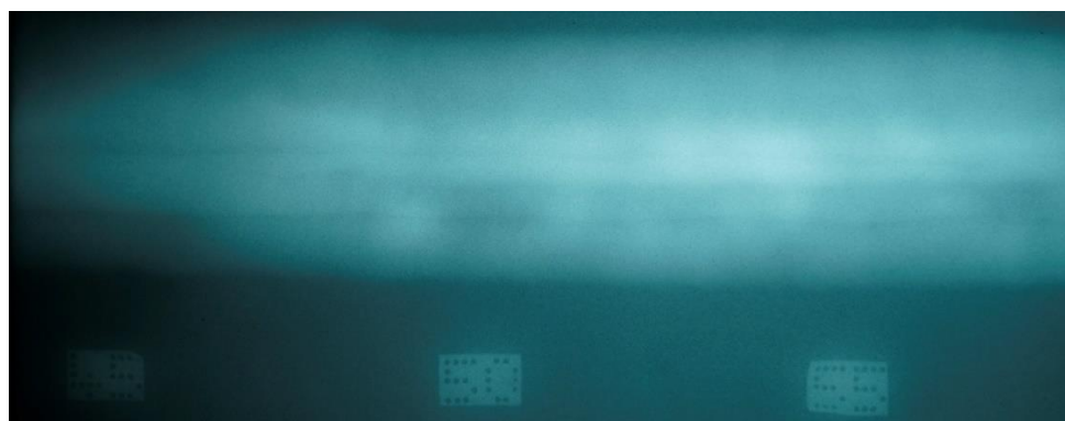
Slika 55. Radiogram zavarenog spoja epruvete V-1 (s indikacijama: izolirani uključak troske 47 - 49)
