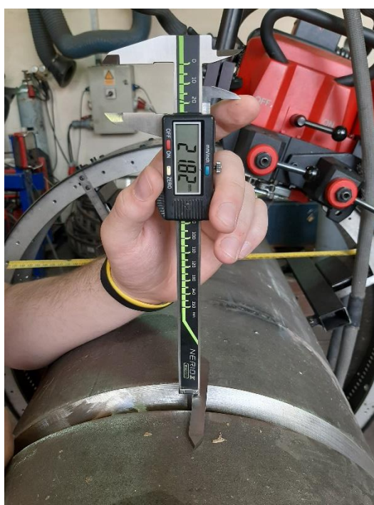
Slika 44. Dubina žlijeba nakon zavarivanja korijena epruvete V-1
