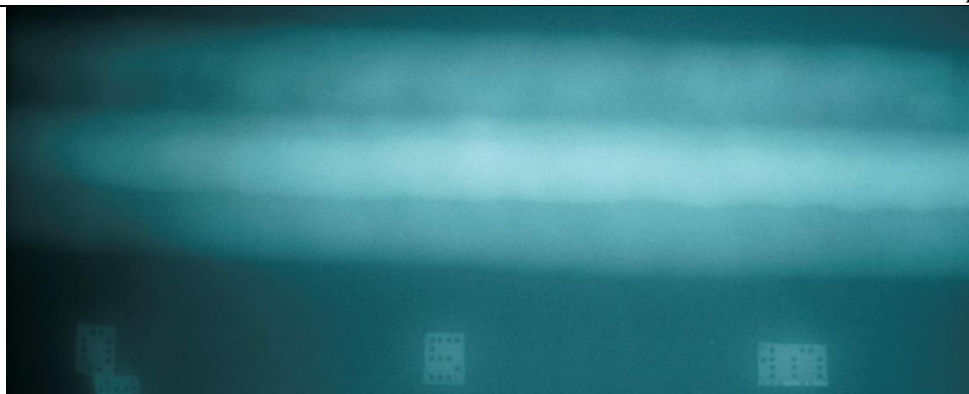
Slika 54. Radiogram zavarenog spoja epruvete V-1 (bez indikacija)
