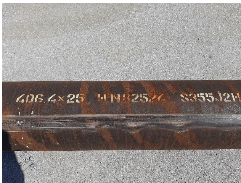
Slika 29. Bešavna cijev od materijala S355J2H
