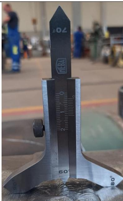
**Slika 46. Nadvišenje zavarenoga spoja epruvete V-1**
