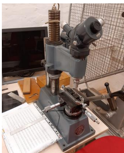
Slika 61. Tvrdomjer Reichter TM12
