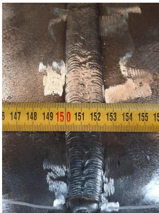
Slika 52. Lice zavarenog spoja epruvete U-1
