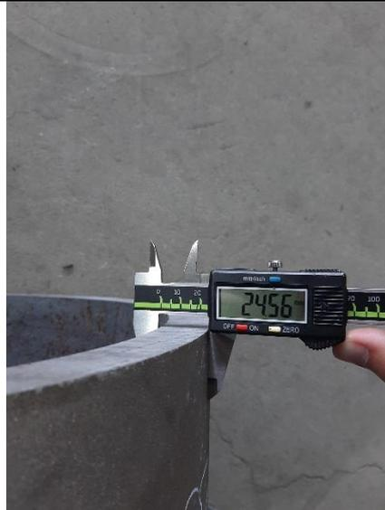
**Slika 32. Debljina (24,56 mm) polovice epruvete**
