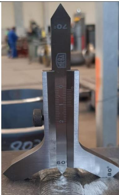
**Slika 53. Nadvišenje zavarenog spoja epruvete U-1**
