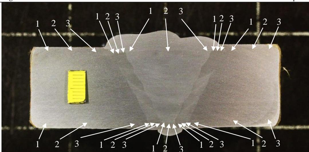
Slika 62. Shema mjerenja tvrdoće na uzorku V-1
