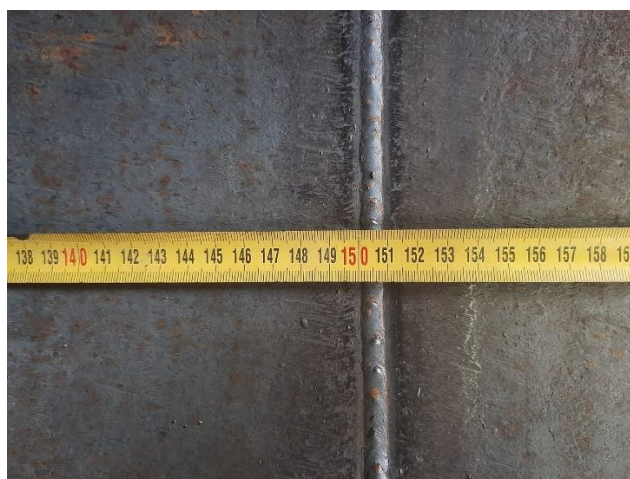
Slika 50. Korijen epruvete U-1
