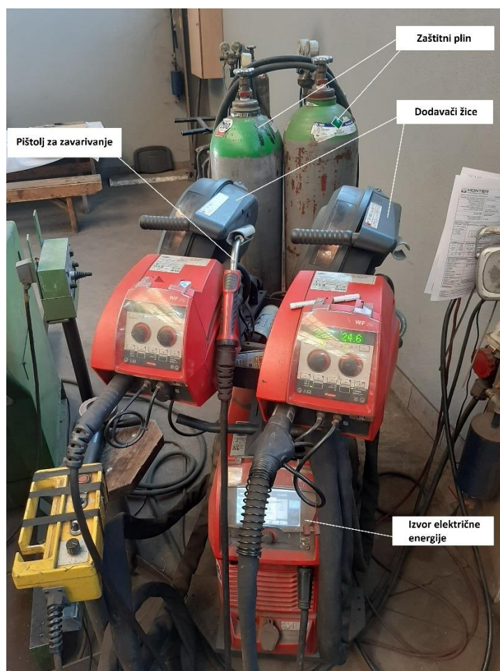
Slika 36. Stroj za zavarivanje Fronius TPS 400i PULSE
