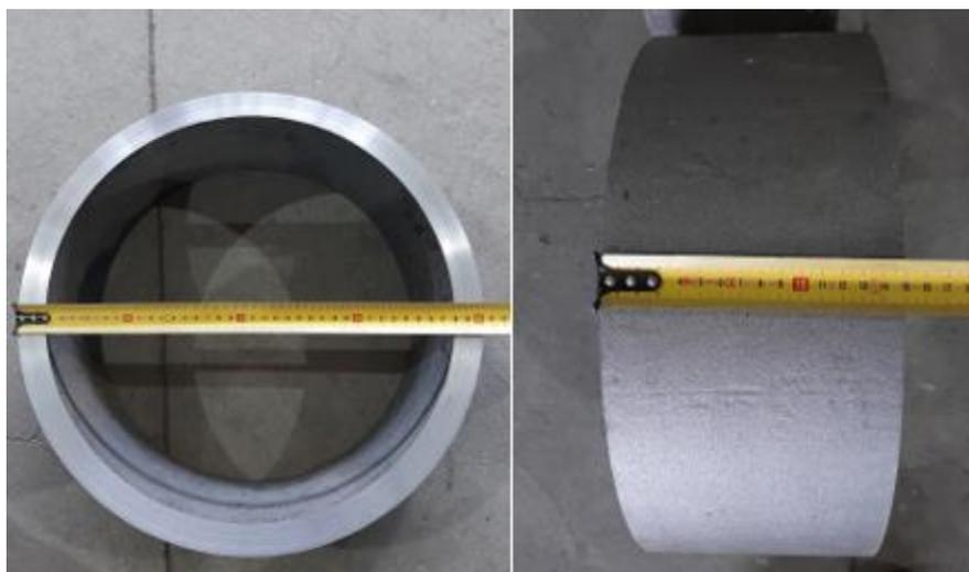
**Slika 31. Promjer (406,4 mm) i duljina (150 mm) polovice epruvete**
