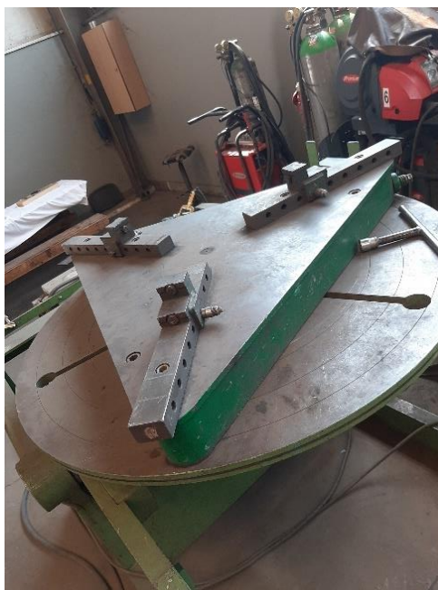
Slika 38. Stezna glava za prihvat epruveti
