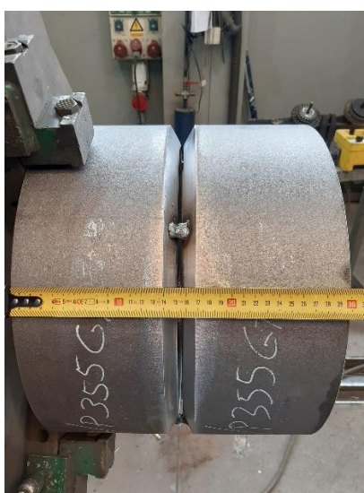
Slika 41. Epruveta V-1 prije zavarivanja
