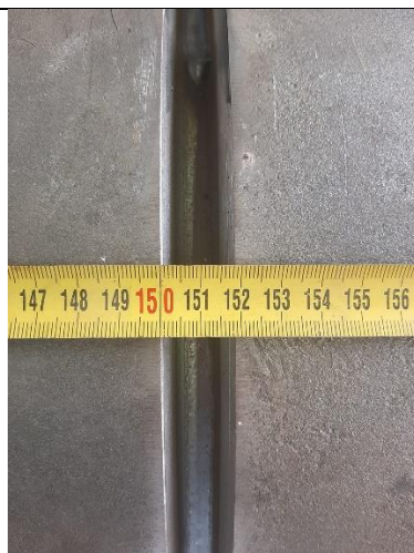
Slika 49. Lice korijena epruvete U-1
