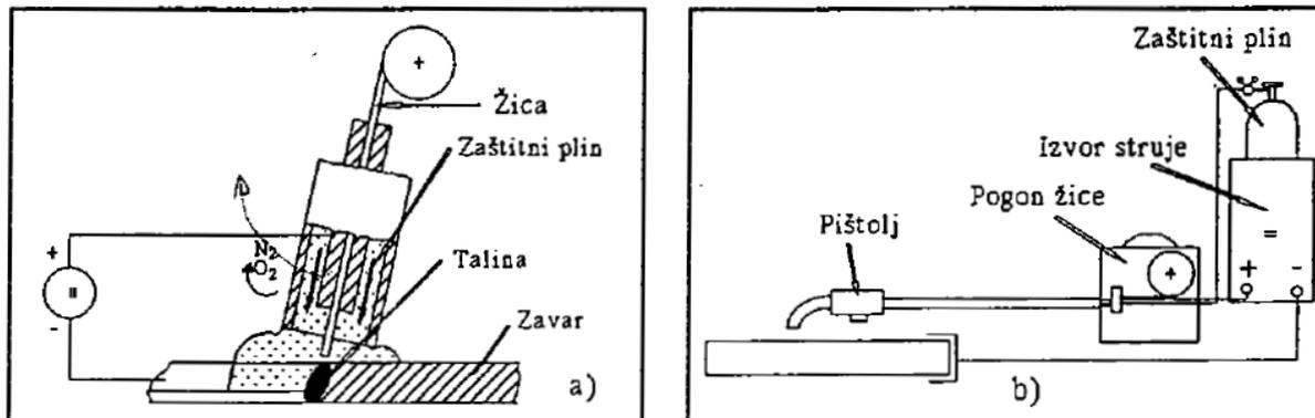
Slika 4. Shematski prikaz procesa (a) i uređaja (b) [4]
