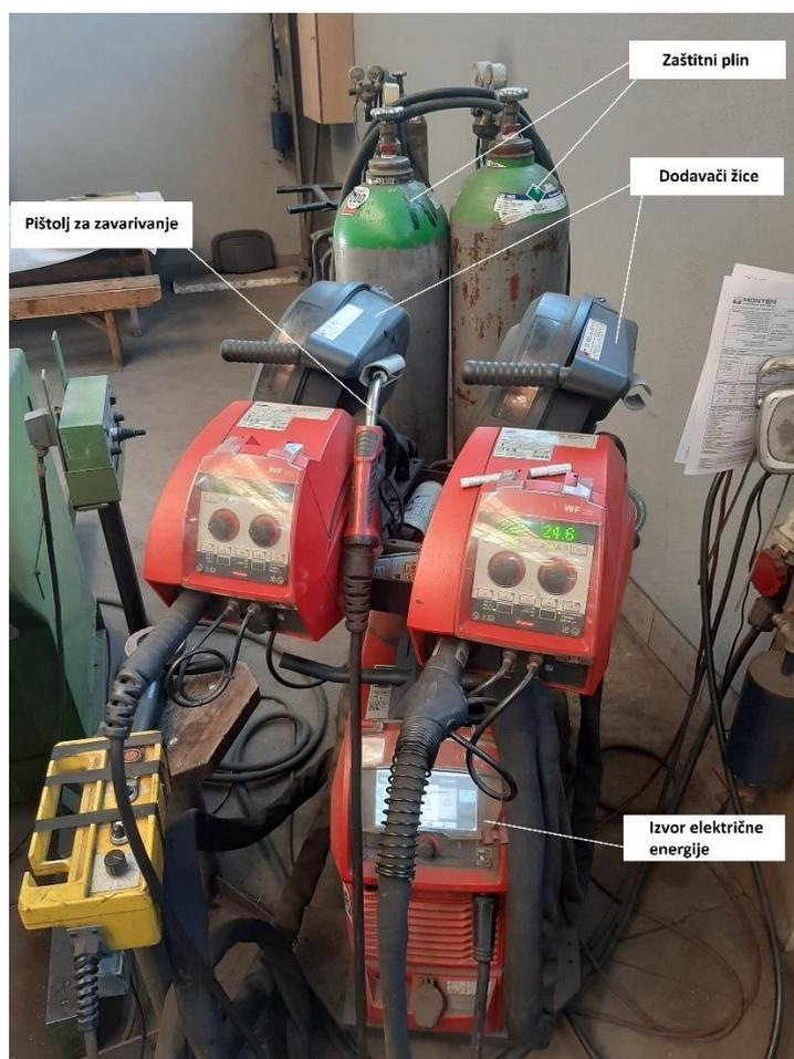
Slika 36. Stroj za zavarivanje *Fronius TPS 400i PULSE*
