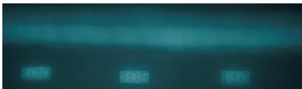
**Slika 56. Radiogram zavarenog spoja epruvete U-1 (bez indikacija)**
