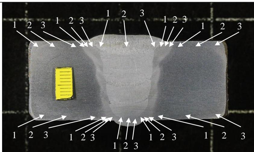
Slika 64. Shema mjerenja tvrdoće na uzorku U-1
