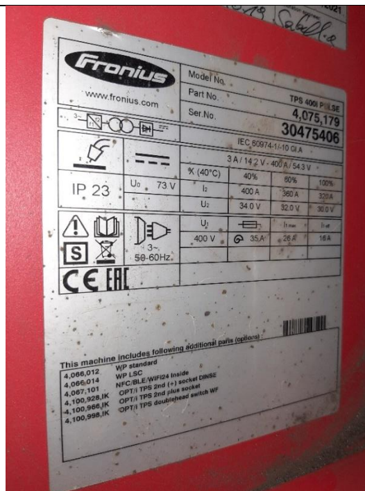
Slika 37. Specifikacijska pločica Fronius TPS 400i PULSE
