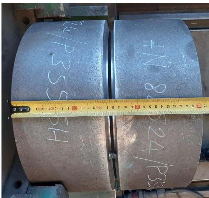
**Slika 48. Epruveta U-1 prije zavarivanja**
