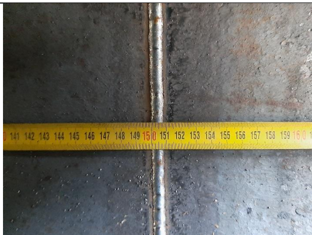
Slika 43. Korijen epruvete V-1
