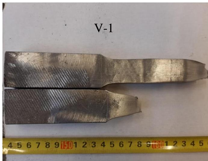
Slika 67. Uzorak epruvete V-1 nakon statičko vlačnog ispitivanja
