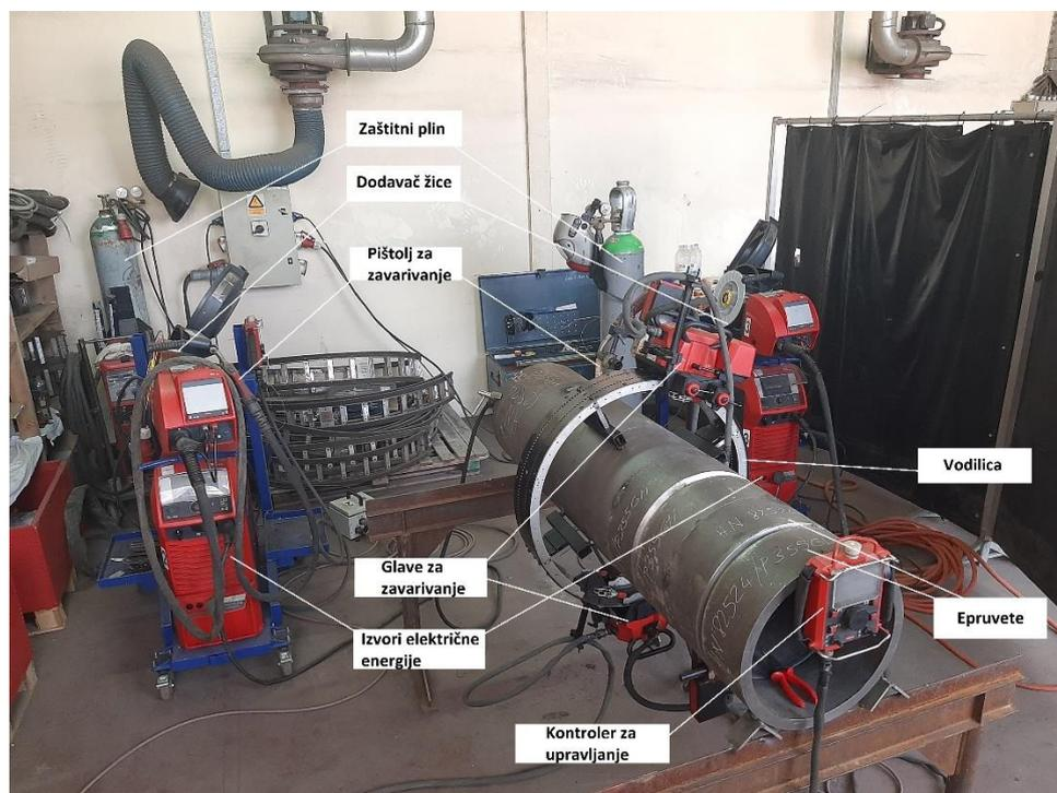
Slika 39. Stroj za automatsko zavarivanje *Fronius TPS 400i*
