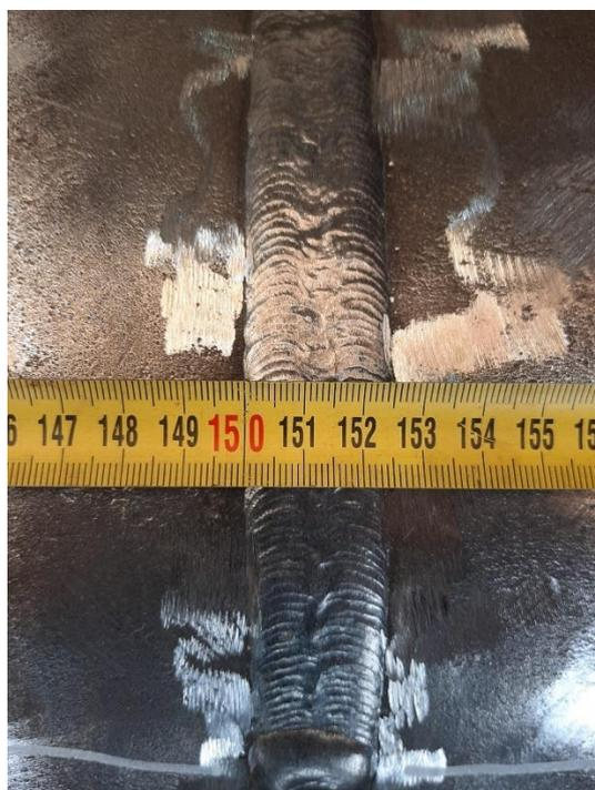
**Slika 52. Lice zavarenog spoja epruvete U-1**
