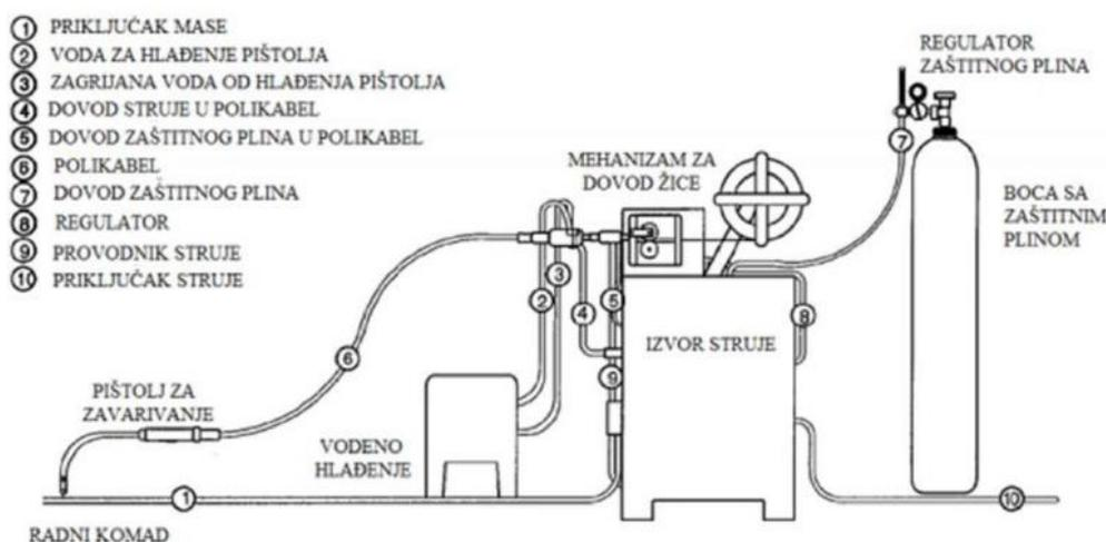
Slika 9. Osnovna oprema za MAG postupak zavarivanja [4]
