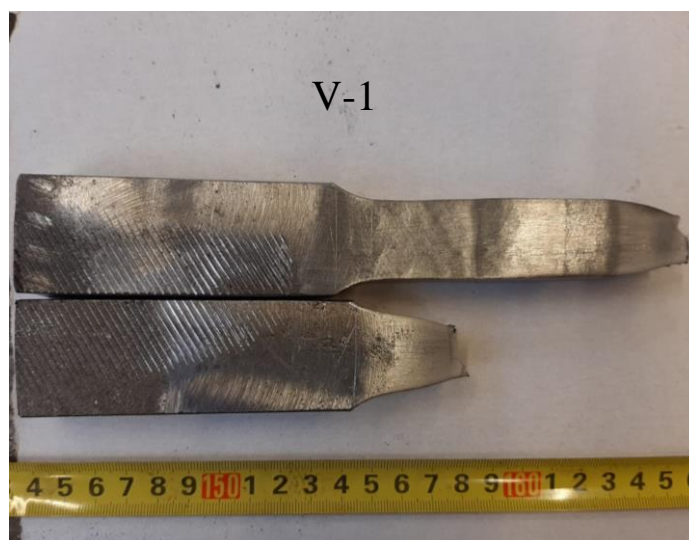
Slika 67. Uzorak epruvete V-1 nakon statičko vlačnog ispitivanja
