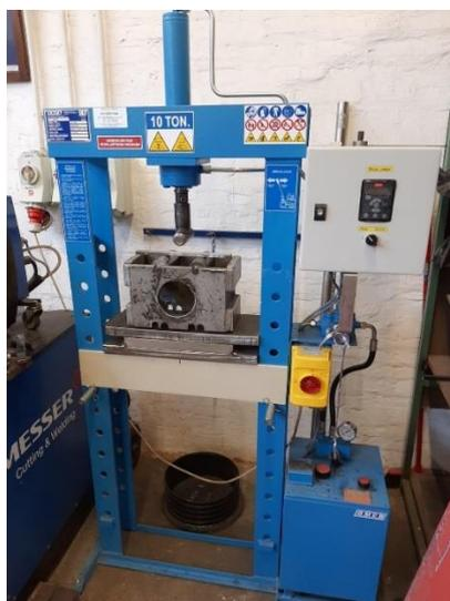
Slika 71. Hidraulična preša za savijanje uzoraka
