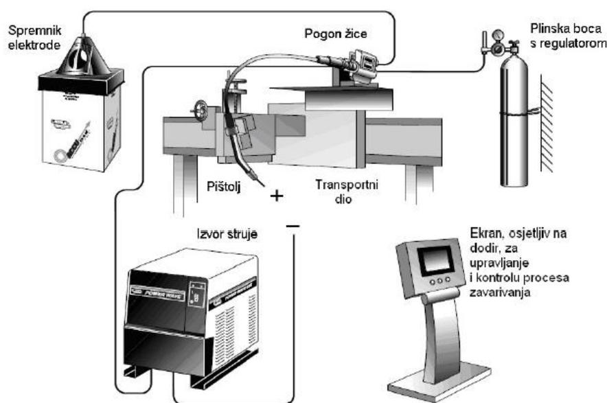
**Slika 10. Automatski MAG sustav za zavarivanje [7]**
