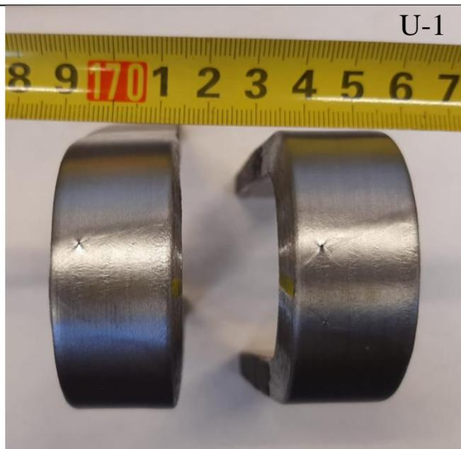
**Slika 73. Uzorci epruvete U-1 nakon ispitivanja bočnoga savijanja**
