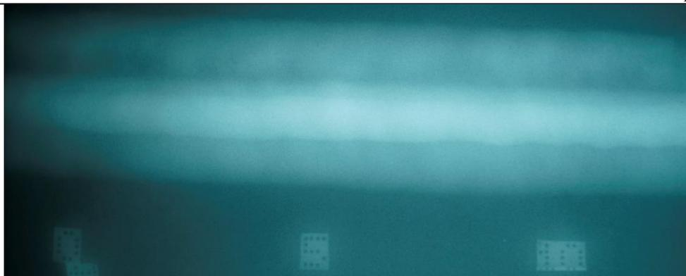
**Slika 54. Radiogram zavarenog spoja epruvete V-1 (bez indikacija)**
