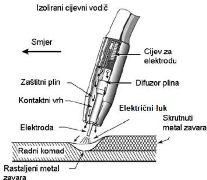
Slika 11. Presjek pištolja u radu kod MAG zavarivanja [7]
