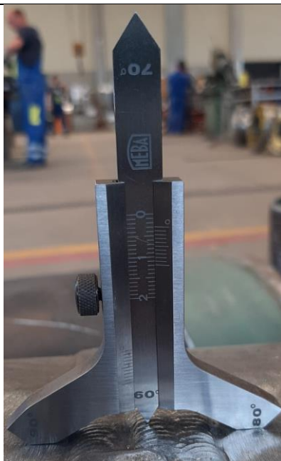
Slika 46. Nadvišenje zavarenoga spoja epruvete V-1
