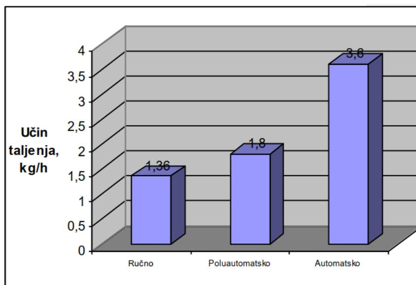
**Slika 2. Usporedba učina pri ručnom, poluautomatskom i automatskom zavarivanju [2]**
