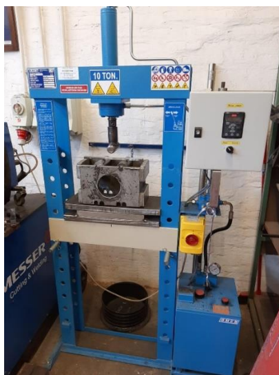
Slika 71. Hidraulična preša za savijanje uzoraka
