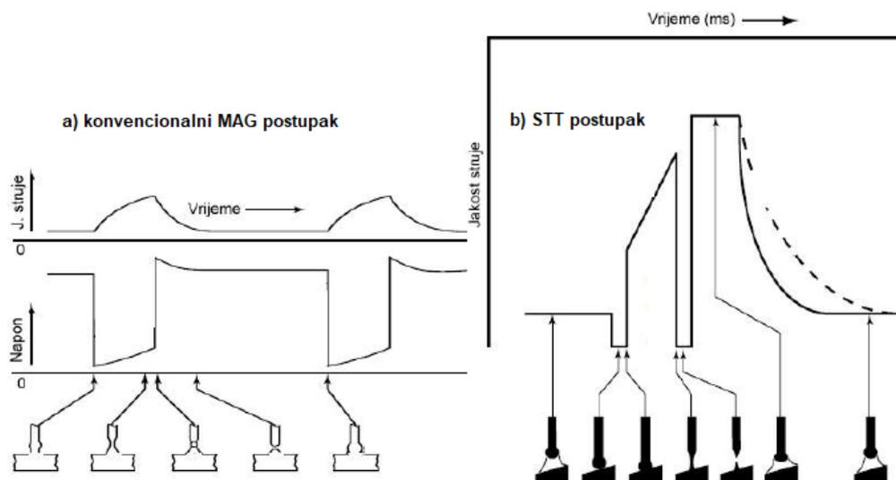
**Slika 20. Prikaz dinamičke karakteristike izvora struje [3]**
