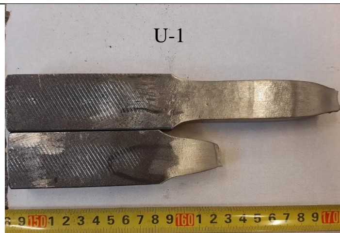
Slika 68. Uzorak epruvete U-1 nakon statičko vlačnog ispitivanja
