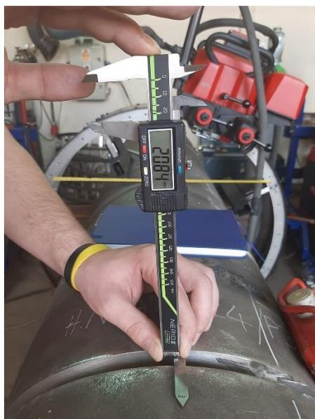
**Slika 51. Dubina žlijeba nakon zavarivanja korijena epruvete U-1**
