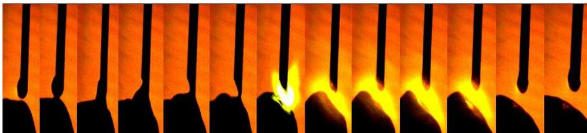
**Slika 24. Slijed odvajanja kapljice kod FastROOT postupka zavarivanja [2]**
