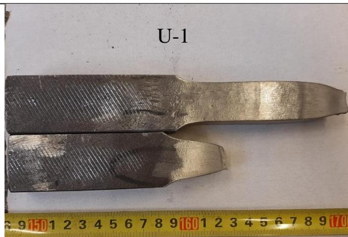
**Slika 68. Uzorak epruvete U-1 nakon statičko vlačnog ispitivanja**
