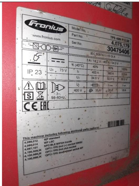
Slika 37. Specifikacijska pločica *Fronius TPS 400i PULSE*
