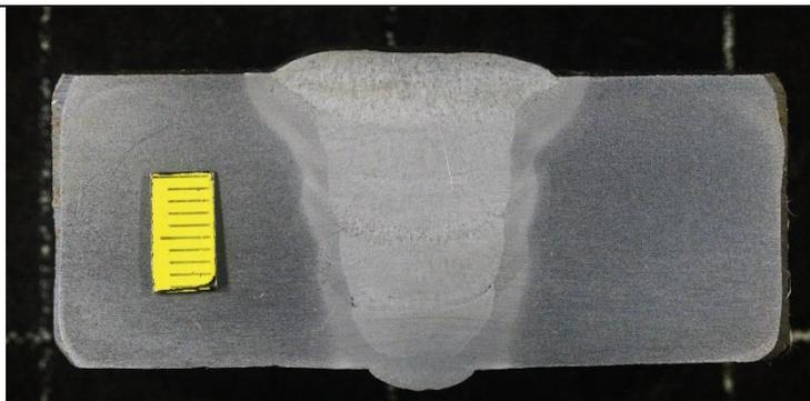
**Slika 60. Makroizbrusak epruvete U-1**
