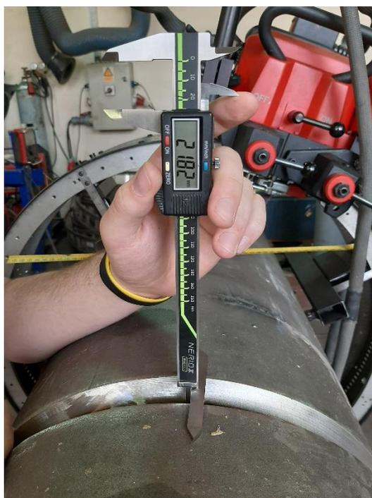
**Slika 44. Dubina žlijeba nakon zavarivanja korijena epruvete V-1**
