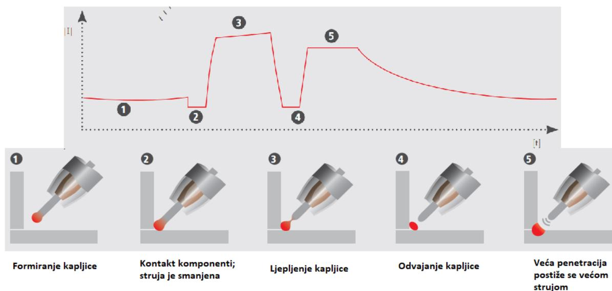
Slika 26. LSC kratki električni luk [11]
