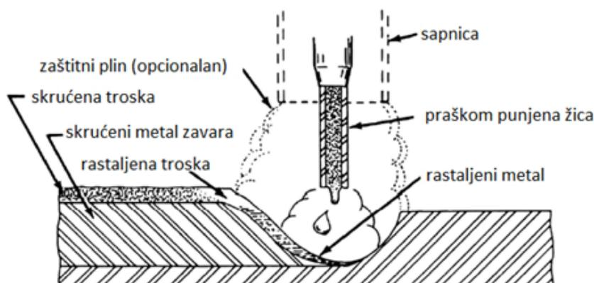
**Slika 28. Shematski prikaz FCAW postupka [14]**
