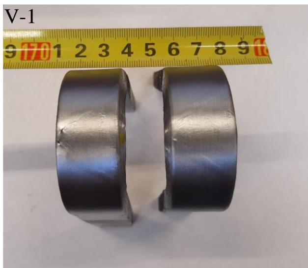
Slika 72. Uzorci epruvete V-1 nakon ispitivanja bočnoga savijanja
