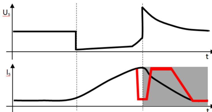
**Slika 17. Oscilogram *pipeSolution* postupka zavarivanja [8]**
