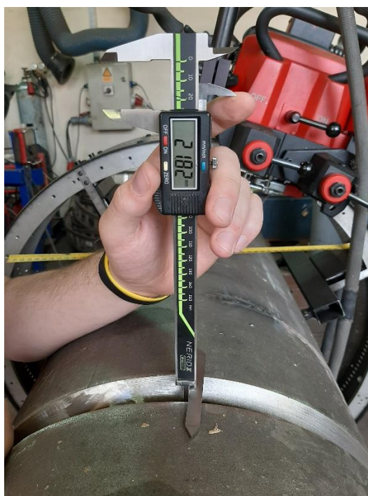
Slika 44. Dubina žlijeba nakon zavarivanja korijena epruvete V-1
