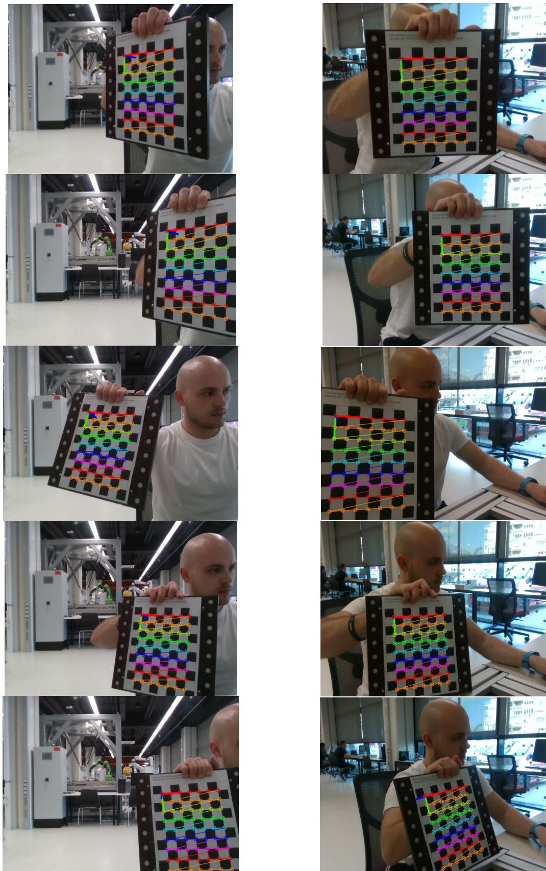
Slika 34. Primjer slika uzetih za stereo kalibraciju
