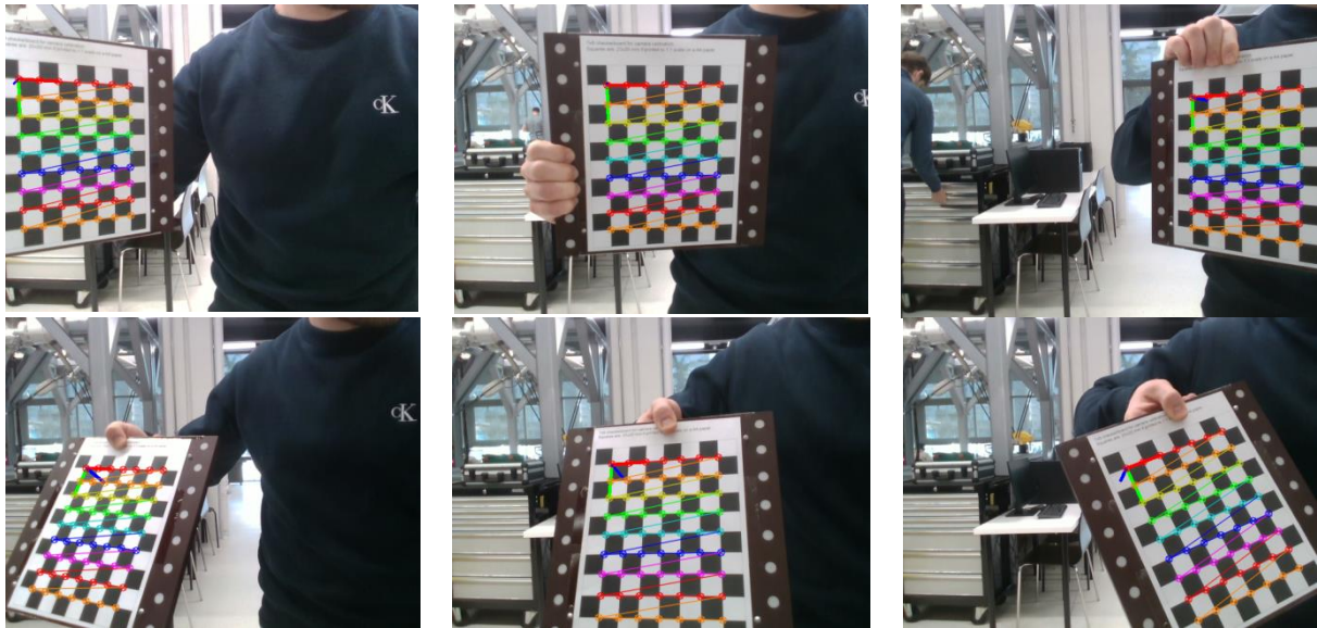
Slika 27. Fotografije uzete za kalibraciju jedne kamere
