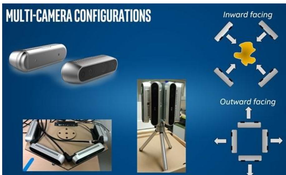
Slika 9. Neke konfiguracije Intel-ovih kamera [5]
