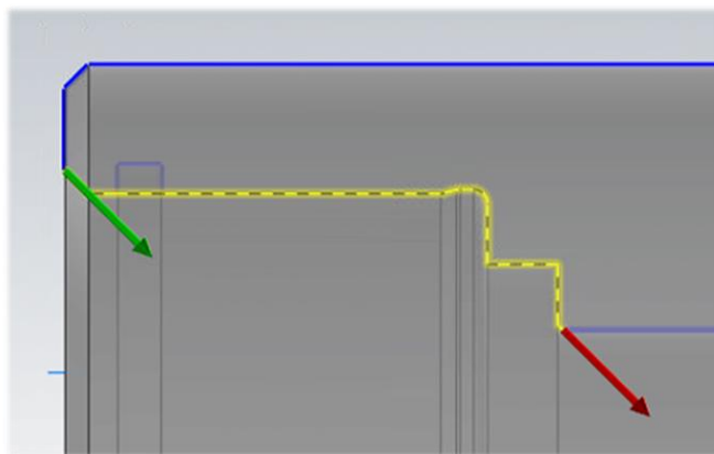
Slika 136. Fino tokarenje obratka – unutarne: definiranje konture
