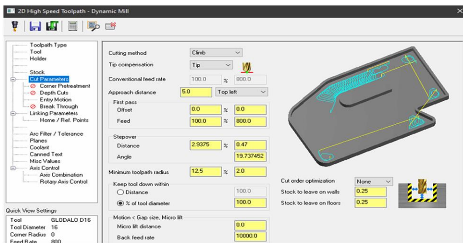
Slika 70. Glodanje promjera \phi 65 mm – gruba obrada: definiranje parametara obrade
