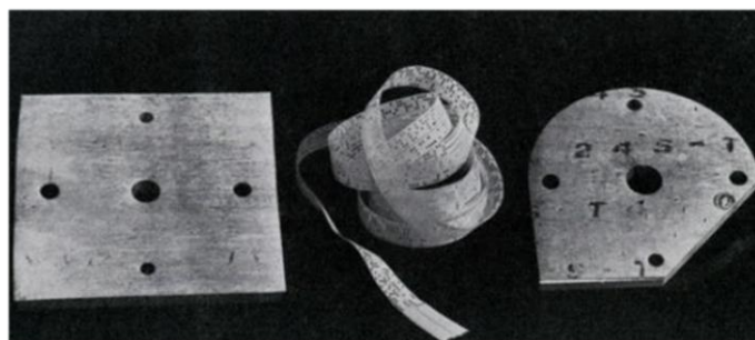
Slika 4. Pripremak (lijevo), bušena vrpča (sredina), izradak (desno) [3]
