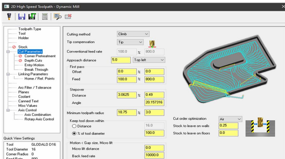
Slika 115. Glodanje promjera \phi 120 mm – gruba obrada: definiranje parametara obrade
