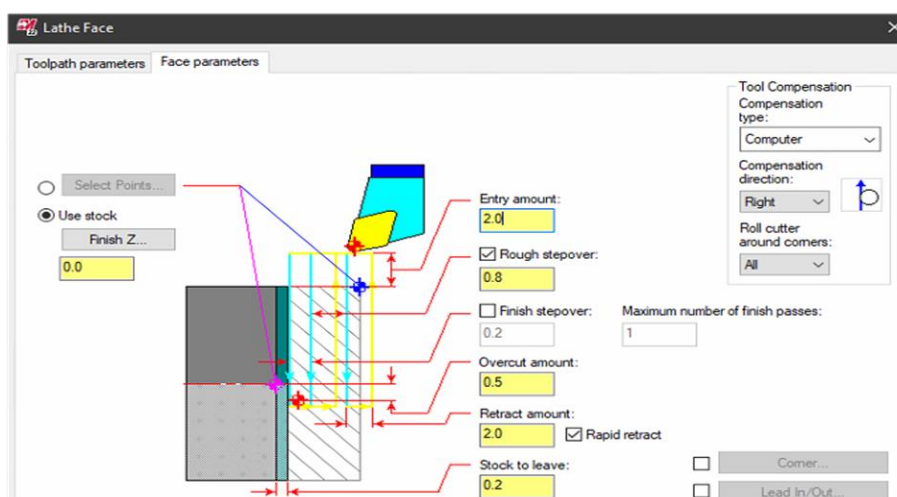
Slika 99. Poravnavanje čela obratka: definiranje parametara obrade
