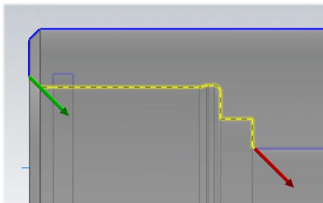
Slika 136. Fino tokarenje obratka – unutarne: definiranje konture
