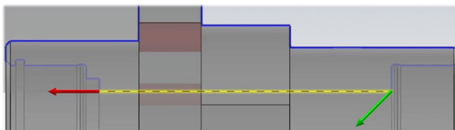
Slika 52. „Fino“ tokarenje provrta \phi 35 mm: definiranje konture
