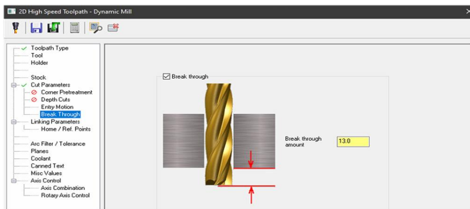
Slika 116. Glodanje promjera \phi 120 mm – gruba obrada: definiranje položaja glodala
