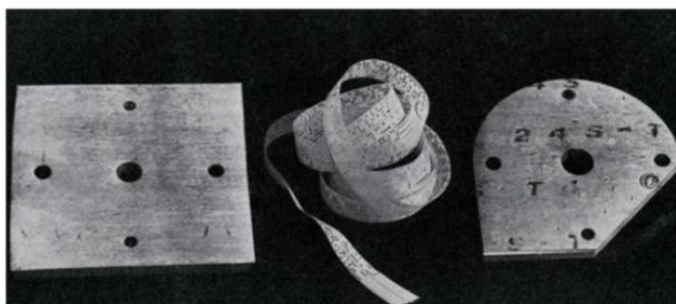
Slika 4. Pripremak (lijevo), bušena vrpca (sredina), izradak (desno) [3]
