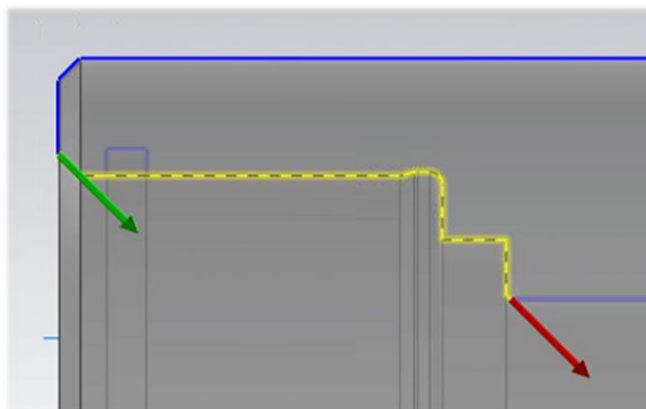
Slika 136. Fino tokarenje obratka – unutarne: definiranje konture
