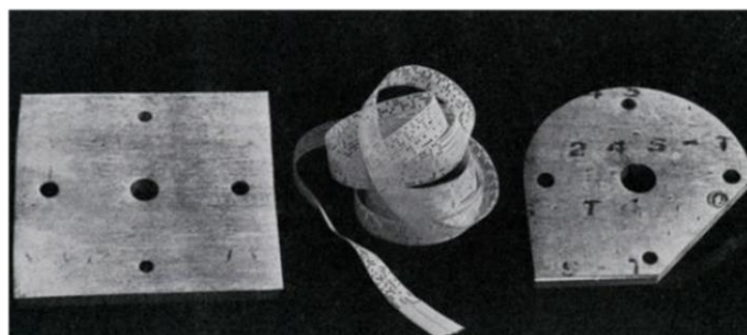
Slika 4. Pripremak (lijevo), bušena vrpca (sredina), izradak (desno) [3]
