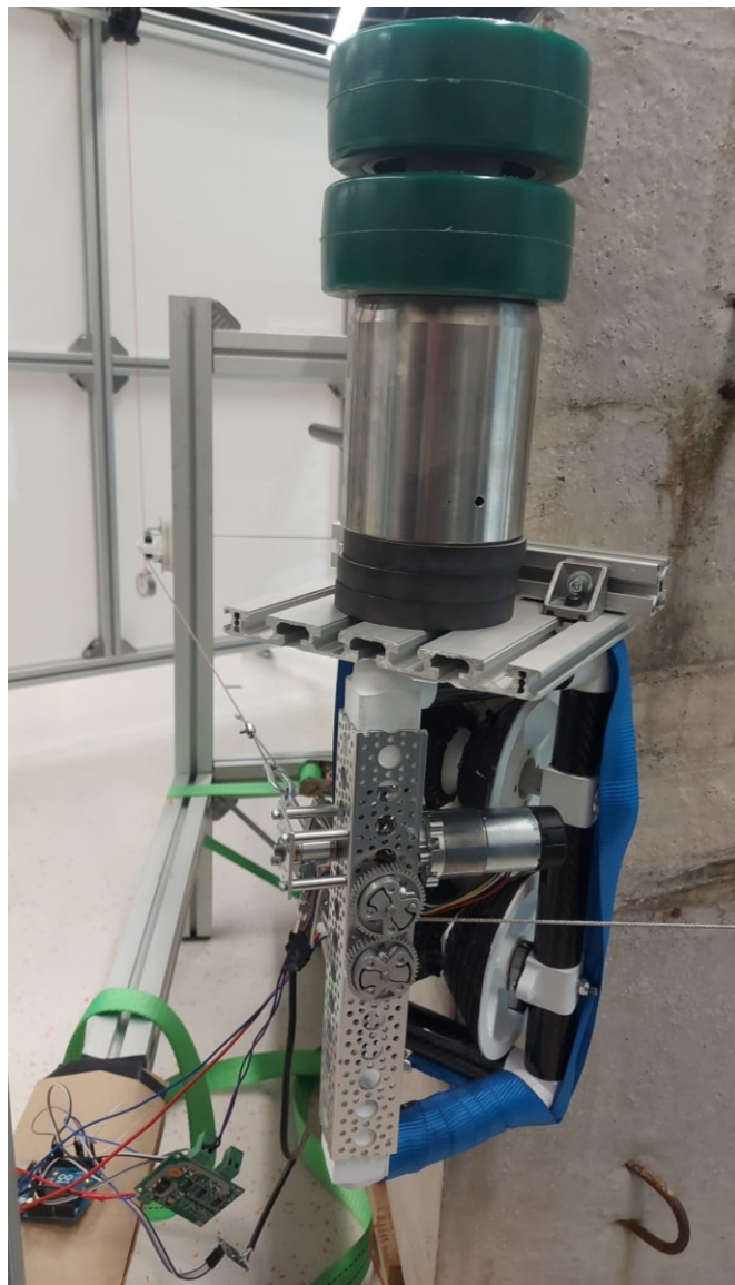
Slika 36. Testiranje nosivosti robota
