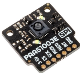
Slika 9. Optički senzor pomaka PAA5100JE[]
