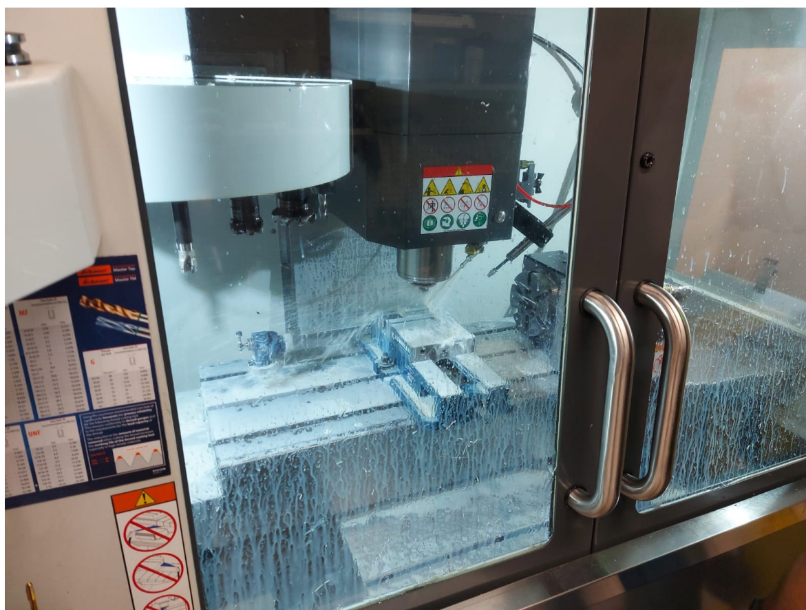
Slika 37. Izrada nosača motora na CNC stroju
