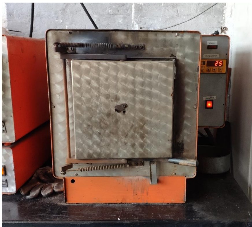
Slika 26. Komorna peć za žarenje
