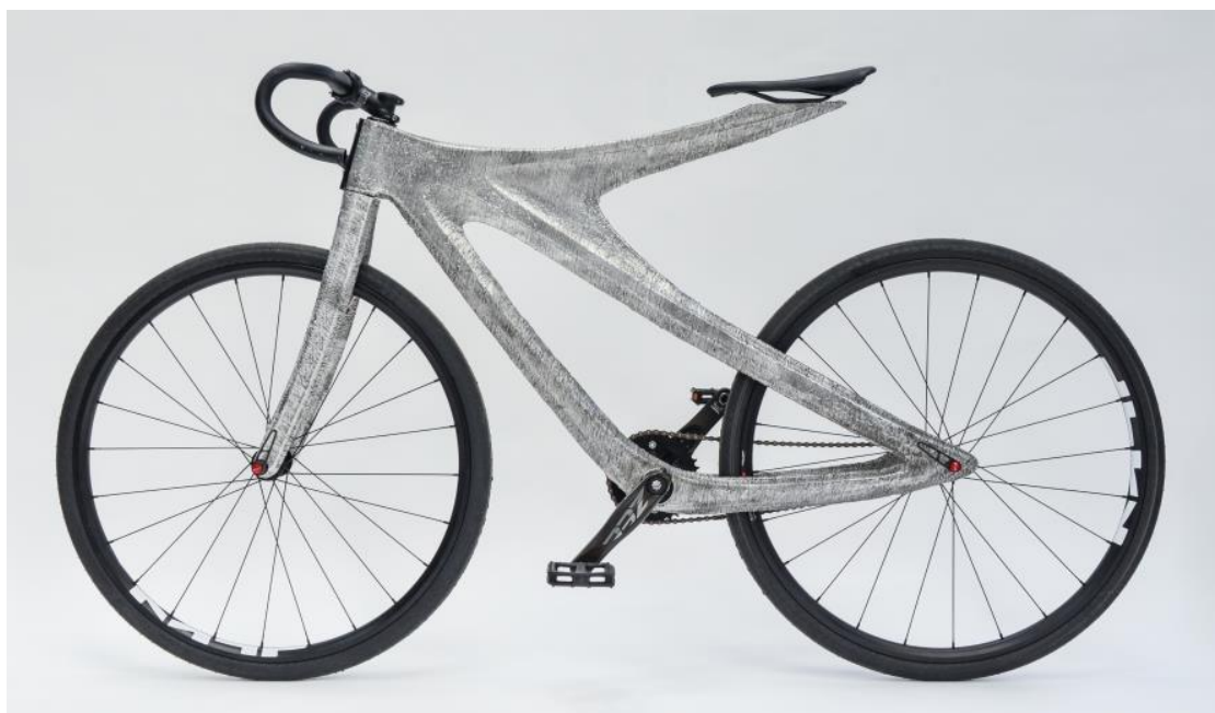
Slika 16. Aluminijski bicikl proizveden WAAM postupkom [15]
