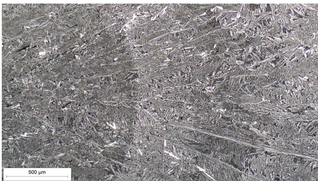
Slika 31. Mikrostruktura toplinski obrađenog uzorka snimljena pri povećanju 50\times
