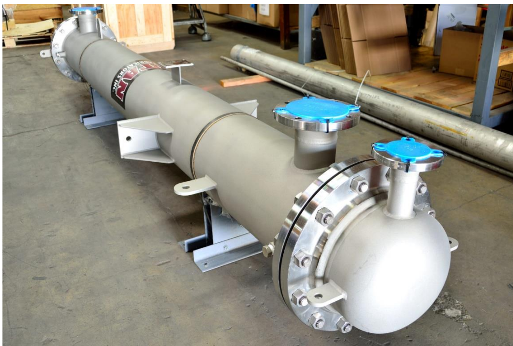
Slika 2. Izmjenjivač topline od čelika oznake X2CrNiMoN22-5-3 [5]
