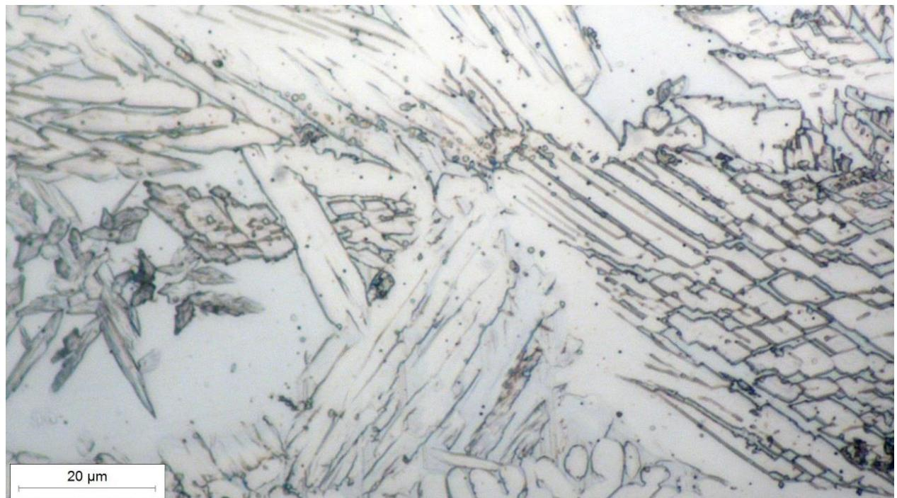
Slika 32. Mikrostruktura toplinski neobrađenog uzorka u 1. području
