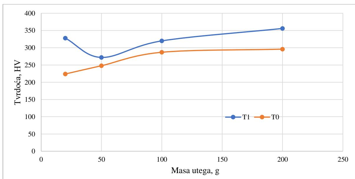
**Slika 62. Utjecaj opterećenja na vrijednosti mikrotvrdoće za toplinski obrađeni i neobrađeni uzorak**
