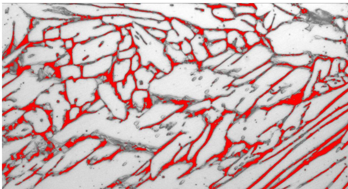
Slika 45. Sigma-faza u mikrostrukturi toplinski obrađenog uzorka
