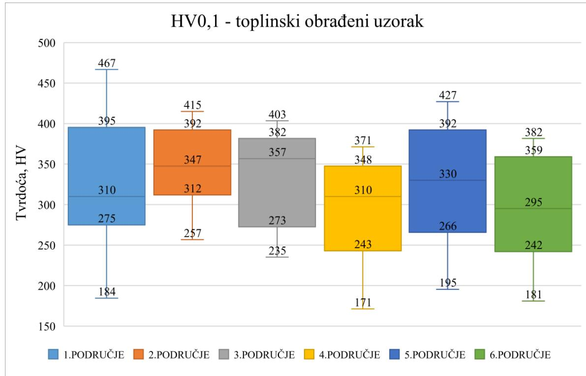
**Slika 57.** Rasipanja izmjereneh vrijednosti mikrotvrdoće HV0,1 za toplinski obrađeni uzorak
