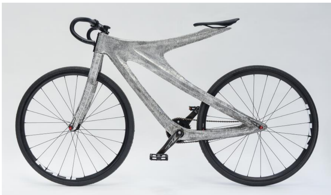
Slika 16. Aluminijski bicikl proizveden WAAM postupkom [15]
