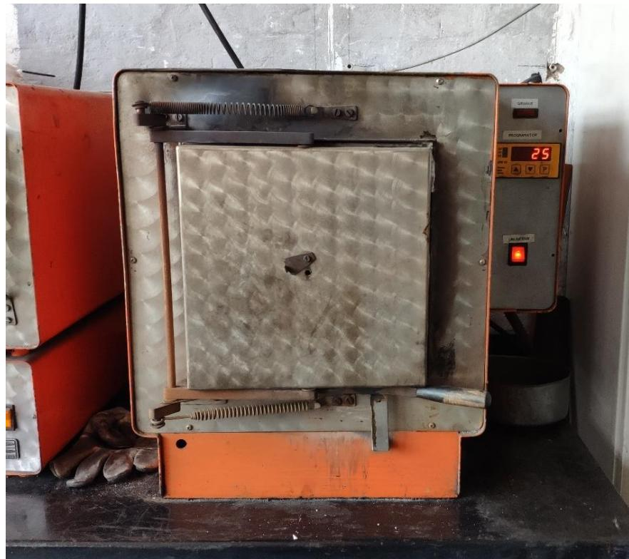
**Slika 26.** Komorna peć za žarenje
