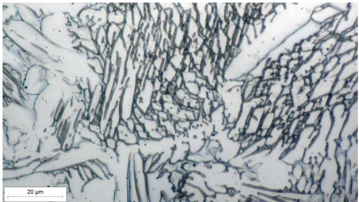
Slika 34. Mikrostruktura toplinski neobrađenog uzorka u 3. području
