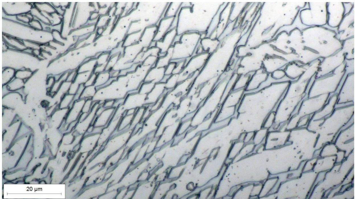
Slika 37. Mikrostruktura toplinski neobrađenog uzorka u 6. području
