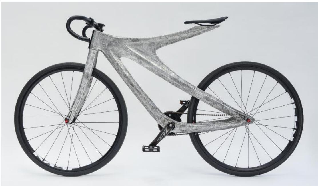
**Slika 16. Aluminijski bicikl proizveden WAAM postupkom [15]**
