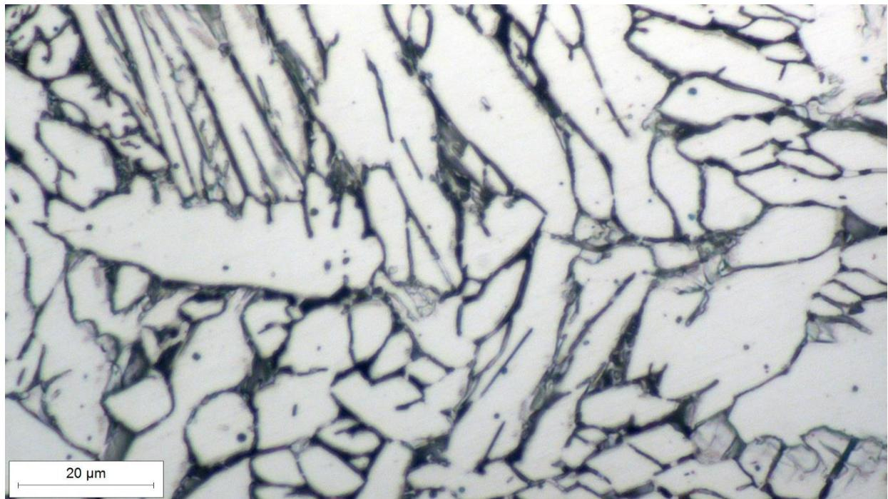
Slika 41. Mikrostruktura toplinski obrađenog uzorka u 4. području
