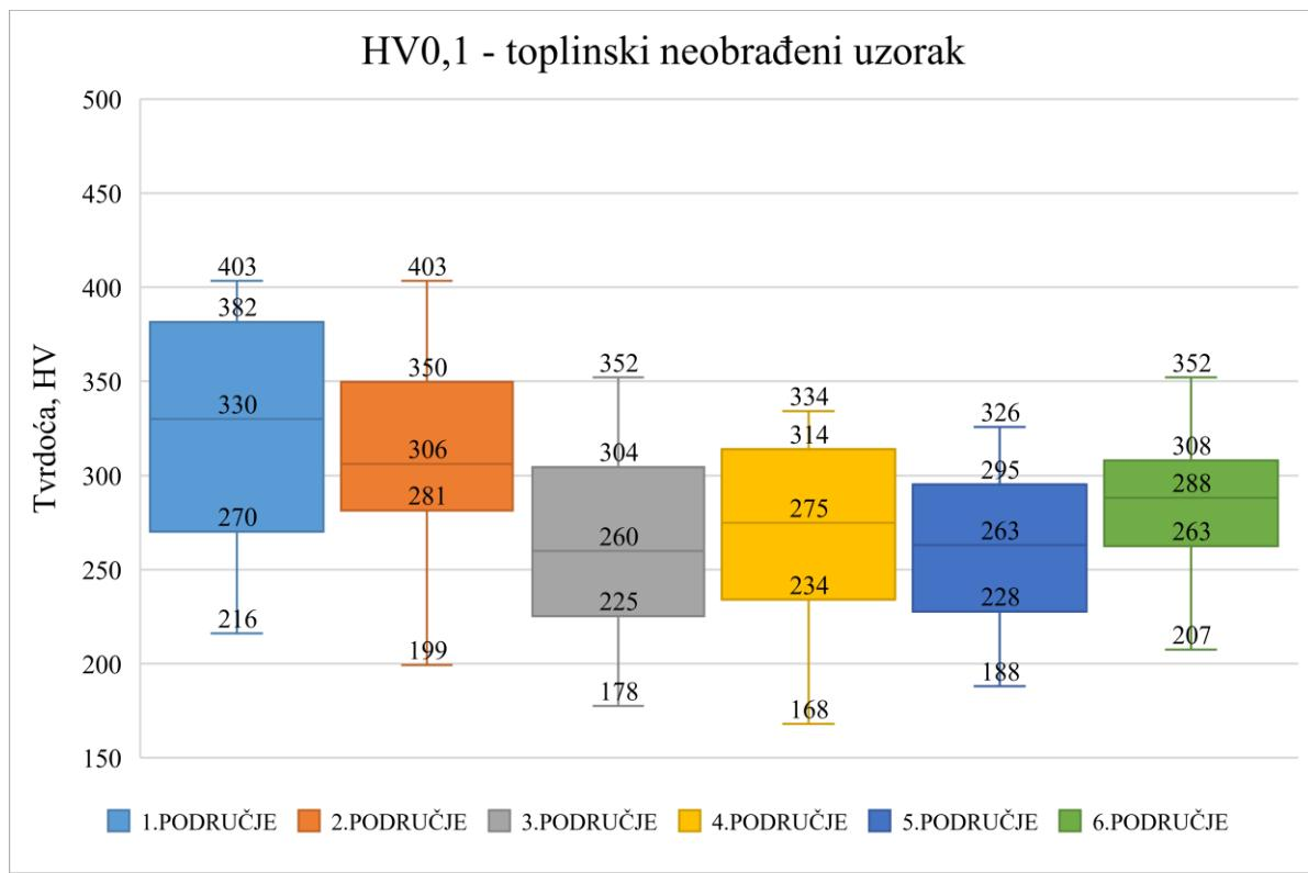
**Slika 56.** Rasipanja izmjereneh vrijednosti mikrotvrdoće HV0,1 za toplinski neobrađeni uzorak
