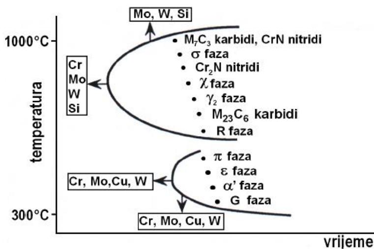
Slika 6. Shematski prikaz tipičnih precipitacija u dupleks strukturi [6]
