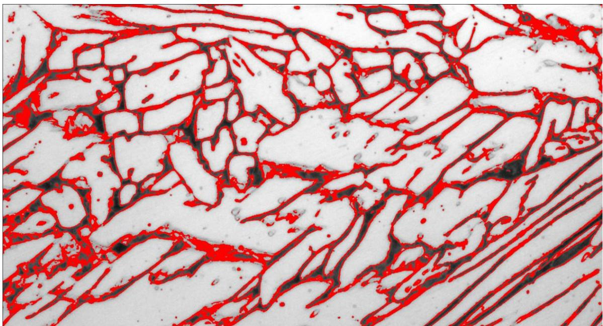
Slika 46. Feritna faza u mikrostrukturi toplinski obrađenog uzorka
