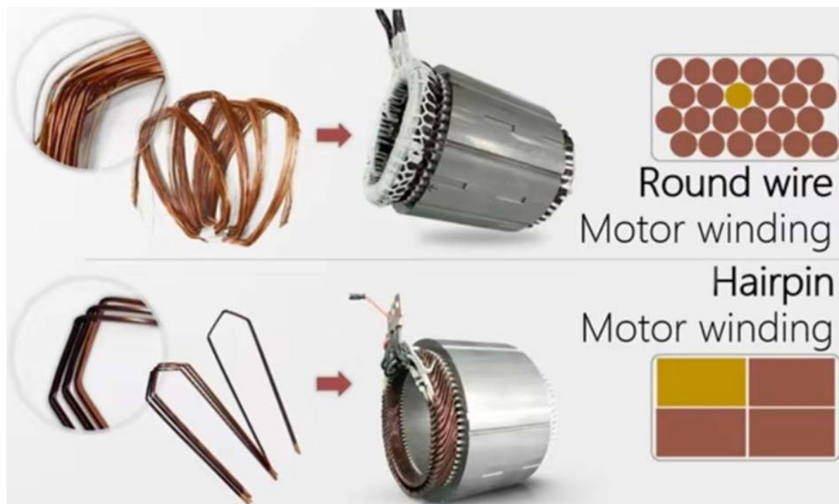
Slika 7. Usporedba okrugle žice i hairpin dizajna [6]
