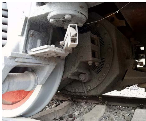
Slika 16. Primjeri motora hlađenih zrakom
