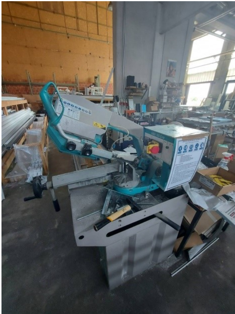
Slika 3. Pila za rezanje čeličnih profila
