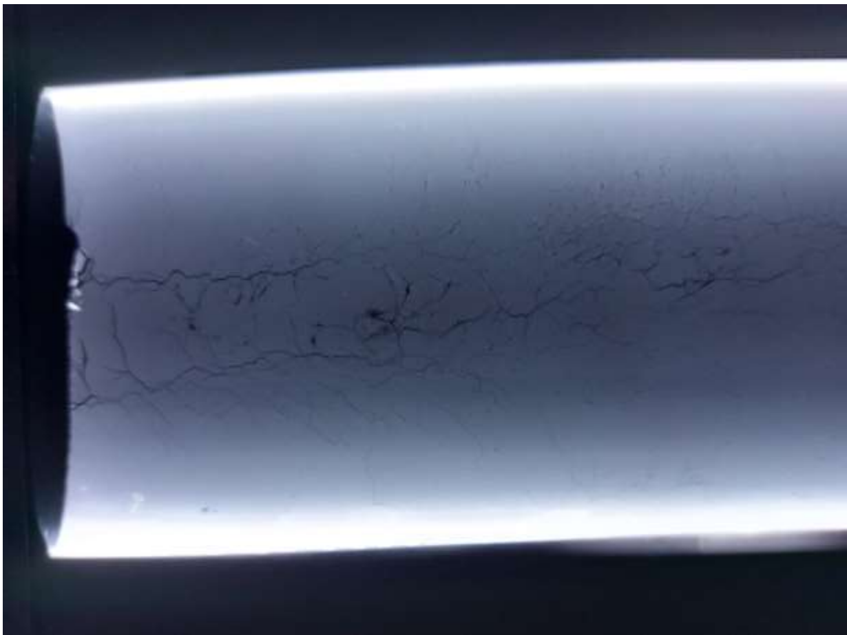
Slika 86. Detaljnija radiografska snimka većeg povećanja B-segmenta cijevi od čelika EN 1.4301 (AISI 304).
