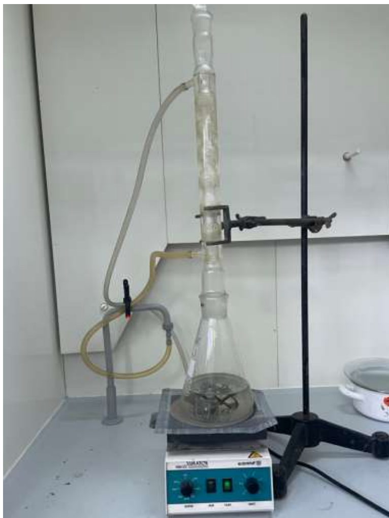
Slika 92. Prikaz kuhanja U-uzoraka u otopini magnezijevog klorida
