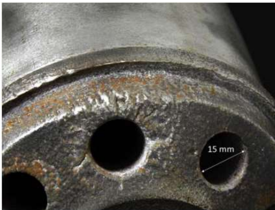
Slika 30. Površinska interkristalna korozija nastala zbog senzibilizacije [18].
