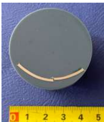
Slika 62. Uzorak za ispitivanje poprečnog presjeka cijevi.
