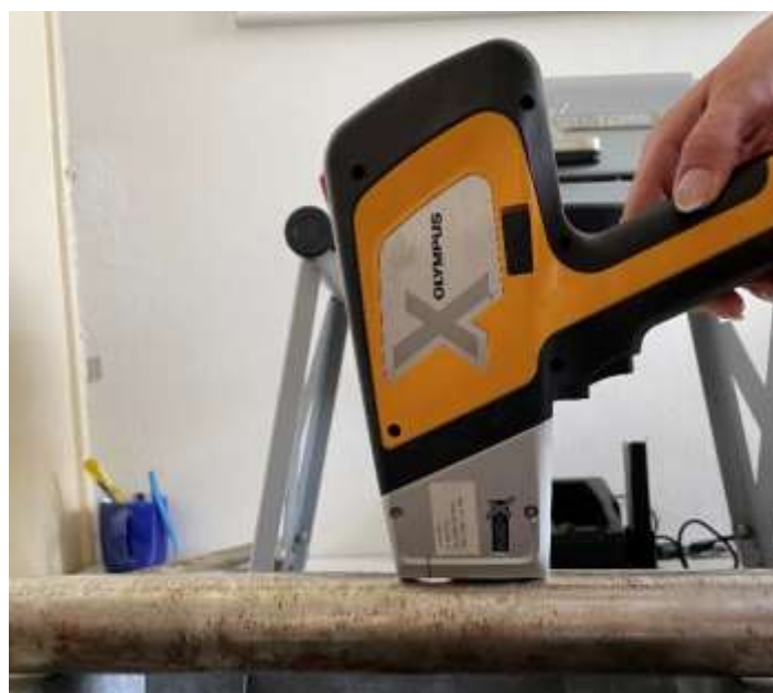
Slika 55. Spektrokemijsko ispitivanje florescentnim X-zrakama.
