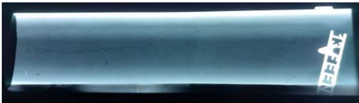
Slika 82. Radiografska snimka cijelog segmenta cijevi od čelika EN 1.4301 (AISI 304).
