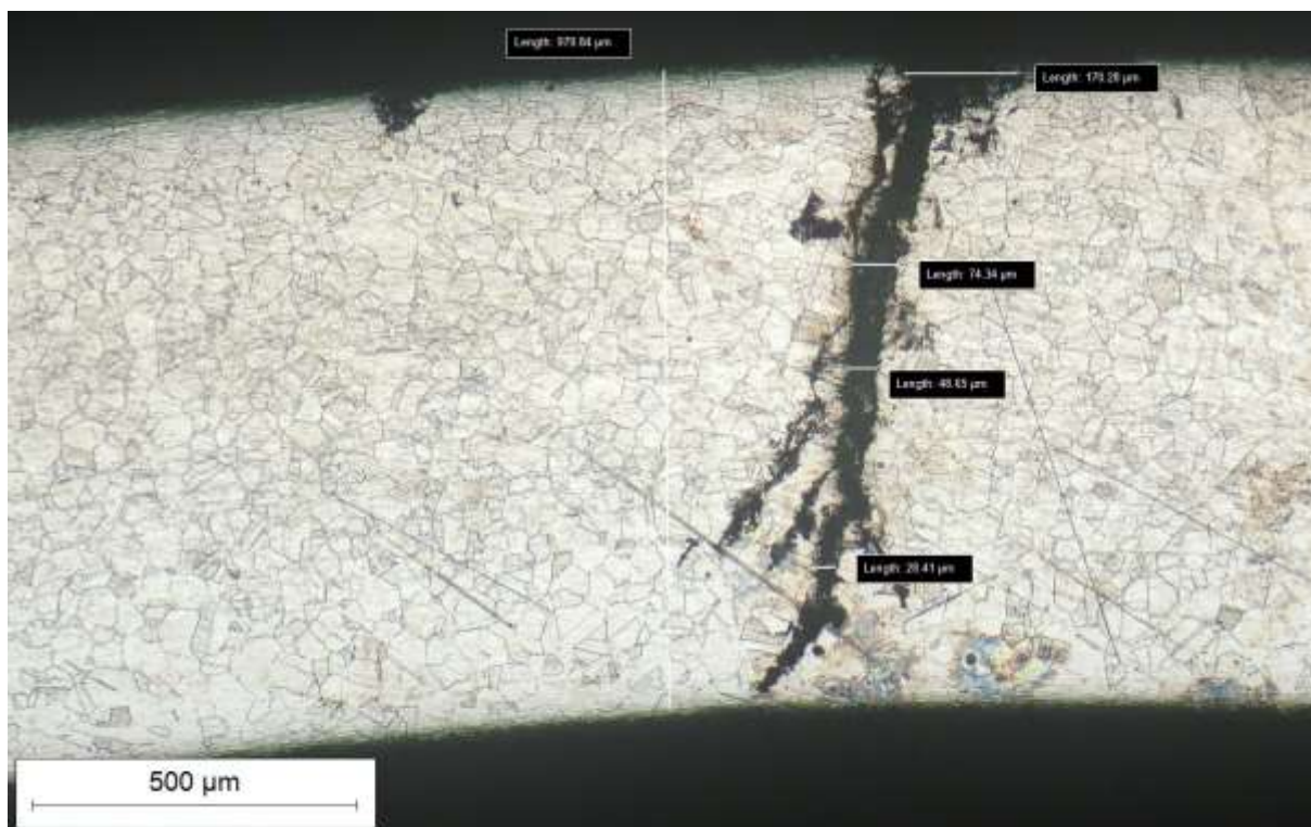
Slika 76. Prikaz dimenzija pukotine u čeliku EN 1.4301 (AISI 304).
