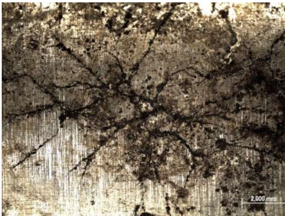
Slika 59. Pukotine na vanjskoj površini cijevi.
