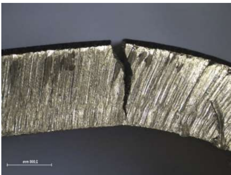
Slika 94. Propagacija pukotine od vanjske prema unutarnjoj površini uzorka od čelika EN 1.4301 (AISI 304).
