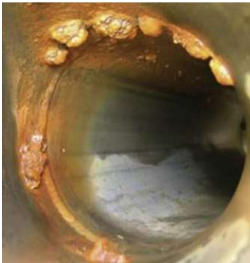
Slika 42. MIC zavora na austenitnom nehrđajućem čeliku u postrojenju za pročišćavanje vode [18].
