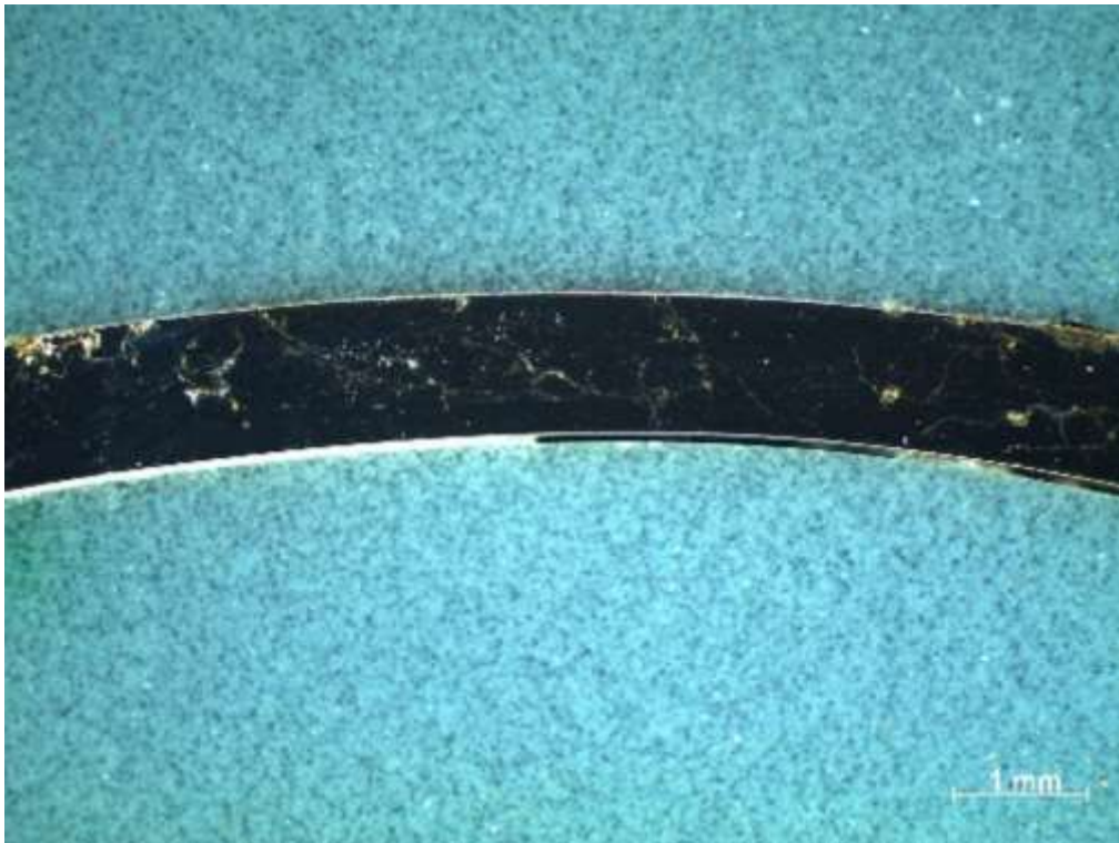
Slika 63. Pukotine na poprečnom presjeku cijevi.
