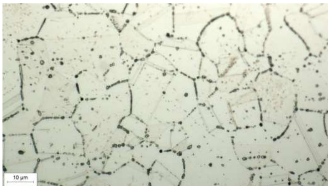
Slika 70. Austenitna mikrostruktura čelika EN 1.4301 (AISI 304).
