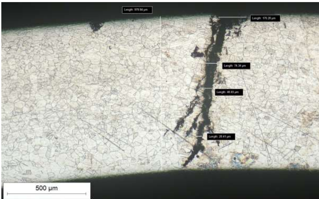
Slika 76. Prikaz dimenzija pukotine u čeliku EN 1.4301 (AISI 304).
