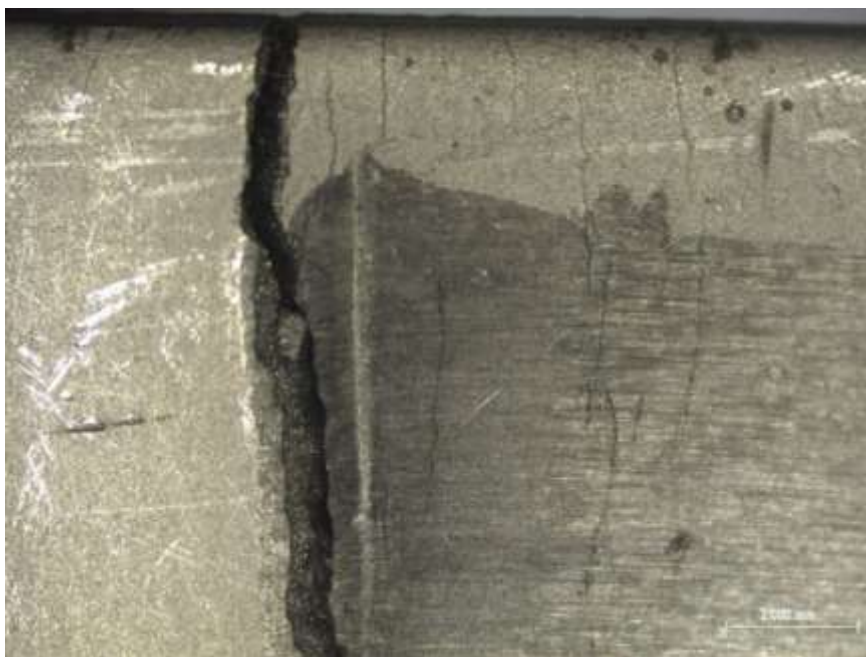
Slika 93. Pukotina na vanjskoj površini luka uzorka od čelika EN 1.4301 (AISI 304).
