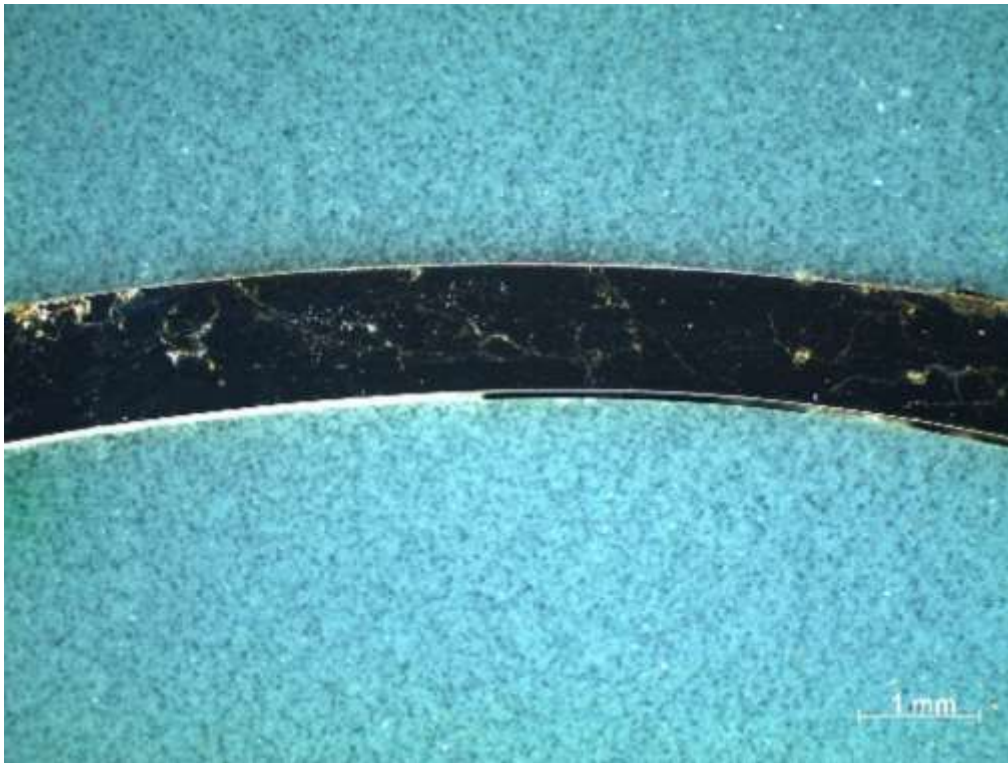
Slika 63. Pukotine na poprečnom presjeku cijevi.
