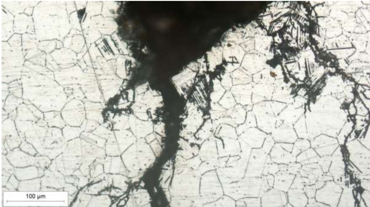
Slika 81. Jamica na vanjskoj površini cijevi koja propagira u otvorenu pukotinu u čeliku EN 1.4301 (AISI 304).
