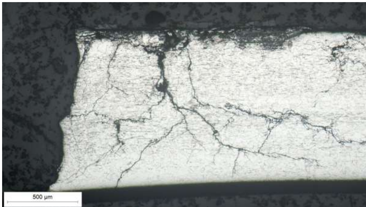
Slika 73. Razgranata pukotina u čeliku EN 1.4301 (AISI 304).
