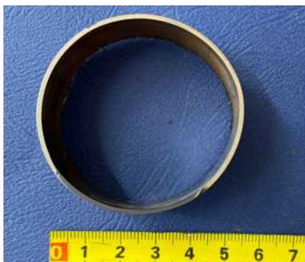
Slika 51. Poprečni presjek segmenta cijevi.
