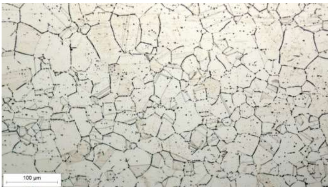
Slika 69. Austenitna mikrostruktura čelika EN 1.4301 (AISI 304).
