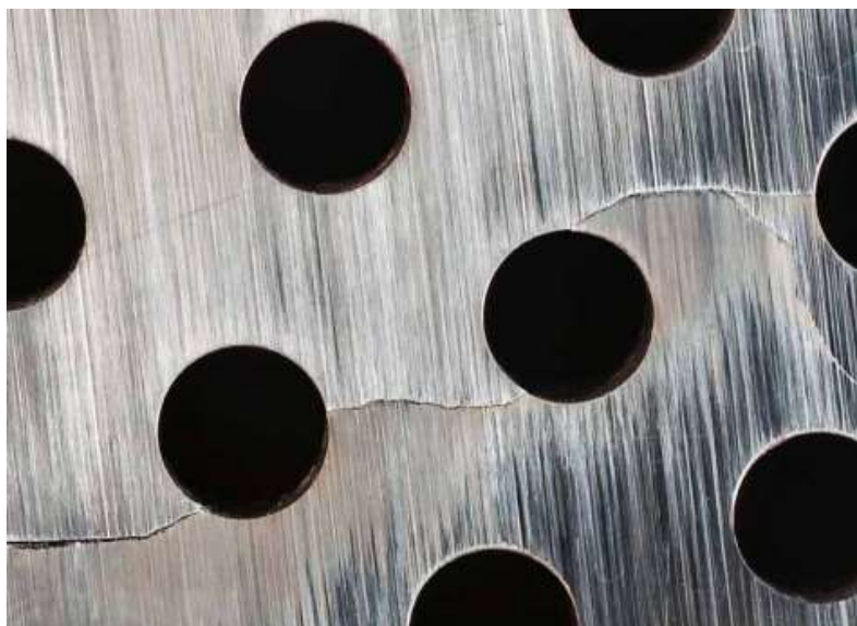
Slika 40. Pukotine nastale uslijed korozijskog zamora na valjku stroja za papir [1].
