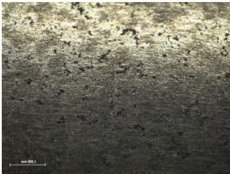
Slika 96. Pojava pittinga na površini čelika EN 1.4016 (AISI 430).
