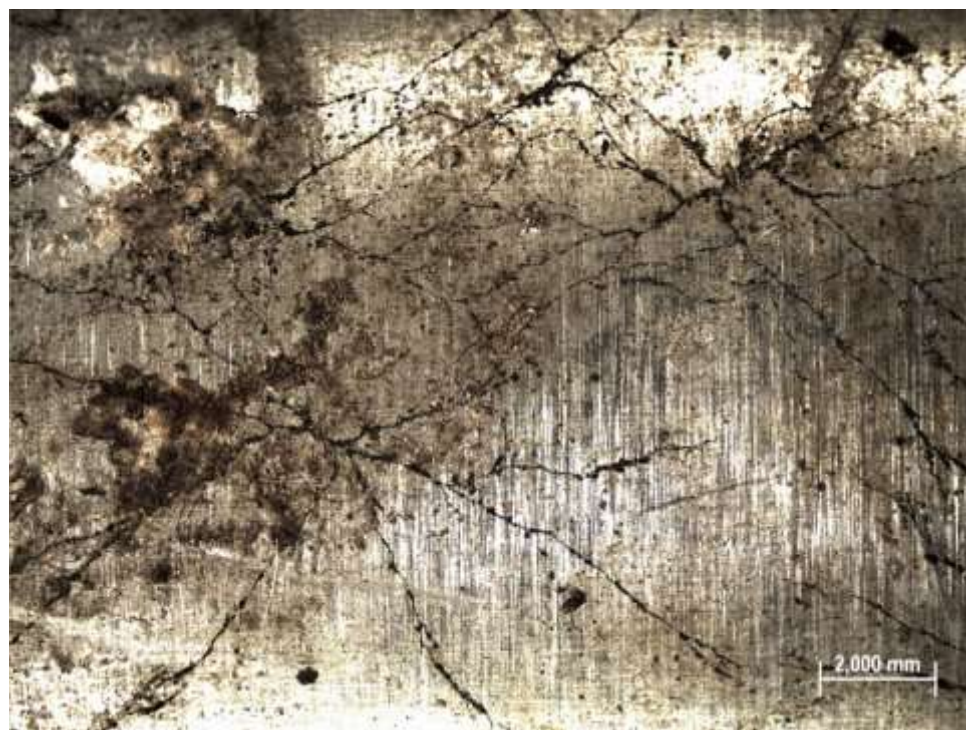
Slika 58. Pukotine na vanjskoj površini cijevi.
