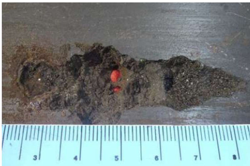
Slika 41. MIC na dijelu linije za transport sirove nafte [18].
