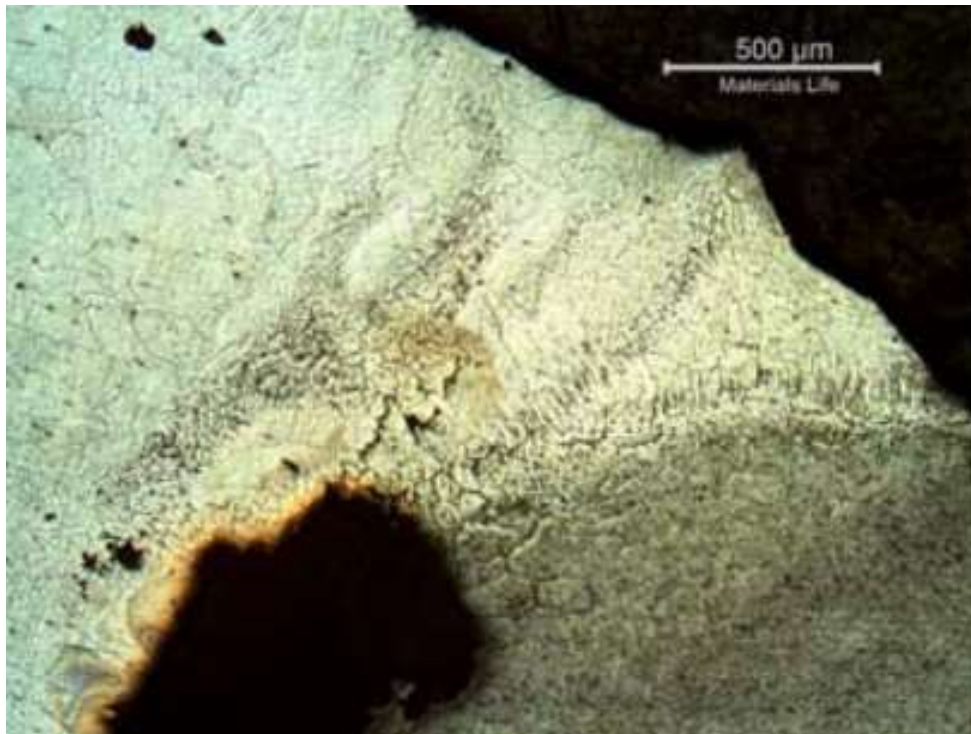
Slika 32. Interkristalna korozija na liniji spajanja zavara [18].
