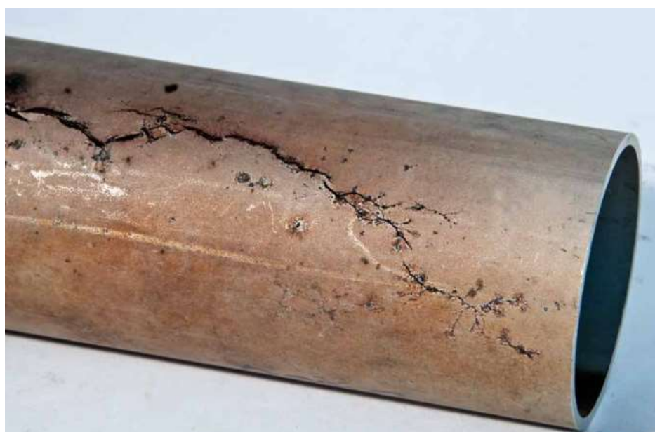
Slika 37. Pucanje cijevi od nehrđajućeg čelika izazvano napetosnom korozijom [1].
