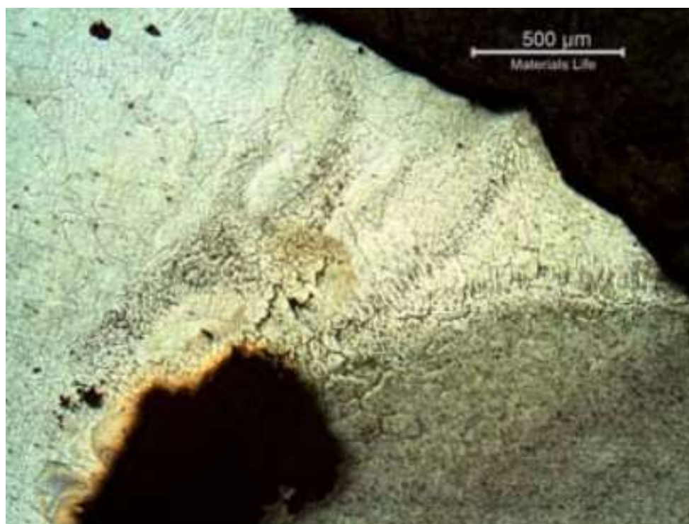
Slika 32. Interkristalna korozija na liniji spajanja zavara [18].
