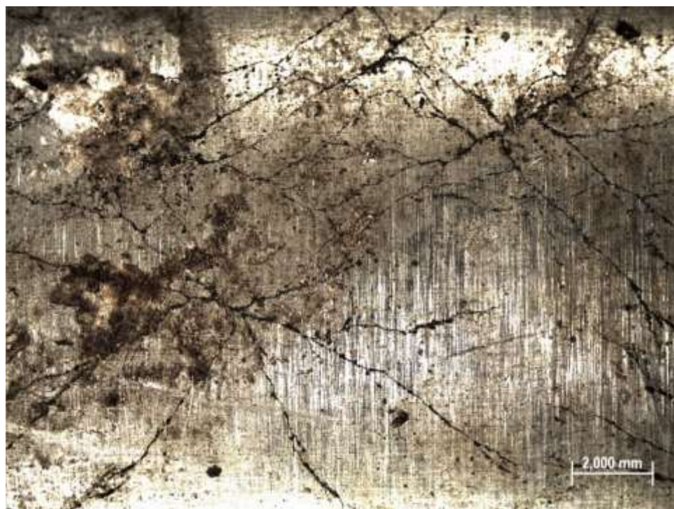
Slika 58. Pukotine na vanjskoj površini cijevi.
