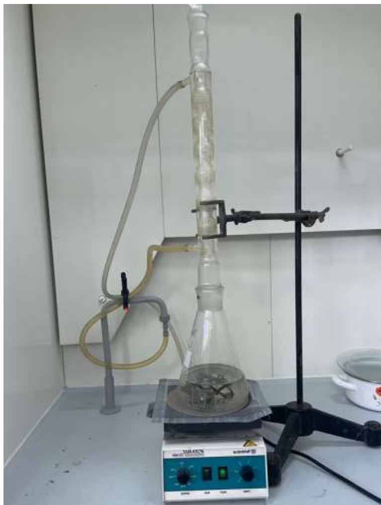
Slika 92. Prikaz kuhanja U-uzoraka u otopini magnezijevog klorida
