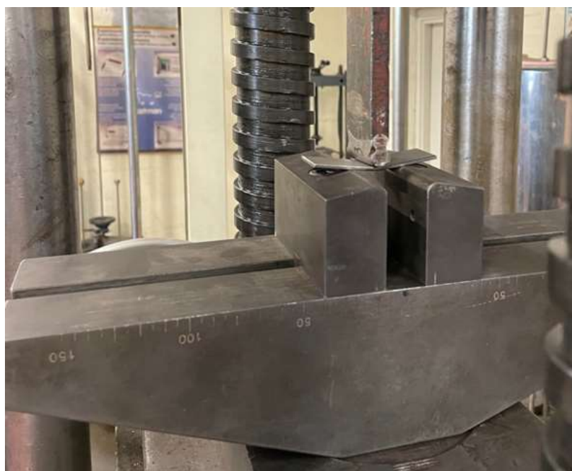
Slika 89. Savijanje uzorka na savijačici s trnom.
