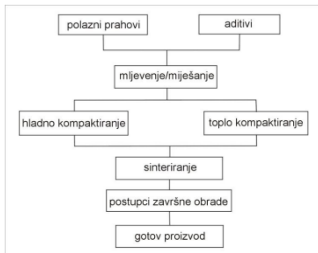
Slika 1.2 Prikaz tehnološke operacije u konvencionalnom postupku [2]
