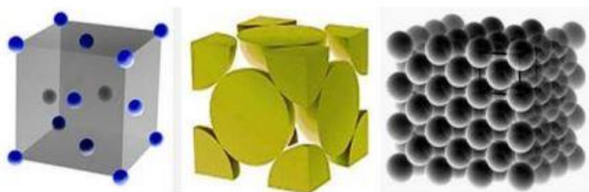
Slika 5. Prostorno plošna kristalna rešetka – FCC [3]
