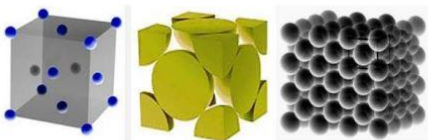
Slika 5. Prostorno plošna kristalna rešetka – FCC [3]
