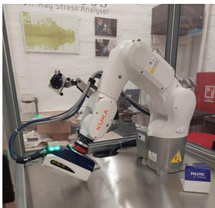
Slika 42. Uređaj za mjerenje zaostalih naprezanja
