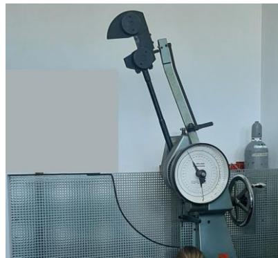
**Slika 30. Ispitivanje udarnog rada loma**
