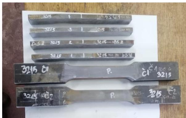
Slika 27. Epruvete dobivene rezanjem vodenim mlazom
