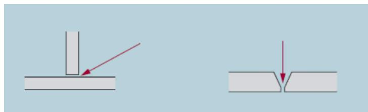
**Slika 7. Zadovoljavajuće udaljenosti materijala koji se zavaruju [16]**
