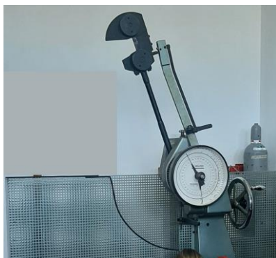
Slika 30. Ispitivanje udarnog rada loma
