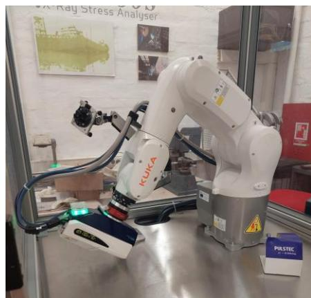
**Slika 42. Uredaj za mjerjenje zaostalih naprezanja**
