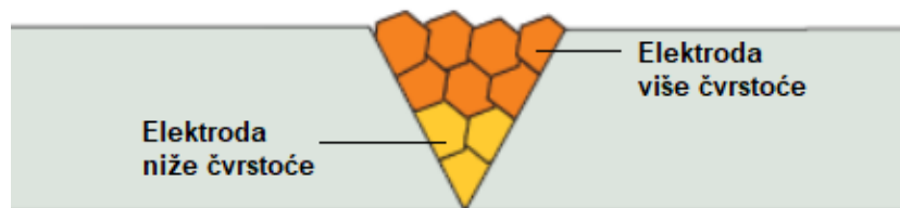
Slika 18. Upotreba dodatnog materijala za smanjenje pukotina [11]
