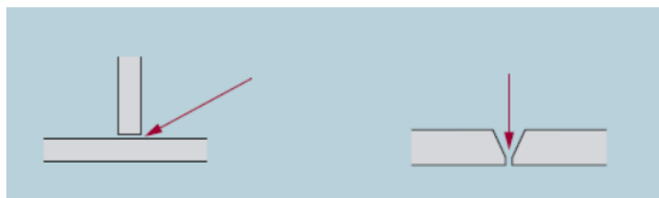
Slika 7. Zadovoljavajuće udaljenosti materijala koji se zavaruju [16]
