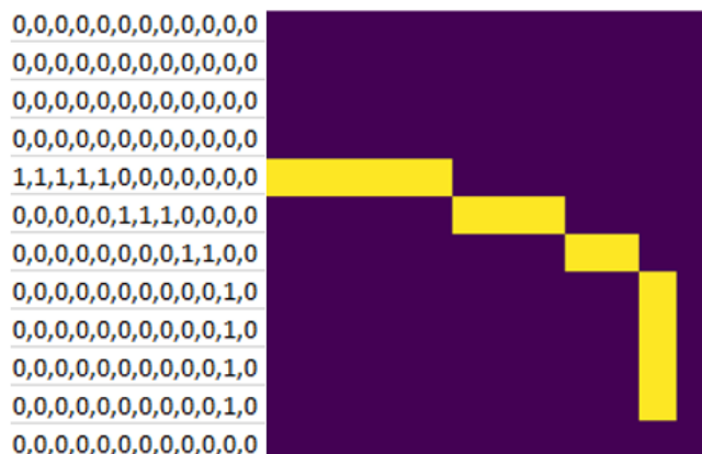
Slika 27. Trajektorija klase 1 prikazana u csv formatu (lijevo) i prikazana kao slika (desno)
