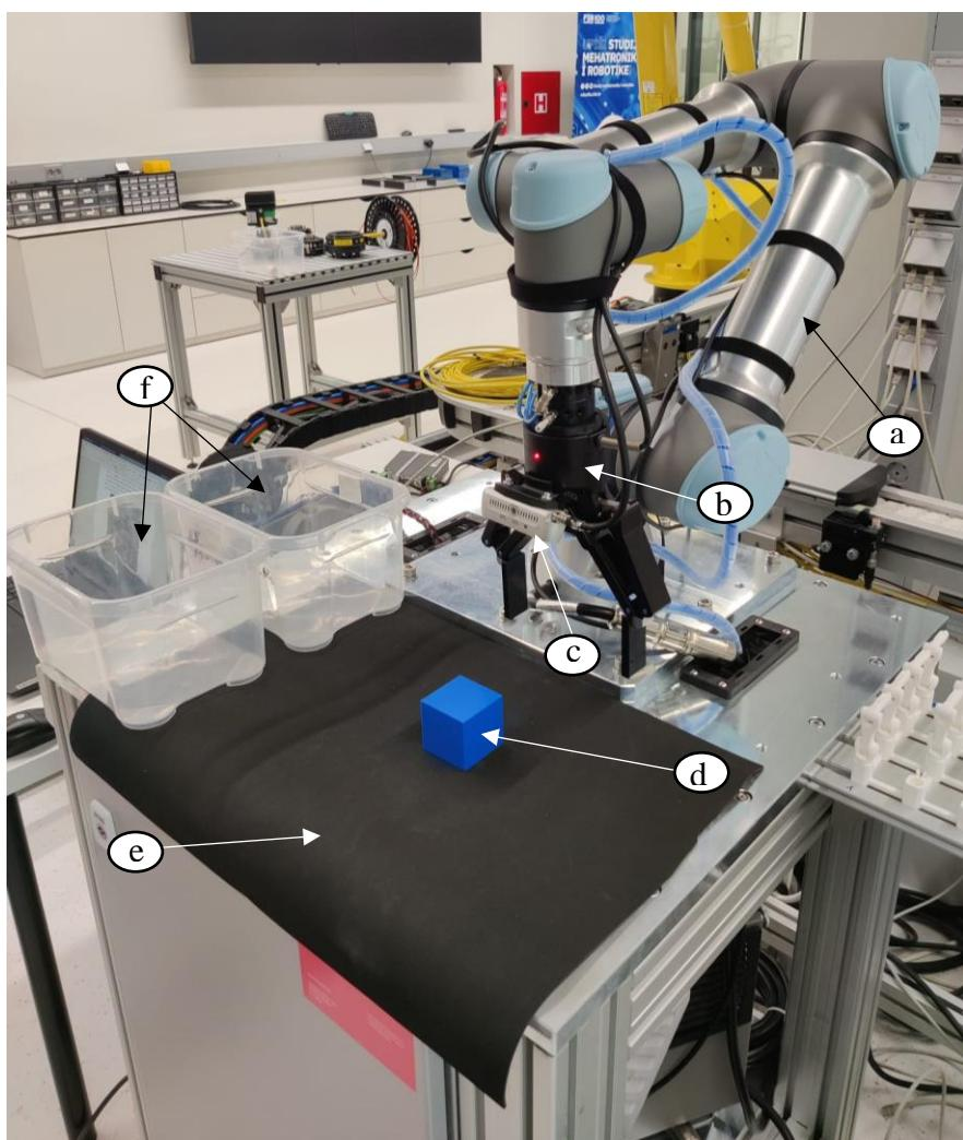
Slika 9. Robotska stanica : a) UR5e, b) Robotiq 2f-85 hvataljka, c) RealSense D435 kamera,
