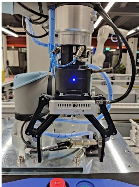
Slika 41. Hvataljka uspješno spojena s računalom
